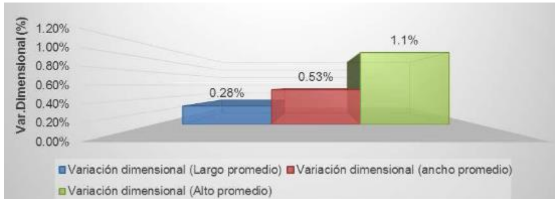
Figura 25. Gráfico de resultado de variación dimensional del ladrillo ecológico con 40 % Tierras de diatomeas (NTP. 399.613/ 339.604)
