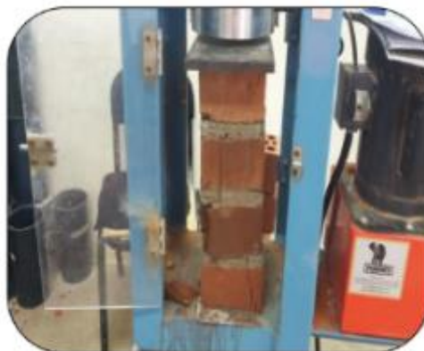
Figura 13. Colocación de pila de albañilería en la máquina a compresión
