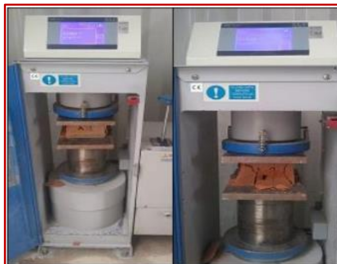
Figura 49. Ensayo de compresión de unidades de albañilería.
