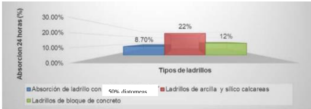
Figura 37. Grafico del ensayo de absorción al ladrillo con 50% de tierras de diatomeas
