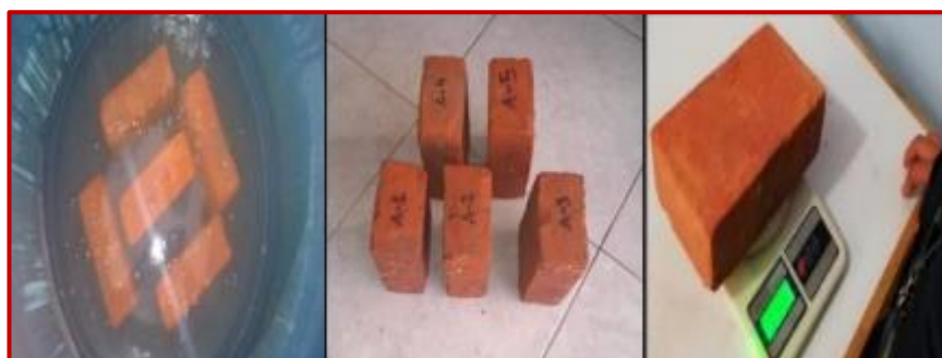
Figura 46. Ensayo de absorción de unidades de albañilería.
