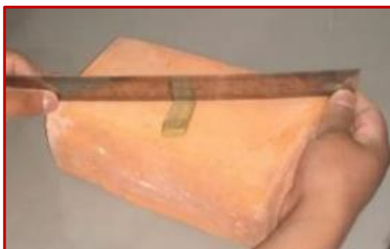
Figura 45. Ensayo de alabeo en unidades de albañilería.
