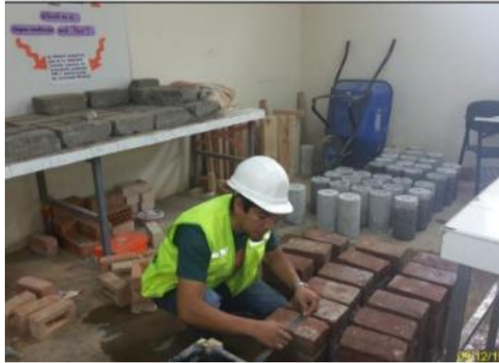
Figura 12. Medida de las dimensiones de cada una de las pilas
