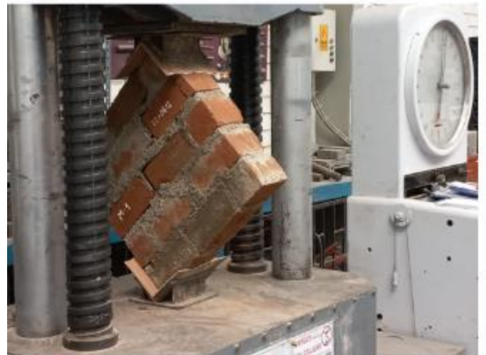
Figura 14. Visualización de la deformación de la pila y murete de albañilería
