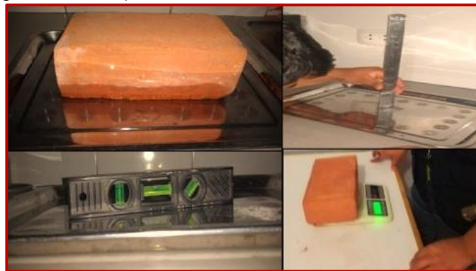
Figura 47. Ensayo de succión de unidades de albañilería.
