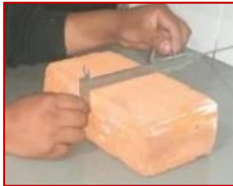
Figura 44. Ensayo de variación dimensional.
