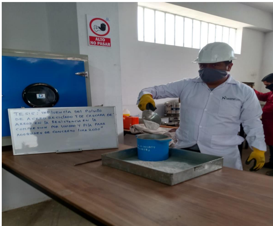
Figura 39: llenado de polvo el recipiente y su peso para su calculo respectivo Fuente: Elaboración propia.
