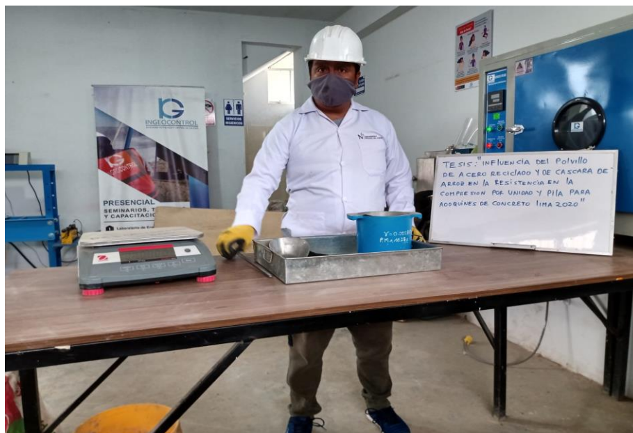
Figura 37: llenado del recipiente (mezcla) para luego pesarla. Fuente: Elaboración propia.
