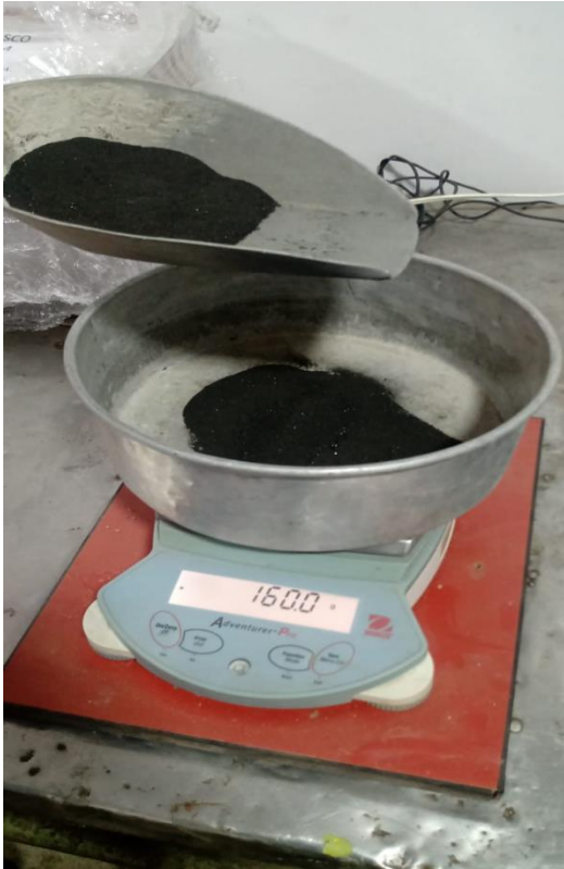
Figura 46: Peso exacto del polvillo de acero para la mezcla Fuente: Elaboración propia.
