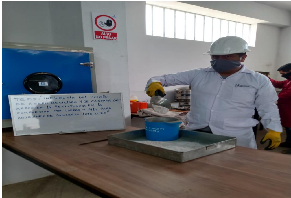
Figura 12: Colocación del polvillo en la probeta Fuente: Elaboración propia
