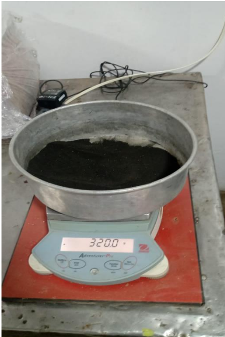
Figura 43: Peso del polvillo de acero al 5% de influencia Fuente: Elaboración propia.
