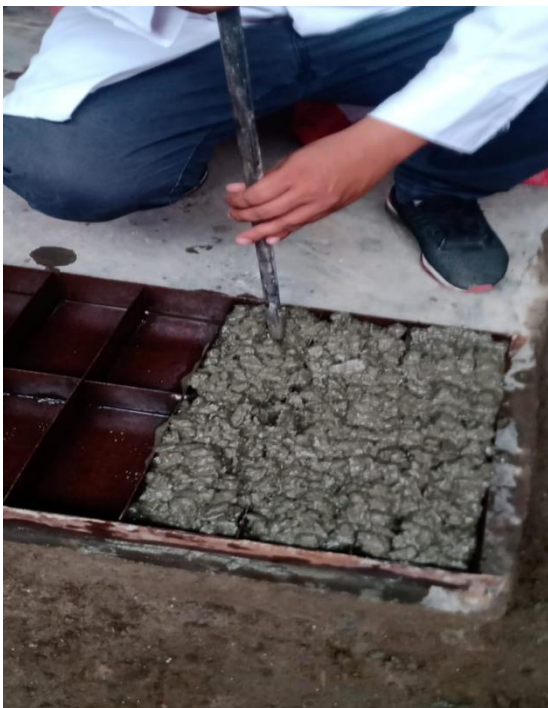
Figura 47: Vaciado la mezcla en el molde para los adoquines de concreto Fuente: Elaboración propia.
