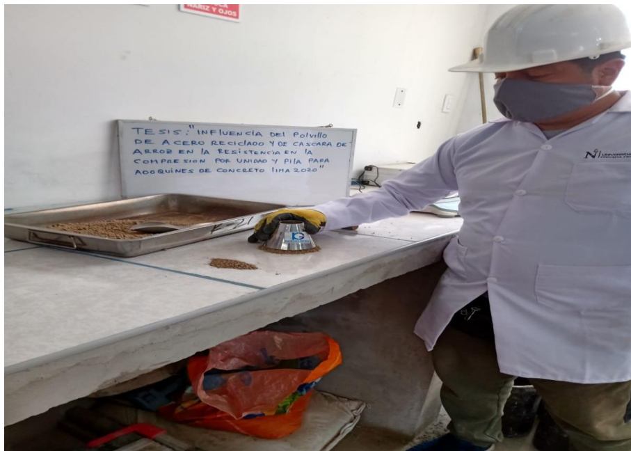
Figura 11: Medida en peso de agua para la humedad de cada muestra a ensayar. Fuente: Elaboración propia
