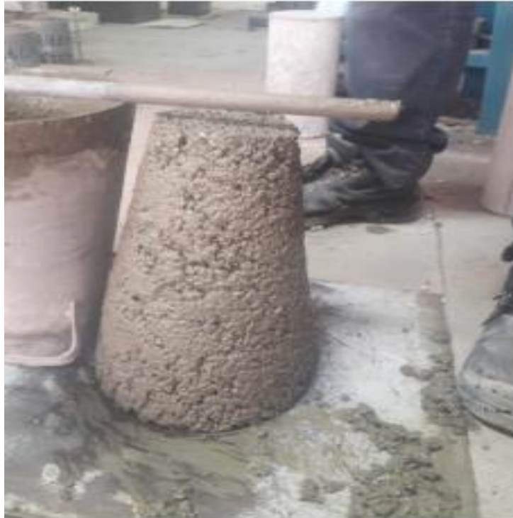
Figura 40: Ensayo del cono de Abrams Fuente: Elaboración propia.
