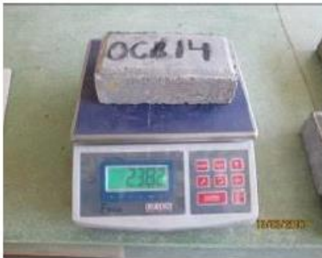
Figura 31: Pesado de adoquines Fuente: Elaboración Propia
