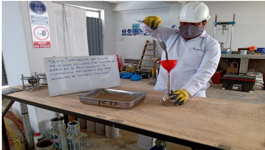
Figura 8: Pesado del polvillo de acero reciclados Fuente: Elaboración propia
