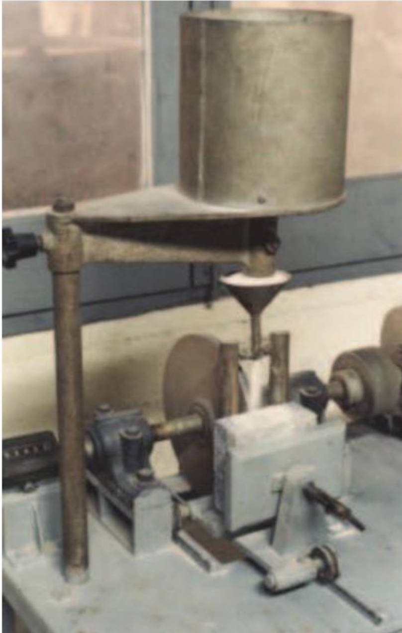
Figura 22: Ensayo de desgaste según NTG 41087. Fuente. Norma COGUANOR NTG 41087, 2012.
