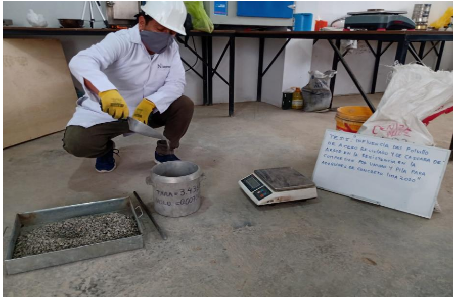
Figura 36: Peso de agregado grueso (piedra chancada) para preparación de mezcla Fuente: Elaboración propia.
