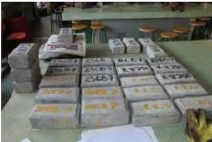
Figura 29: Enfriamiento de adoquines al aire libre
