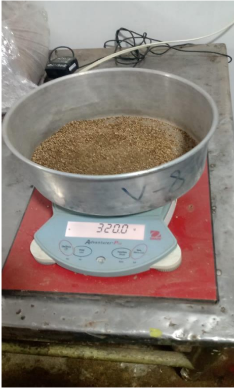
Figura 42: Peso de la casca de arroz al 5% de influencia Fuente: Elaboración propia.
