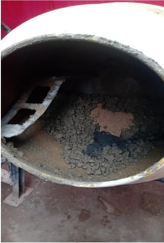
Figura 44: Muestra del polvillo de acero y cascara de arroz en la mezcla Fuente: Elaboración propia.
