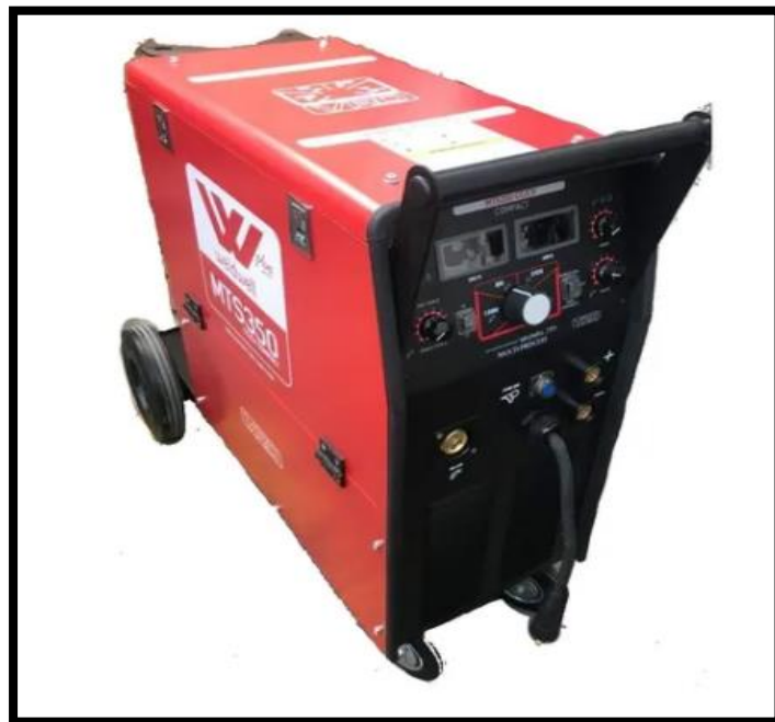
Figura 16 Modelo de Soldadora MIG/arco Industrial 350 amp
