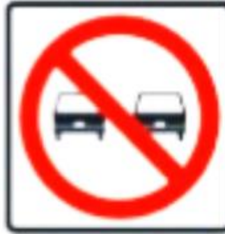
Figura 11: Señal “PROHIBIDO CAMBIAR DE CARRIL” Fuente: (MTC,2016)
