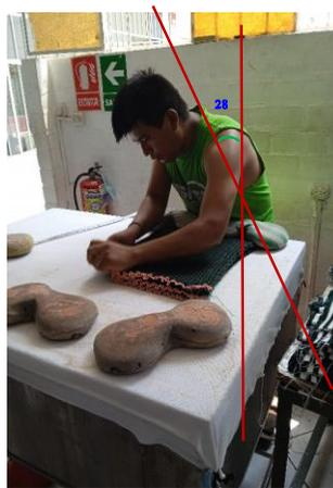
**Observaciones:** Se ve al trabajador con un grado de inclinación de la espalda de 28°, y presenta un giro en el brazo lateral derecho para el uso de la herramienta de planchado.
