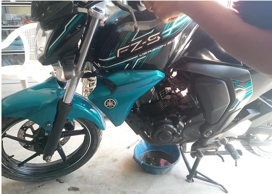
Figura 4 Mantenimiento preventivo de moto Yamaha FZ 2.0. Cambio de lubricantes y afinamiento de motor.
