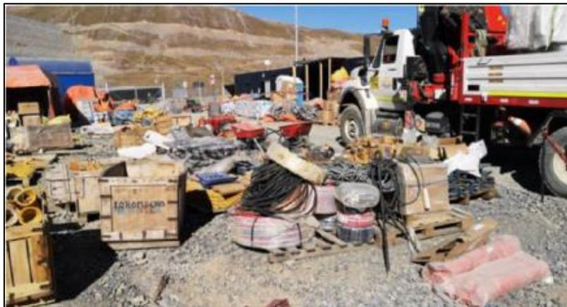
*Figura 30. GETS, pernos, tuercas de línea amarilla expuestos a la intemperie, deteriorados.*
