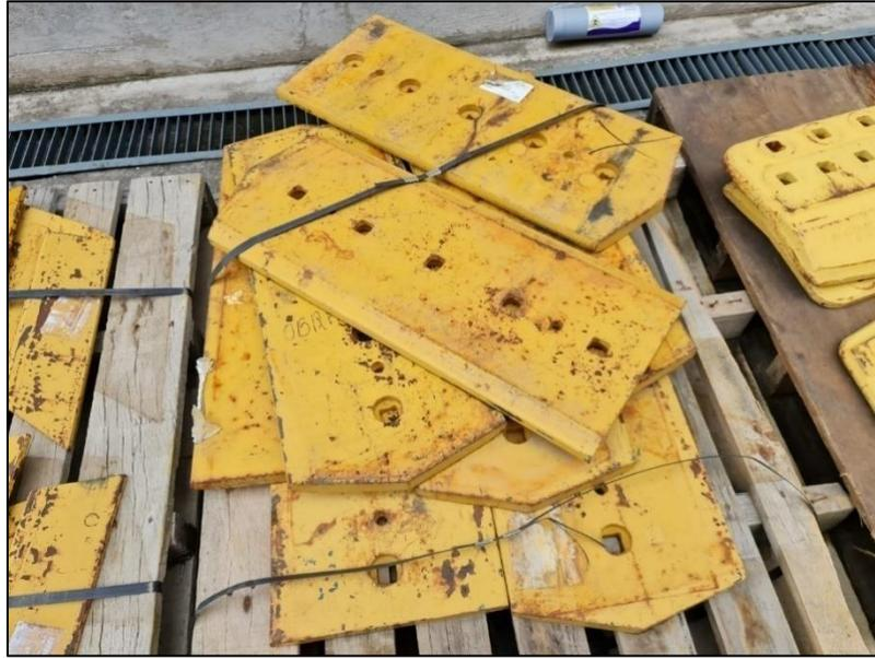
*Figura 29. GETS con presencia de oxido y abolladuras.*
