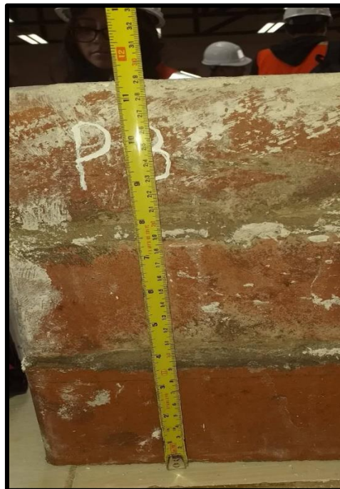
Figura 47: Toma de Medidas en las Pilas de Albañileria
