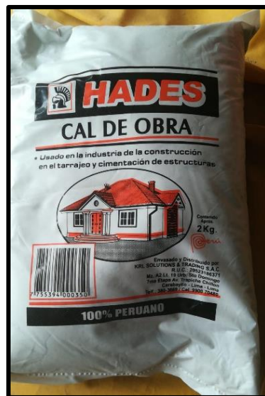
Figura 14: Cal de Obra que se utilizara en las dosificaciones + mortero
