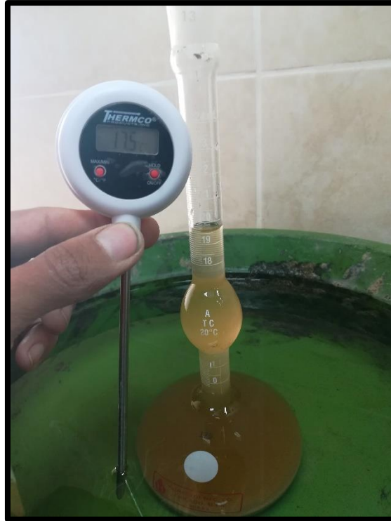
Figura 40: Medida con el termómetro agua – gasolina + cemento en el frasco Chateleir
