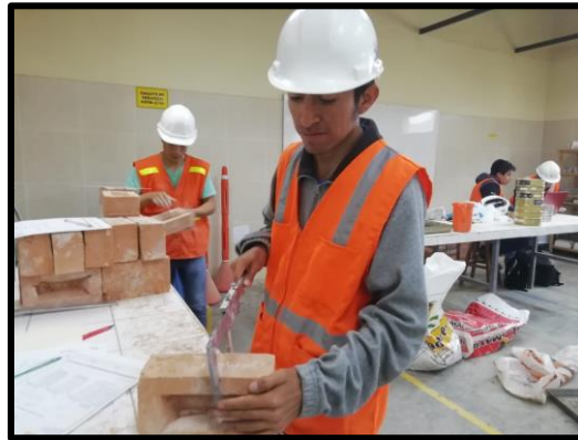
Figura 3: Medición con el Vernier en los ladrillos
