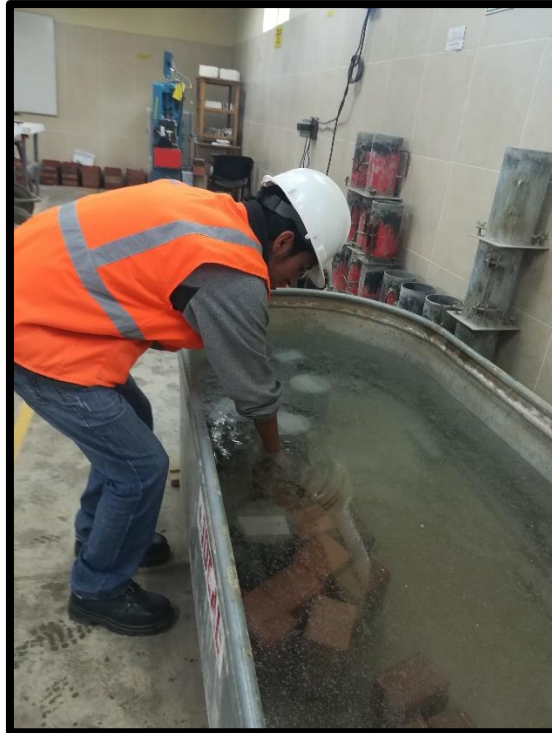
Figura 34: Posterior a las 24h recojo de la unidad de albañilería
