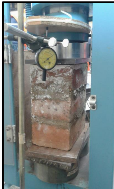
Figura 49: Ensayo de Resistencia a la Compresión de Pilas de Ladrillo Artesanal
