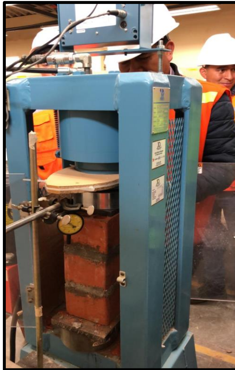
Figura 48: Ensayo de Resistencia a la Compresión de Pilas de Ladrillo Industrial
