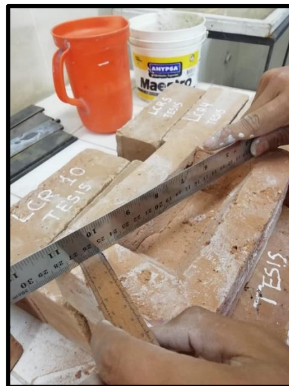
Figura 6: Con la ayuda de la cuña se realiza la verificación de convexidad y concavidad
