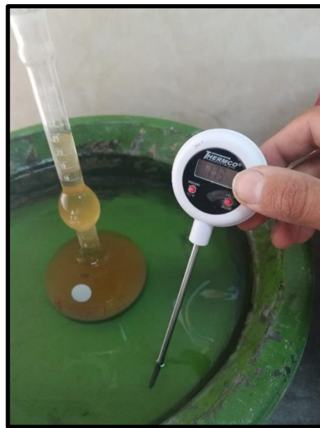
Figura 13: Medición con el termómetro del agua y con la gasolina + cemento
