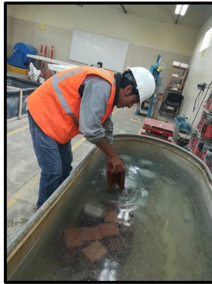
Figura 7: Colocación de los ladrillos en la bandeja de absorción y curado
