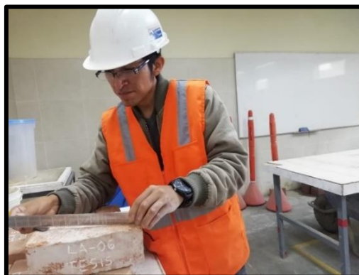
Figura 5: Alabeo de los ladrillos
