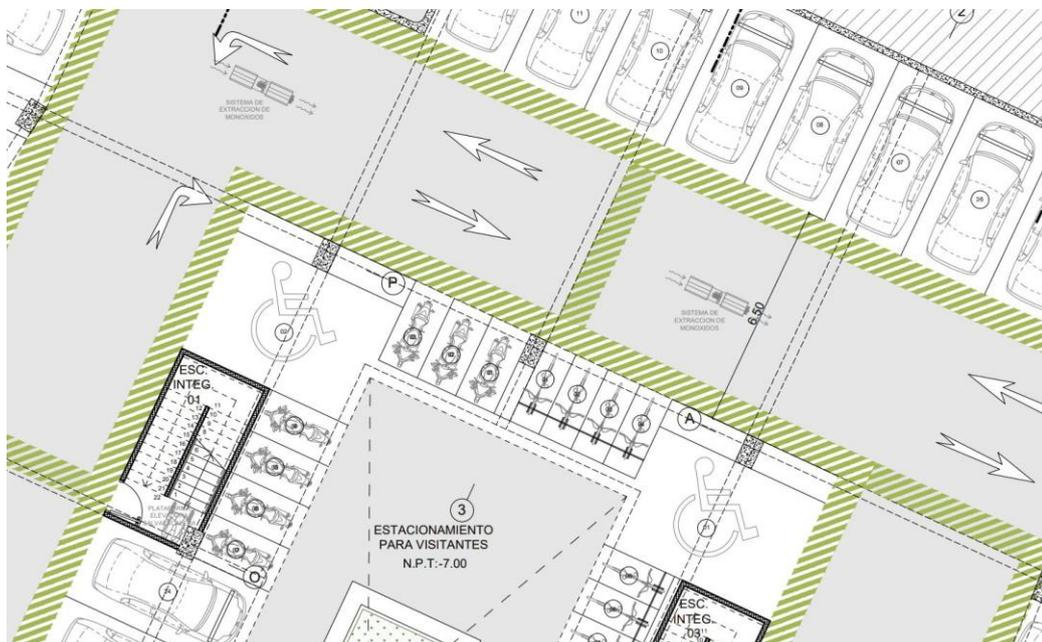
Con respecto a las dimensiones mínimas, la normativa nos exige un ancho mínimo de 3.70 m. En proyecto planteamos estacionamientos para discapacitados con un ancho mínimo de 3.70 m y un máximo de 4.00 m.
