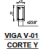
VIGA V-01 (0.15x0.30m.) ESC. 1:25
