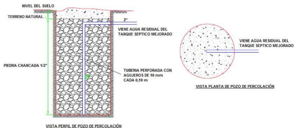
Figura 8. Detalle de pozo de absorción
