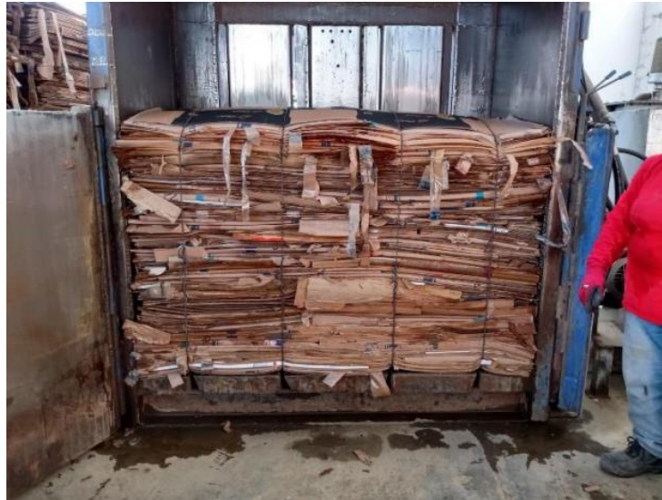
Figura 58. Compactado de cartón (Paca) limpio o de primera
