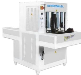
Figura 47: Horno planchador
