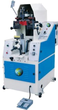
Figura 46: Armadora de talón
