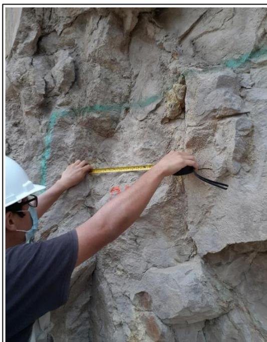
Figura 38. Midiendo la separación de las discontinuidades, estación geomecánica 03.
