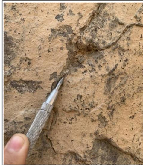
*Figura 33. Analizando el relleno, estación geomecánica 02. Fuente: Propia (2022).*
