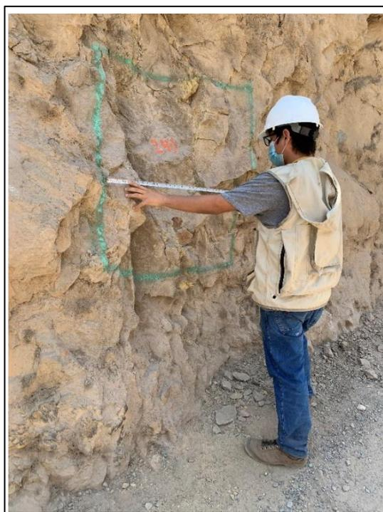
Figura 37. Conteo de las fracturas, estación geomecánica 03. Fuente: Propia (2022).
