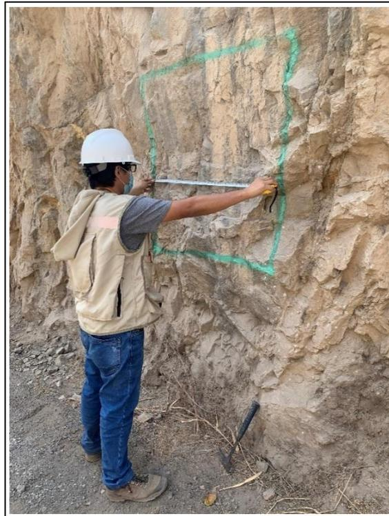
Figura 28. Conteo de las fracturas, estación geomecánica 02. Fuente: Propia (2022).
