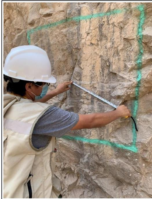
Figura 29. Midiendo la separación de las discontinuidades, estación geomecánica 02.
