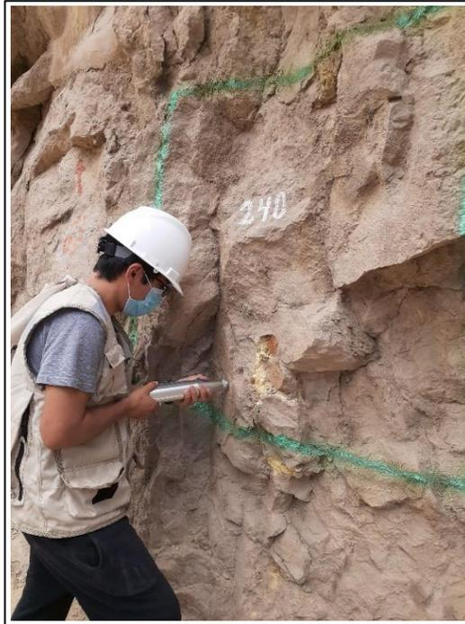
Figura 36. Tomando la Resistencia con Martillo de Schmidt, estación geomecánica 03.
