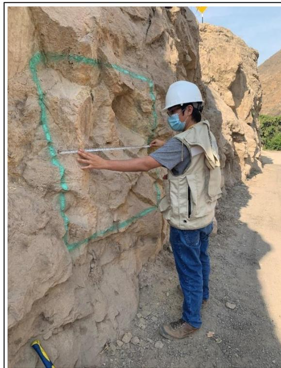
*Figura 19. Conteo de las fracturas, estación geomecánica 01. Fuente: Propia (2022).*
