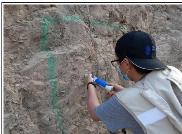
*Figura 27. Tomando la Resistencia con Martillo de Schmidt, estación geomecánica 02.*
