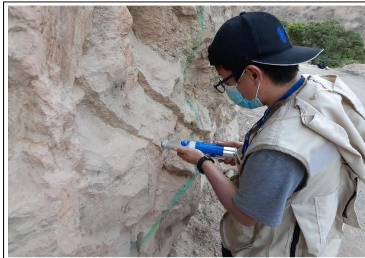
Figura 18. Toma de Resistencia con Martillo de Schmidt, estación geomecánica 01. Fuente: Propia (2022).
