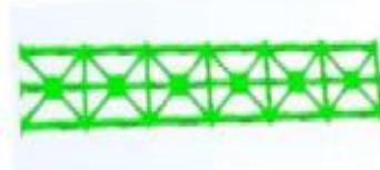
Figura 03: Armado de columnas ligeras en piso.
