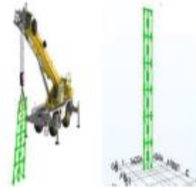
Figura 04: Izaje de columnas ligeras amarradas en piso
