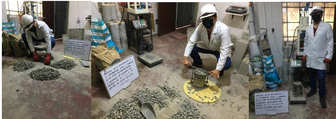
Figura 21: Agregado grueso en el molde cilíndrico y se enrasa la superficie con una varilla metálica o regla.
