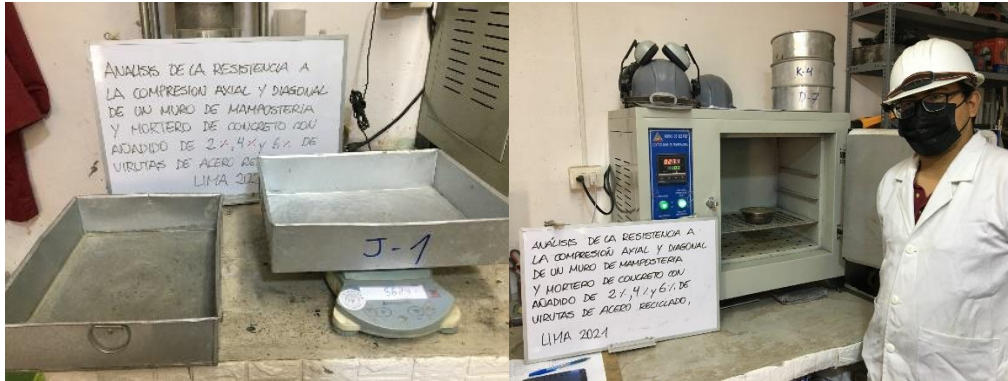
Figura 39: Materiales para ensayos de características físicas de los agregados: bandejas de metal, balanza de precisión y horno.
