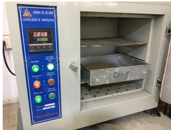
Figura 19: Agregado fino (peso de muestra seca), a 110 °C durante aproximadamente 24 horas.
