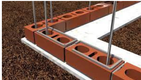
Figura 2: Mampostería reforzada. Fuente: Ingecivil.com
