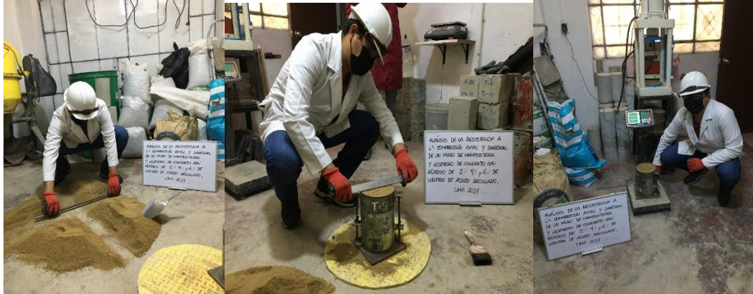
Figura 22: Agregado fino en el molde cilíndrico y se enrasa la superficie con una varilla metálica o regleta.
