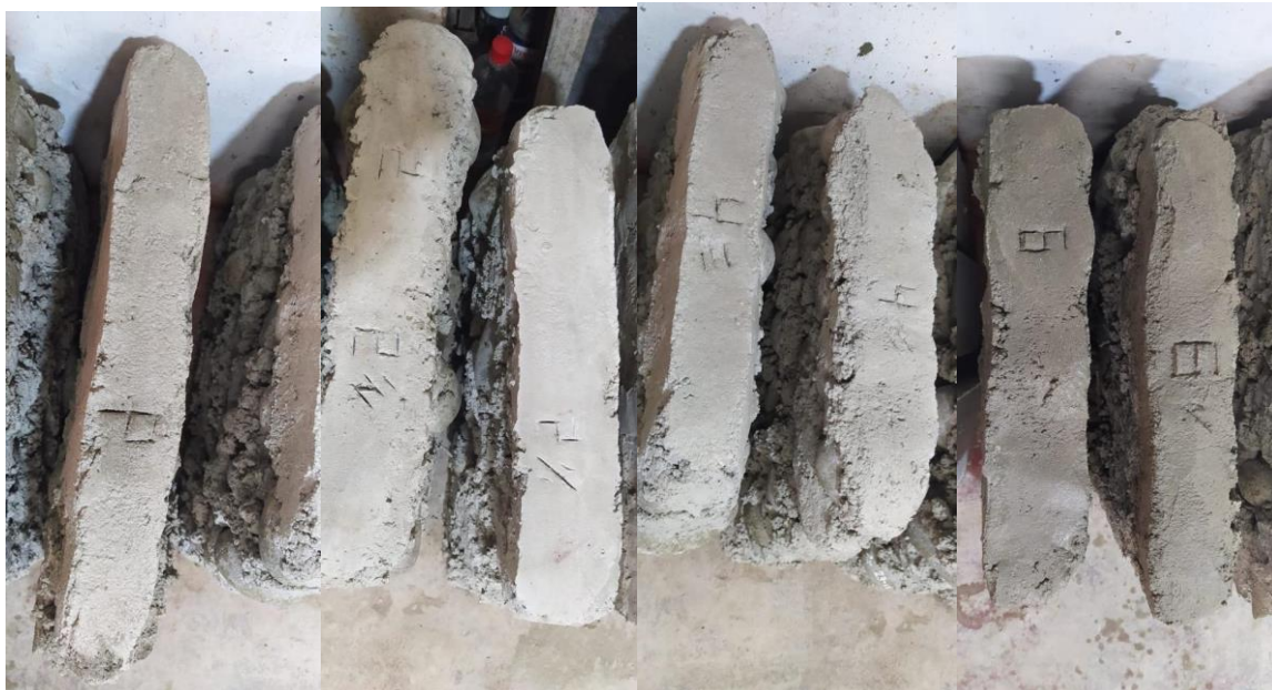
Figura 44: Rotulación de Muretes: Patrón, 2%, 4% y 6%.
