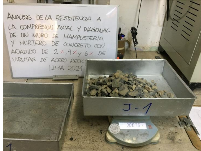
Figura 18: Procedimiento de pesado de muestra de agregado grueso (piedra chancada), en condición natural CONTENIDO DE HUMEDAD PARA LOS AGREGADOS.
