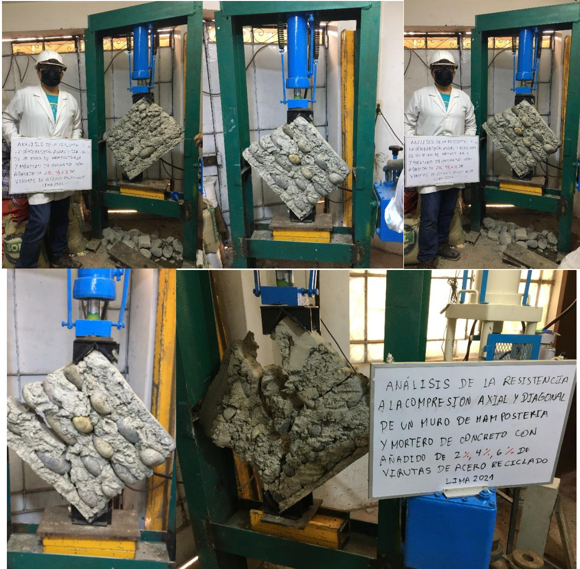
Figura 47: Ensayo de la resistencia a la compresión diagonal
