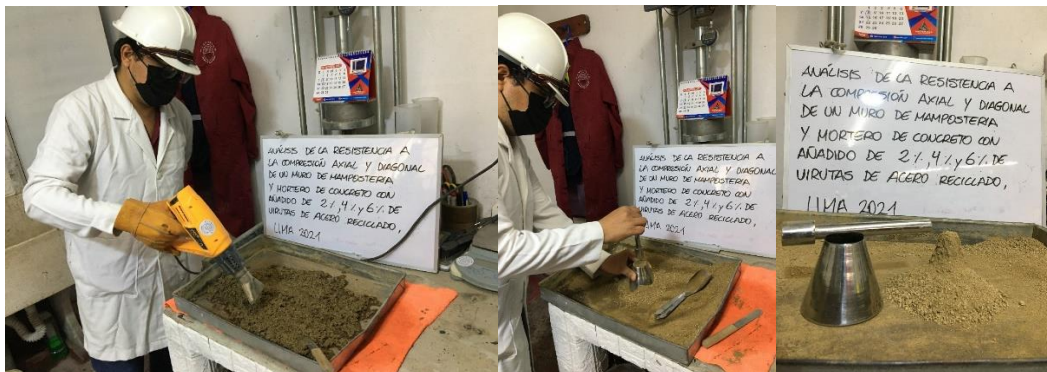
Figura 23: Ensayo de conito de absorción. Se apisona unas 25 veces dejando caer el pisón desde una altura aproximada de 1 cm. Todo esto para corroborar si el material se encuentra superficialmente seco.
