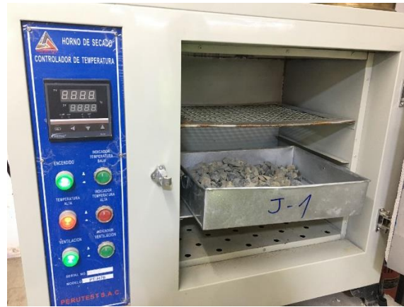
Figura 20: Agregado grueso (peso de muestra seca), a 110 °C durante aproximadamente 24 horas.
