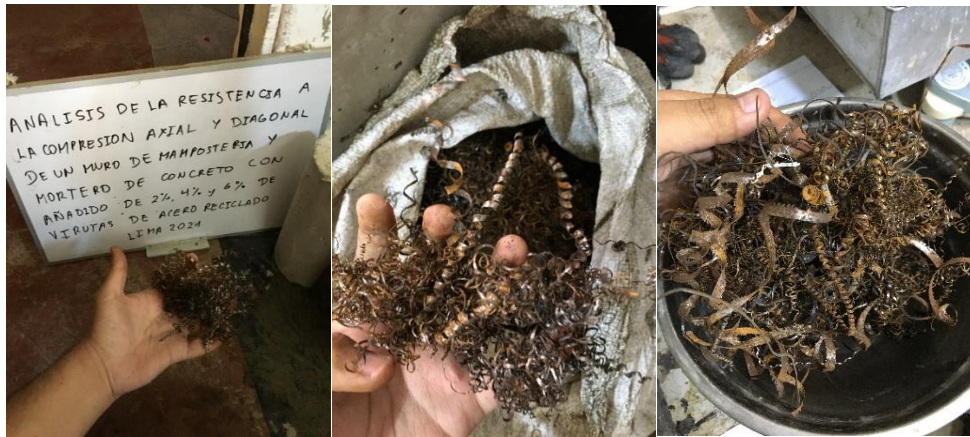
Figura 16: Virutas de acero a añadirse en proporción del peso del cemento
