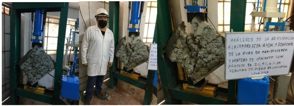
Figura 31: Ensayo a compresión diagonal
