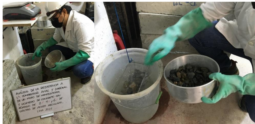
Figura 25: Se suspende un contenedor (canastilla) y se coloca el agregado grueso. Se registra la masa aparente del agregado saturado en agua (sumergido).
