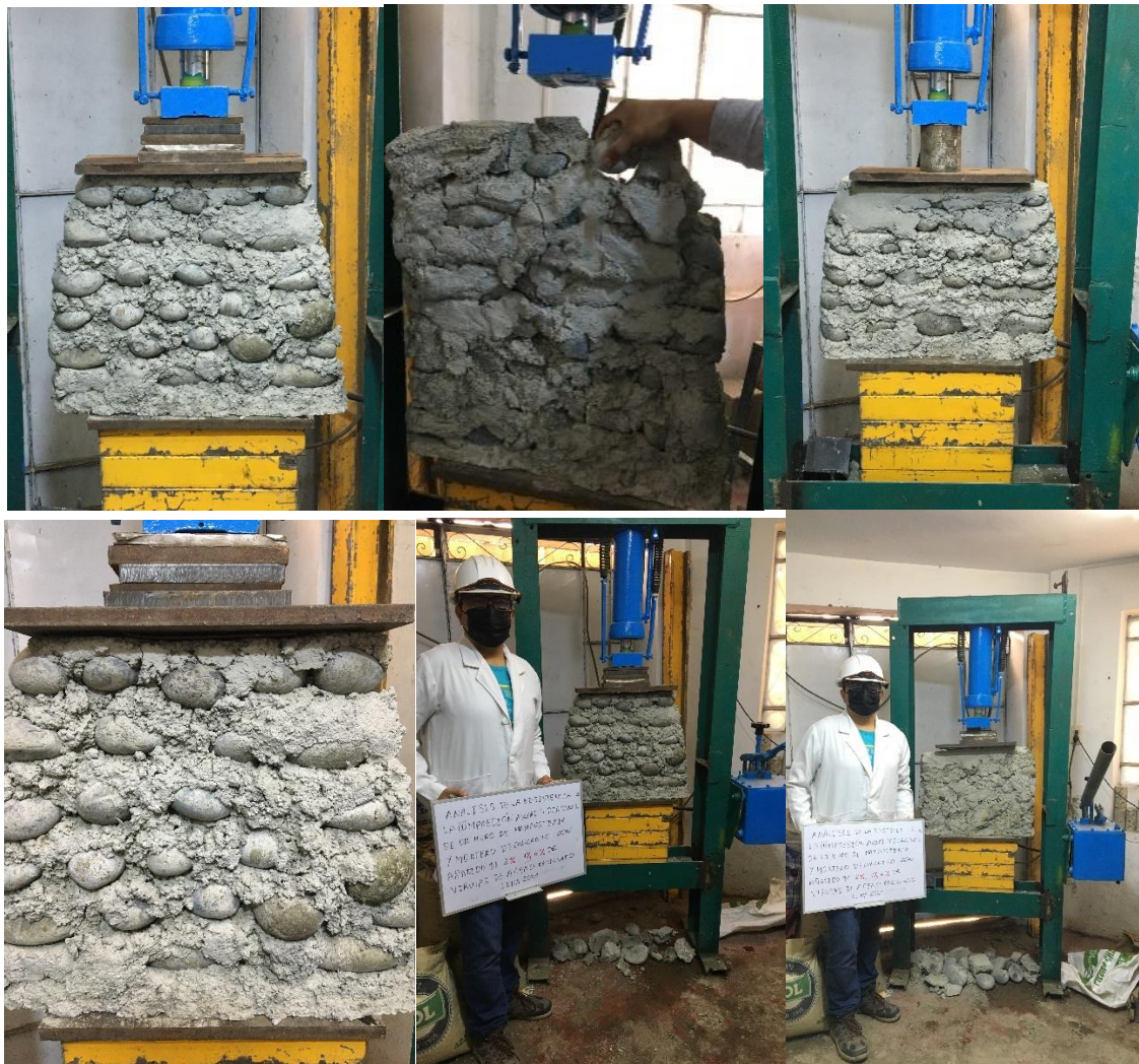
Figura 46: Ensayo de la resistencia a la compresión axial
