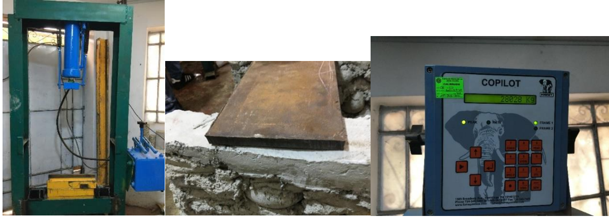
Figura 45: Para los ensayos se usó una prensa hidráulica y pletinas de acero para sostener la base.
