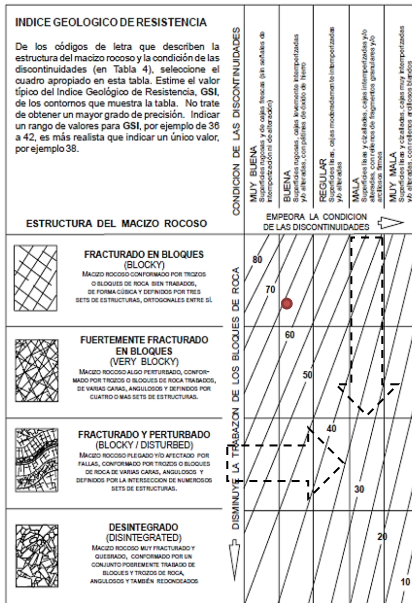
Figura:13 Ploteo del Valor de GSI, en función de las estructuras y condiciones de las discontinuidades; en el cual se aprecia que el valor de GSI es 65
