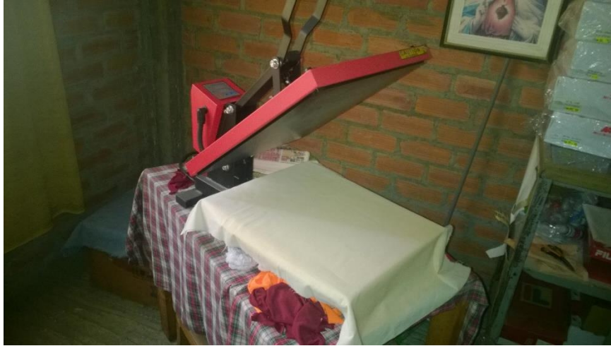
Figura 12. Máquina Transfer mecánica. Con ella se realiza actualmente los trabajos de Sublimación con un bajo rendimiento, alto esfuerzo físico junto con el consumo de energía eléctrica.
