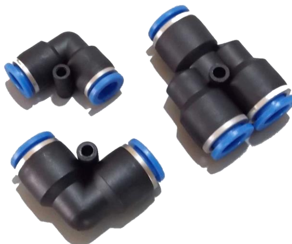
Figura 30. Conectores Rápidos de diámetro 8 mm. Se encargarán de realizar la conexión rápida de las mangueras y los dispositivos neumáticos. Rescatado de página web http://www.promintec.cl/product.php?producto=Acoples-Rapidos-Neumaticos&idProducto=5
