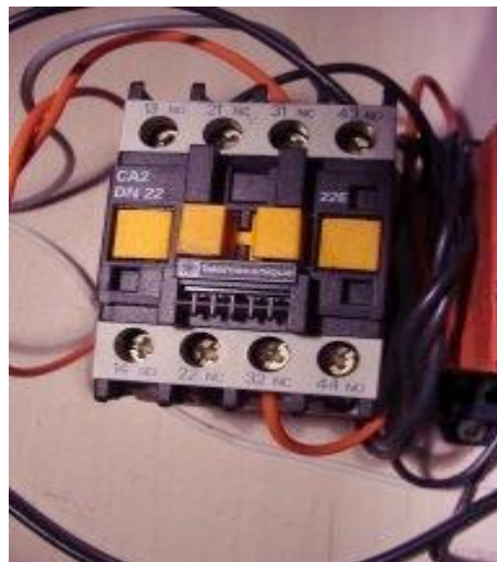
Figura 33. Contactador Telemecanique. De 4 polos, y bobina de 220v, capacidad de 10Amp para los contactos.
