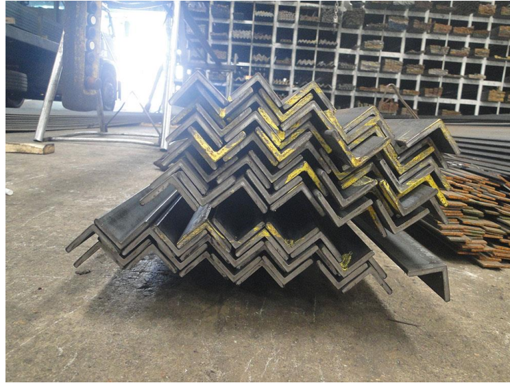
Figura 23. Material utilizado en la estructura del proyecto. El material es de la marca Siderperu, los ángulos fueron comprados con la medida 2" x \frac{1}{4} .
