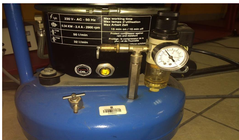
Figura 3. Compresor Neumático. Se utilizará como fuente de aire comprimido para el funcionamiento del cilindro neumático.
