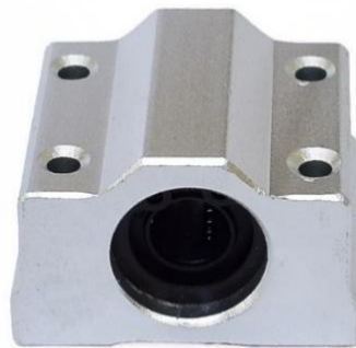
Figura 28. Rodamiento Lineal de 12mm. La carcasa es de aluminio con rosca de sujeción de 4 mm cuenta con un rodamiento de bolas aceradas, se colocaron para disminuir el coeficiente de Rozamiento del sistema. Recuperado de la página web https://naylampmechatronics .
