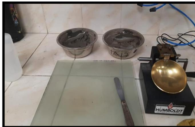
*Figura 4:* Ensayo de límites de atterberg
