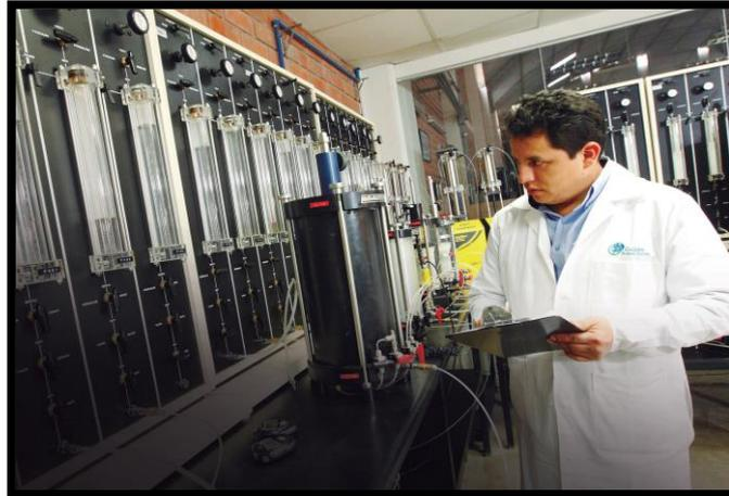
*Figura 7:* Panel y celdas acrílicas para ensayo triaxiales
