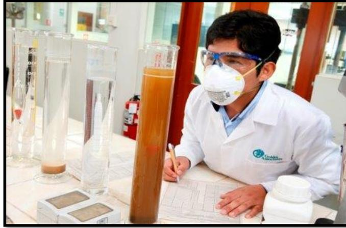
*Figura 3:* Ensayo de sedimentación.
