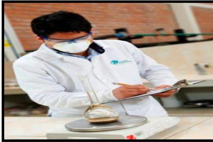
*Figura 5:* Ensayo de gravedad específica de sólidos finos
