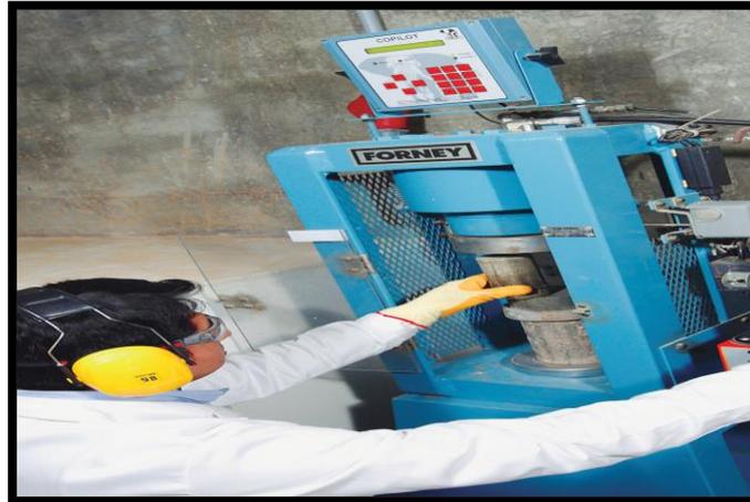
*Figura 10: Ensayo de compresión uniaxial*
