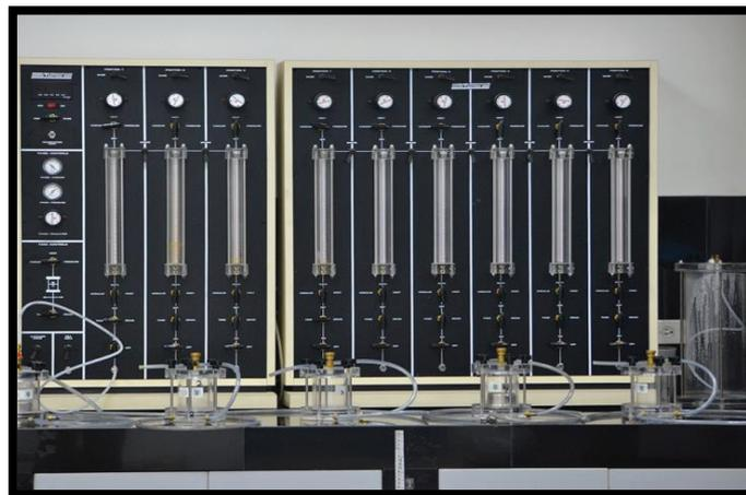
*Figura 8:* Ensayo de permeabilidad pared flexible
