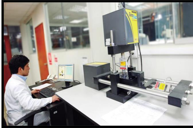
*Figura 9:* Ensayo de corte directo
