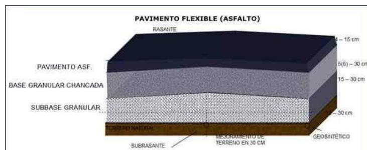
*Figura 1: Capas de un pavimento.* En la figura podemos observar un corte de una estructura de un pavimento constituido por un conjunto de capas superpuestas.
