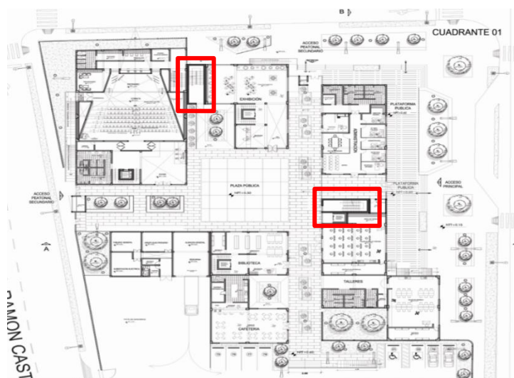
Figura 87. Ubicación de escaleras de evacuación
