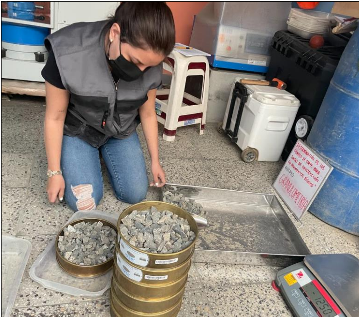
Figura 46. Ejecución del ensayo de granulometría del agregado grueso.
