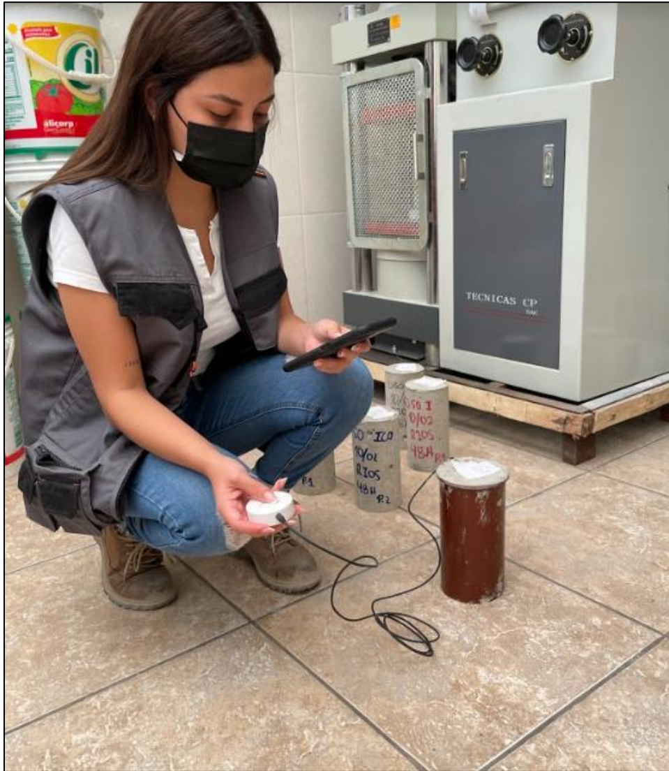
Figura 55. Toma de datos con el sensor de temperatura para cada una de las probetas elaboradas.
