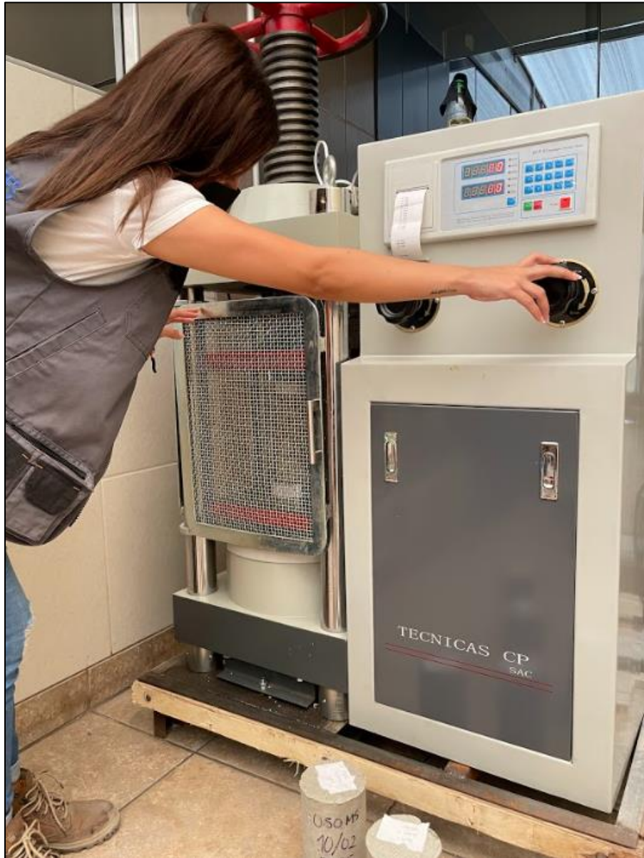
Figura 53. Ejecución del ensayo de resistencia a la compresión del concreto mediante rotura de probetas.
