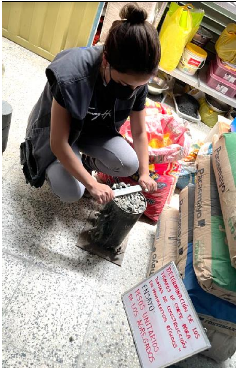
Figura 50. Ejecución del ensayo de peso unitario del agregado grueso.
