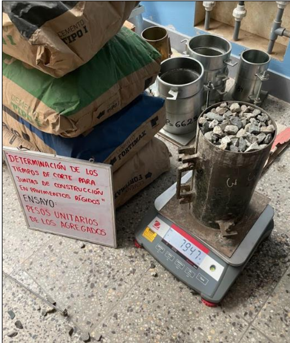
Figura 48. Obtención de datos para el ensayo de peso unitario del agregado grueso.
