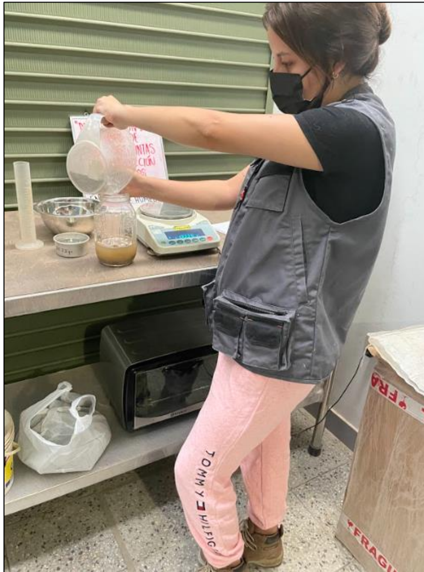
Figura 51. Ejecución del ensayo de contenido de humedad del agregado fino.
