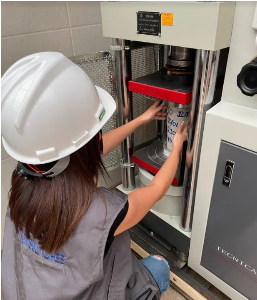
Figura 54. Ejecución del ensayo de resistencia a la compresión del concreto mediante rotura de probetas.
