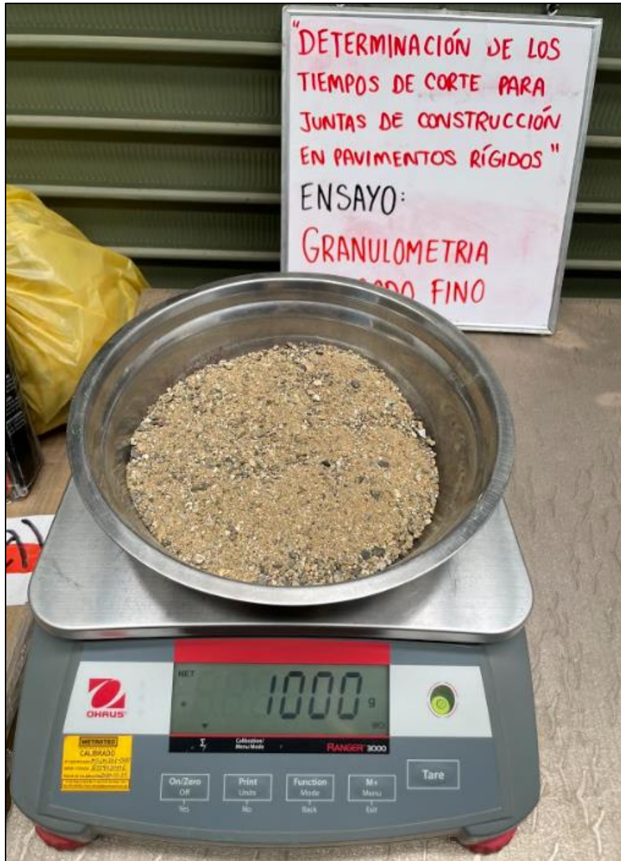
Figura 44. Obtención de datos para el ensayo de granulometría del agregado fino.
