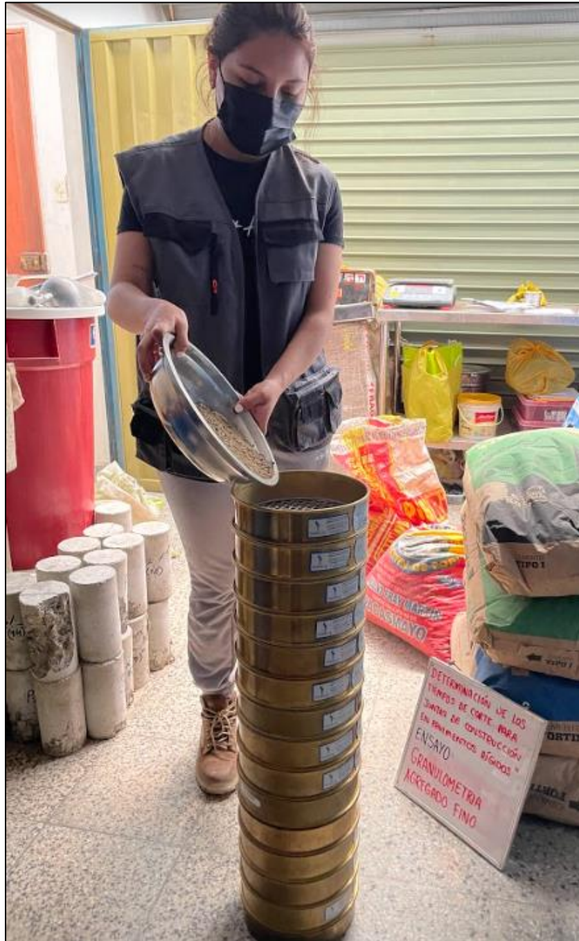
Figura 45. Tamizado para el ensayo de granulometría del agregado fino.
