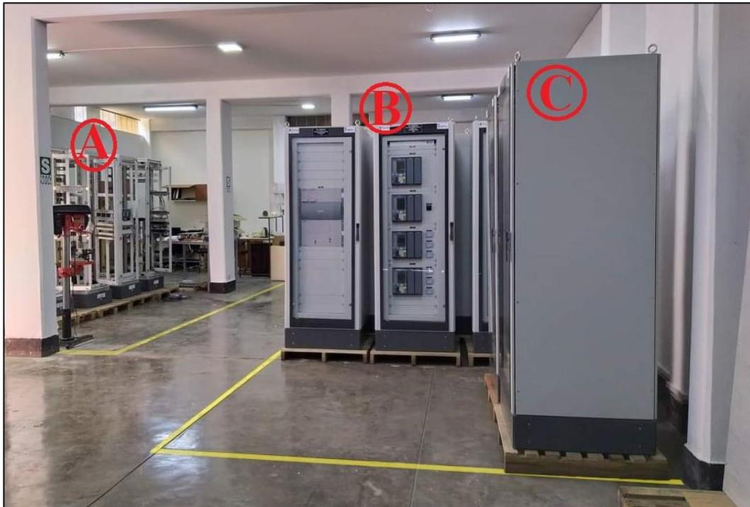
**Nota.** La presente figura muestra la ubicación A (armado e instalación), B (tablero en modo de prueba) y C (Tablero terminado), Famarc Electros SAC. 2021.
