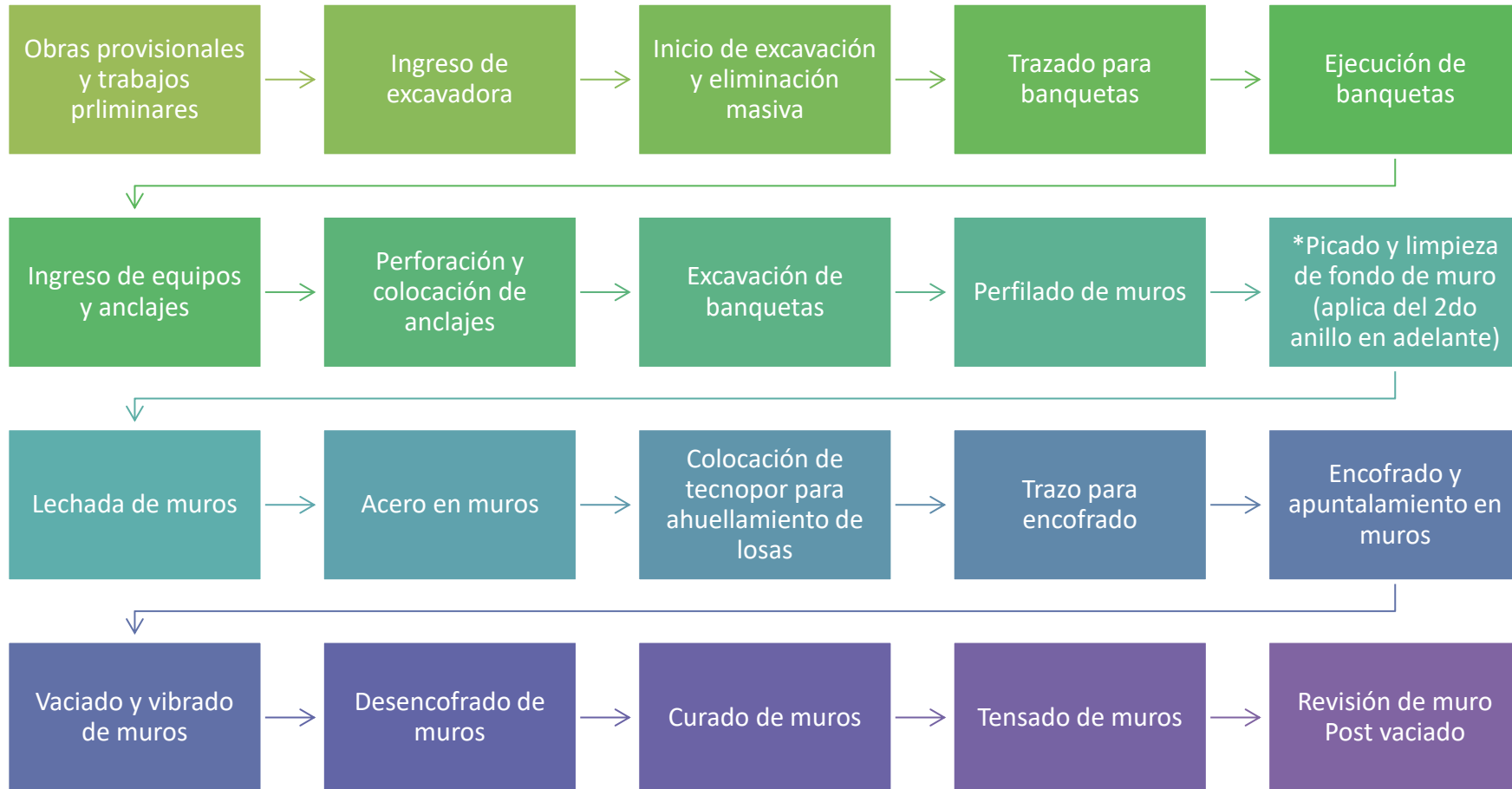
Figura 6. Proceso ejecución de Muros Anclados
