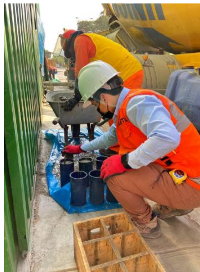
Figura 67. Preparación de probetas
