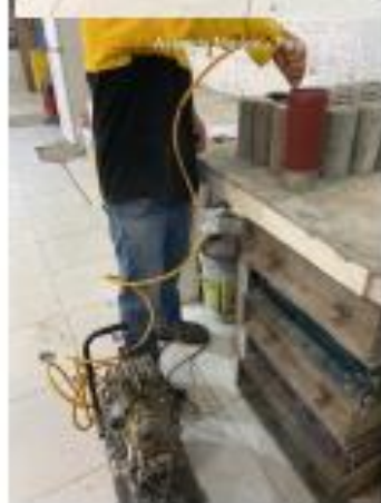
Figura 07. Aplicación de aire para el desmolde
