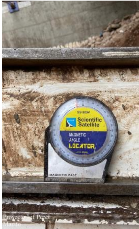
Figura 50. Inclinometro proyectando los 15°
