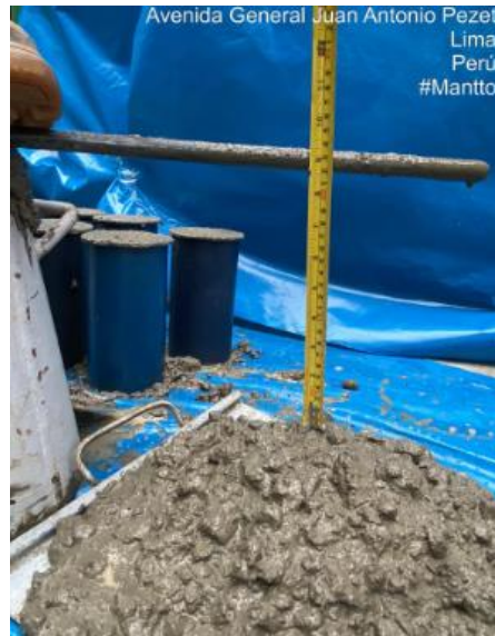
Figura 66. Ensayo de Slump
