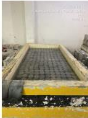
Figura 04. Piscina 01 con probetas para ensayos a 28 días
