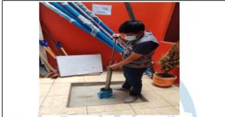
Foto 13: ensayo de proctor modificado
