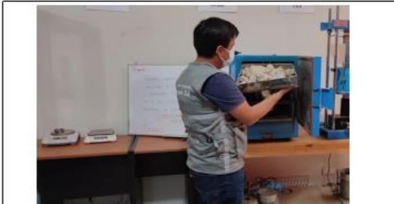
Foto 09: ensayo de contenido de humedad (colocado al horno)
