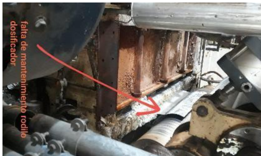
Figura 22. Desgaste prematuro de rodillo anilox dosificador
