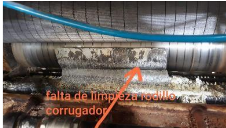
Figura 21. Desgaste en rodillo corrugador
