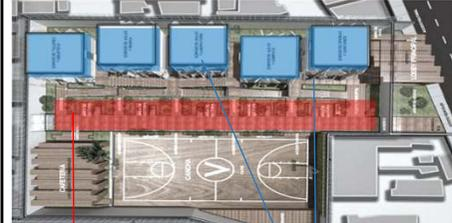
Eje Org. Por se módulos de contenedores estos están ensamblados paralelamente uno con otros, con la intención de ampliar el espacio educativo y ensamblados por gravedad (verticalmente) generando un segundo piso.
