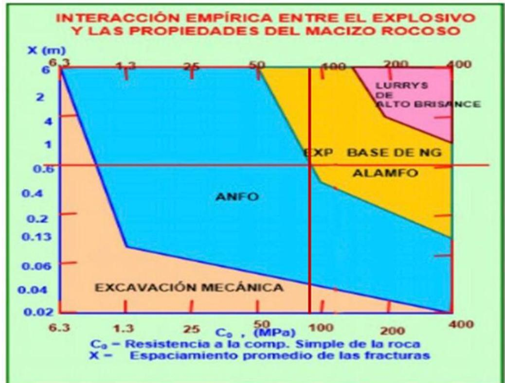
Según el estudio geomecánico la cantera no metálica presenta una resistencia a la compresión simple entre 50Mpa y 100 Mpa y un espaciamiento promedio de las fracturas menor a 1m, en tal sentido realizando la correlación en la Figura 11 vemos que se debe utilizar ANFO aluminizado o un explosivo en base de Nitroglicerina, como la Dinamita.
