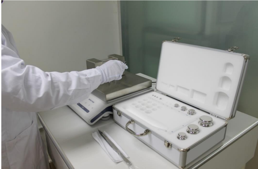
Figura 7: Calibración de equipos de medición.
