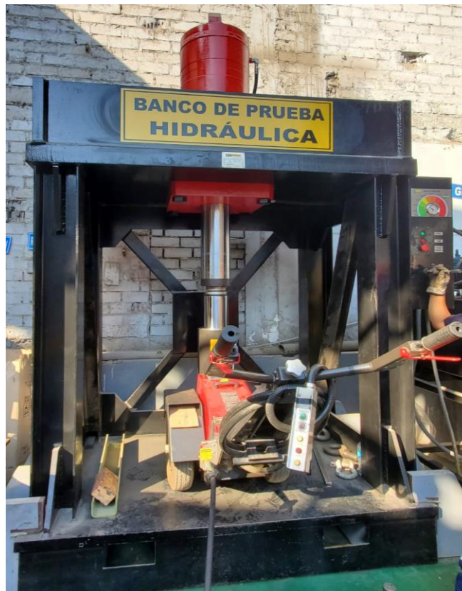
Figura 41: Prueba de gata hidráulica 200 toneladas en banco de pruebas.
