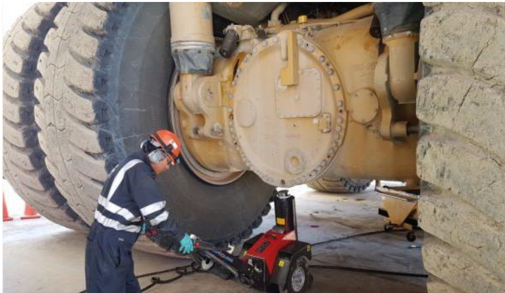
Figura 22. Operación de levante de camión minero usando una gata hidráulica Durapac
