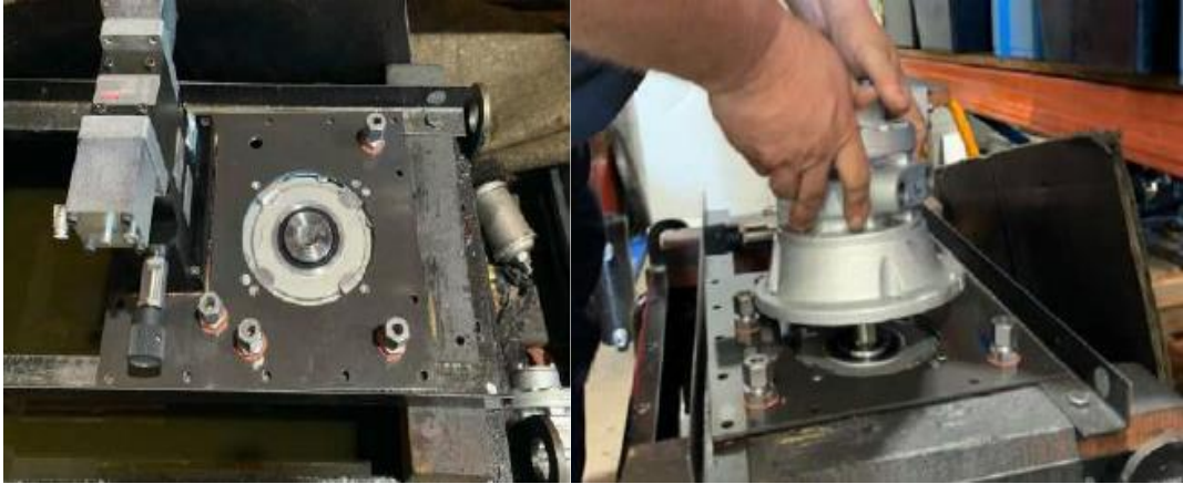
Figura 25. Personal realizando desmontaje de bomba de gata hidráulica.
