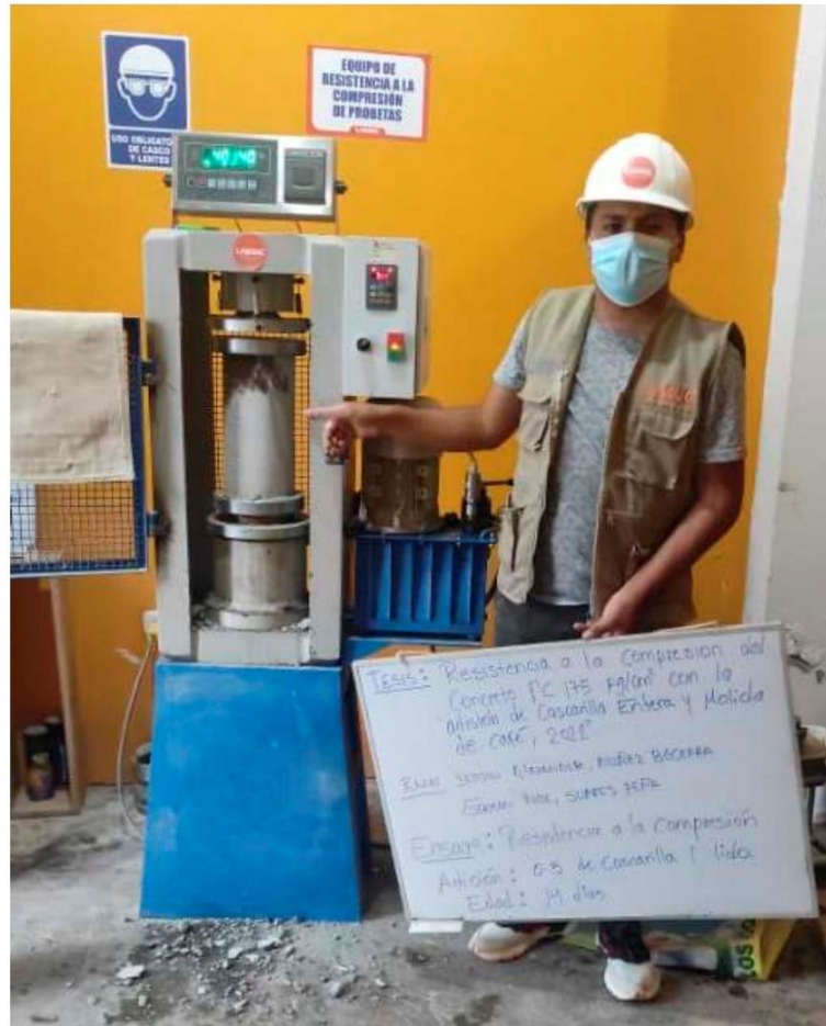
FOTOGRAFÍA 12: Ensayo a compresión de testigos de concreto bajo la norma ASTM C39 de la muestra de concreto con la adición de 0.5 % de cascarilla molida de café a los 14 días del Proyecto tesis: "Resistencia A La Compresión Del Concreto f_c=175 \text{ Kg/Cm}^2 Con La Adición De Cascarilla Entera Y Molida De Café, 2021".
