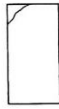
Tipo 5 Fracturas en los lados en las partes superior o inferior (ocurre comúnmente con cabezales no adheridos)
