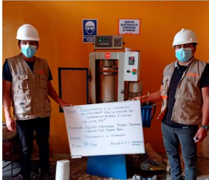
FOTOGRAFÍA 36: Ensayo a compresión de testigos de concreto bajo la norma ASTM C39 de la muestra de concreto con la adición de 0.5 % de cascarilla entera de café a los 28 días del Proyecto tesis: "Resistencia A La Compresión Del Concreto f_c=175 \text{ Kg/Cm}^2 Con La Adición De Cascarilla Entera Y Molida De Café, 2021".
