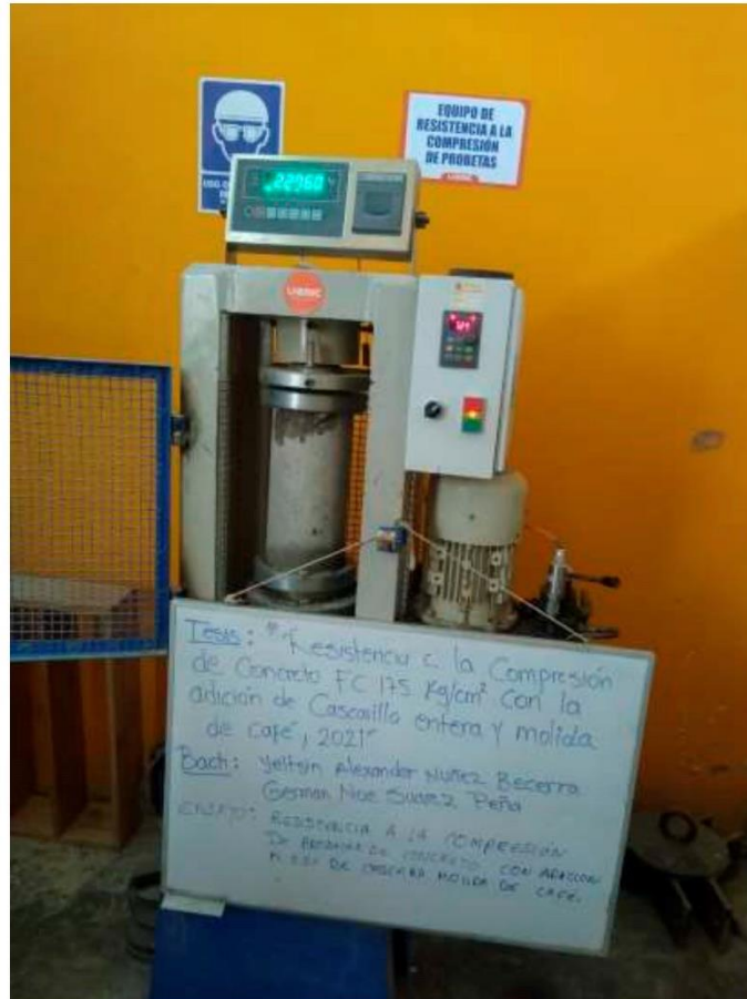
FOTOGRAFÍA 26: Ensayo a compresión de testigos de concreto bajo la norma ASTM C39 de la muestra de concreto con la adición de 2.5 % de cascarilla molida de café a los 14 días del Proyecto tesis: "Resistencia A La Compresión Del Concreto f_c=175 \text{ Kg/Cm}^2 Con La Adición De Cascarilla Entera Y Molida De Café, 2021".
