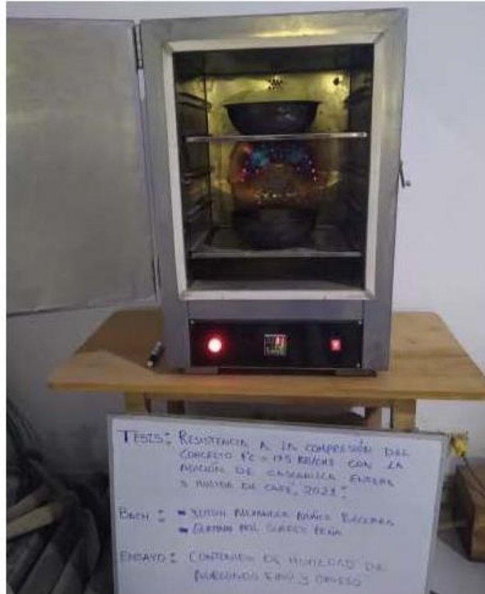
FOTOGRAFÍA 01: Muestra la ejecución del ensayo de contenido de humedad del agregado grueso y fino, de la cantera Olano para el Proyecto tesis: "Resistencia A La Compresión Del Concreto F'_c=175 \text{ Kg/Cm}^2 Con La Adición De Cascarilla Entera Y Molida De Café, 2021".
