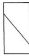
Tipo 4 Fractura diagonal sin fisuras a través de los extremos; golpeado suavemente con un martillo para distinguirla del Tipo 1
