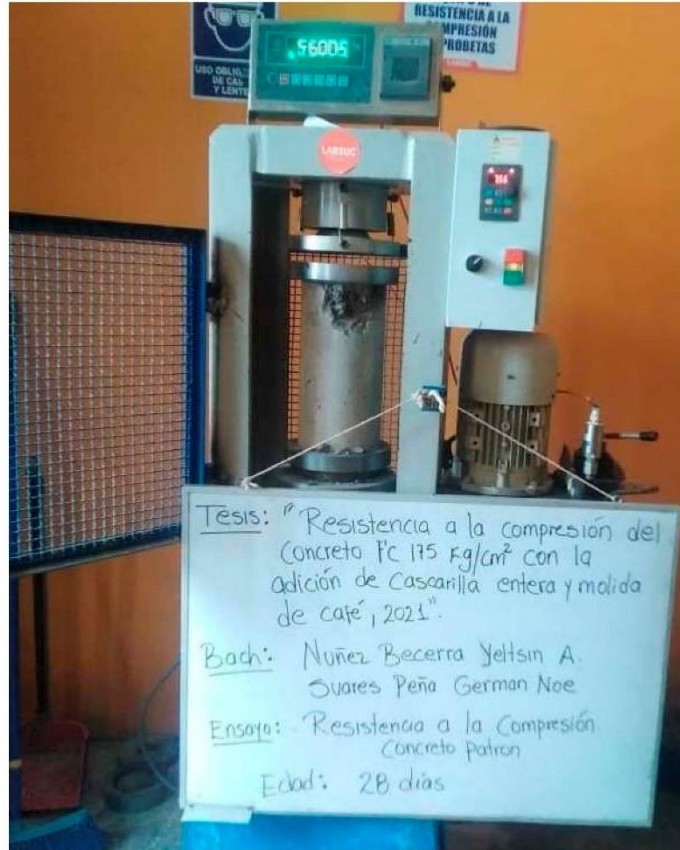
FOTOGRAFÍA 07: Ensayo a compresión de testigos de concreto bajo la norma ASTM C39 de la muestra de concreto patrón a los 28 días del Proyecto tesis: "Resistencia A La Compresión Del Concreto f_c=175 \text{ Kg/Cm}^2 Con La Adición De Cascarilla Entera Y Molida De Café, 2021".
