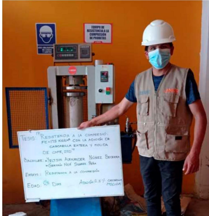
FOTOGRAFÍA 15: Ensayo a compresión de testigos de concreto bajo la norma ASTM C39 de la muestra de concreto con la adición de 0.5 % de cascarilla molida de café a los 28 días del Proyecto tesis: "Resistencia A La Compresión Del Concreto f_c=175 \text{ Kg/Cm}^2 Con La Adición De Cascarilla Entera Y Molida De Café, 2021".
