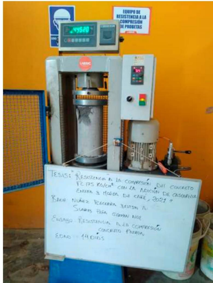
FOTOGRAFÍA 04: Ensayo a compresión de testigos de concreto bajo la norma ASTM C39 de la muestra de concreto patrón a los 14 días del Proyecto tesis: "Resistencia A La Compresión Del Concreto f'c=175 \text{ Kg/Cm}^2 Con La Adición De Cascarilla Entera Y Molida De Café, 2021".
