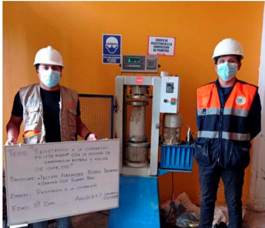
FOTOGRAFÍA 49: Ensayo a compresión de testigos de concreto bajo la norma ASTM C39 de la muestra de concreto con la adición de 2.5 % de cascarilla entera de café a los 7 días del Proyecto tesis: "Resistencia A La Compresión Del Concreto f'c=175 \text{ Kg/Cm}^2 Con La Adición De Cascarilla Entera Y Molida De Café, 2021".
