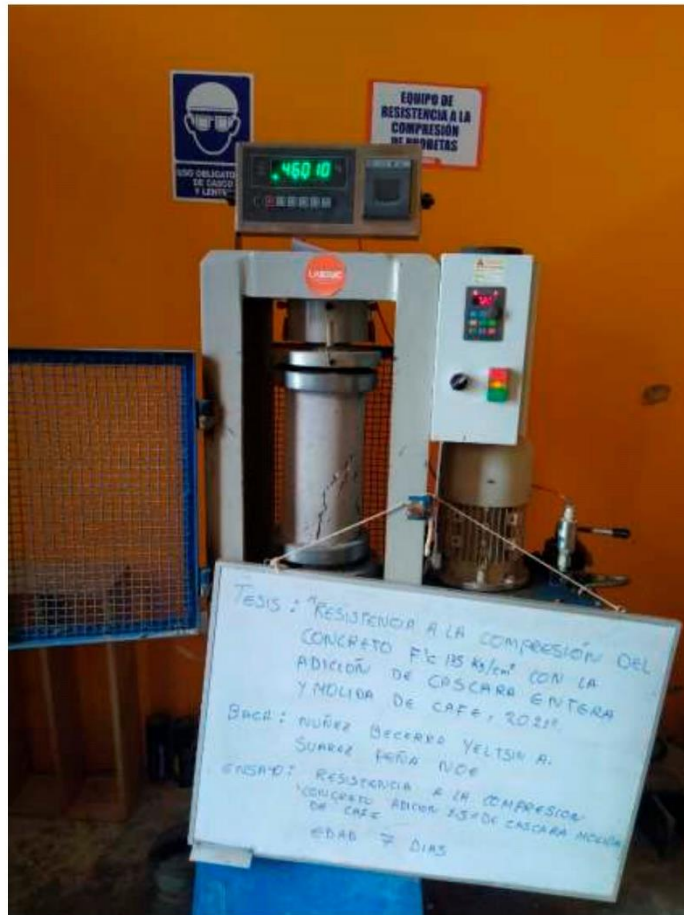
FOTOGRAFÍA 18: Ensayo a compresión de testigos de concreto bajo la norma ASTM C39 de la muestra de concreto con la adición de 1.5 % de cascarilla molida de café a los 7 días del Proyecto tesis: "Resistencia A La Compresión Del Concreto f_c=175 \text{ Kg/Cm}^2 Con La Adición De Cascarilla Entera Y Molida De Café, 2021".
