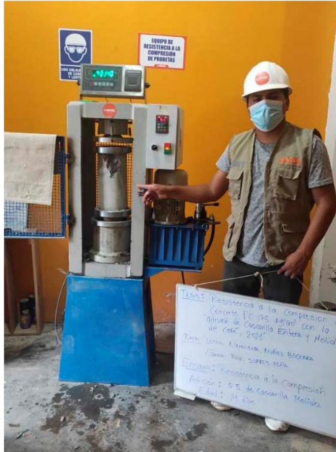
FOTOGRAFÍA 11: Ensayo a compresión de testigos de concreto bajo la norma ASTM C39 de la muestra de concreto con la adición de 0.5 % de cascarilla molida de café a los 14 días del Proyecto tesis: "Resistencia A La Compresión Del Concreto f_c=175 \text{ Kg/Cm}^2 Con La Adición De Cascarilla Entera Y Molida De Café, 2021".
