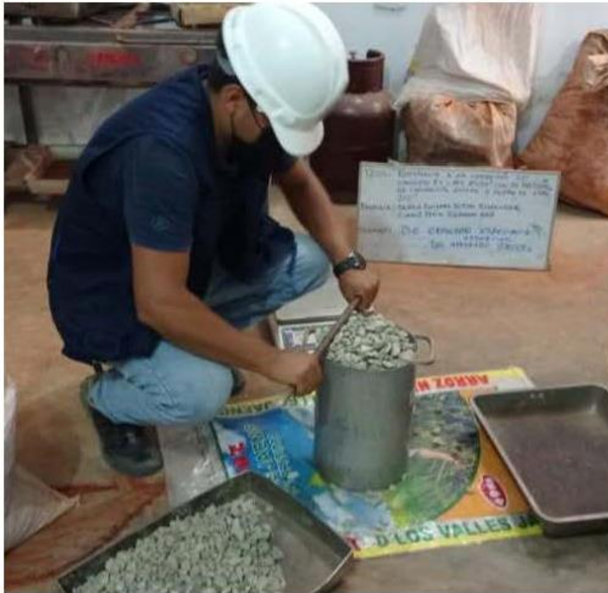
FOTOGRAFÍA 05: Muestra la ejecución del ensayo de pesos unitarios del agregado grueso, de la cantera Olano para el Proyecto tesis: "Resistencia A La Compresión Del Concreto f'c=175 \text{ Kg/Cm}^2 Con La Adición De Cascarilla Entera Y Molida De Café, 2021".
