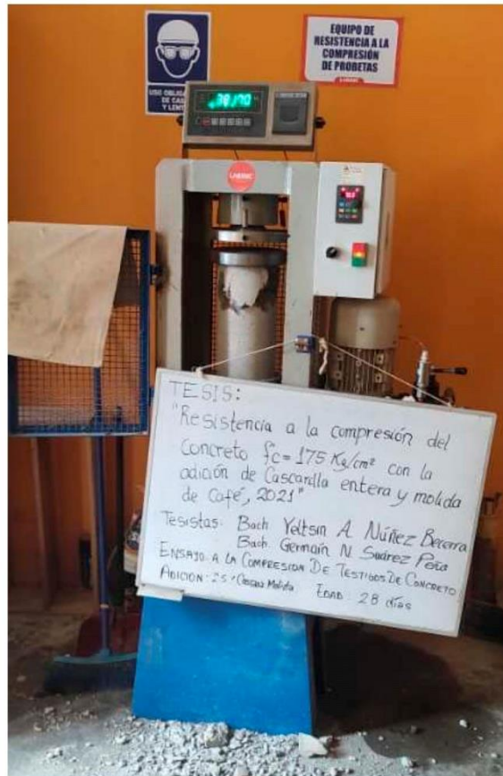
FOTOGRAFÍA 28: Ensayo a compresión de testigos de concreto bajo la norma ASTM C39 de la muestra de concreto con la adición de 2.5 % de cascarilla molida de café a los 28 días del Proyecto tesis: "Resistencia A La Compresión Del Concreto f_c=175 \text{ Kg/Cm}^2 Con La Adición De Cascarilla Entera Y Molida De Café, 2021".
