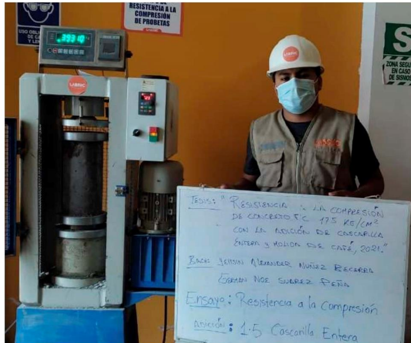
FOTOGRAFÍA 42: Ensayo a compresión de testigos de concreto bajo la norma ASTM C39 de la muestra de concreto con la adición de 1.5 % de cascarilla entera de café a los 14 días del Proyecto tesis: "Resistencia A La Compresión Del Concreto f'c=175 \text{ Kg/Cm}^2 Con La Adición De Cascarilla Entera Y Molida De Café, 2021".
