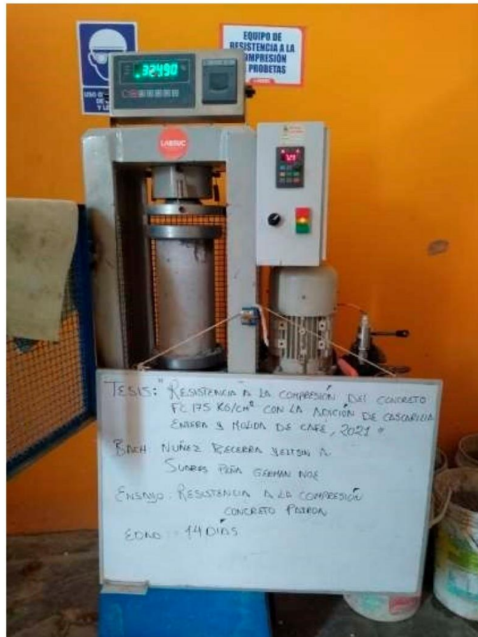
FOTOGRAFÍA 05: Ensayo a compresión de testigos de concreto bajo la norma ASTM C39 de la muestra de concreto patrón a los 14 días del Proyecto tesis: "Resistencia A La Compresión Del Concreto f'_c=175 \text{ Kg/Cm}^2 Con La Adición De Cascarilla Entera Y Molida De Café, 2021".
