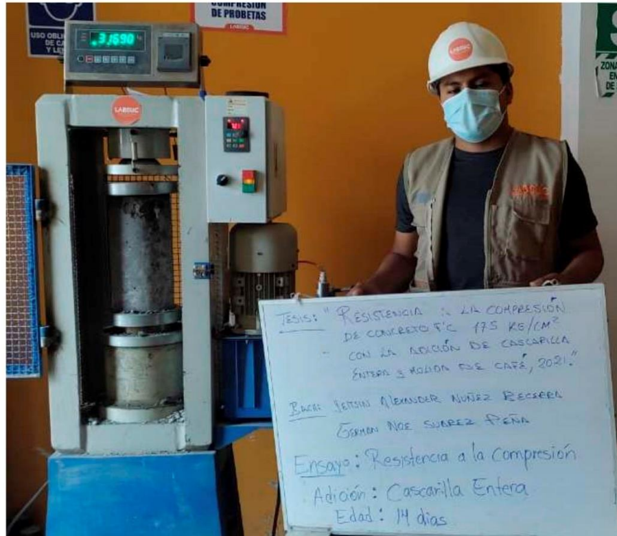
FOTOGRAFÍA 44: Ensayo a compresión de testigos de concreto bajo la norma ASTM C39 de la muestra de concreto con la adición de 1.5 % de cascarilla entera de café a los 14 días del Proyecto tesis: "Resistencia A La Compresión Del Concreto f'c=175 \text{ Kg/Cm}^2 Con La Adición De Cascarilla Entera Y Molida De Café, 2021".
