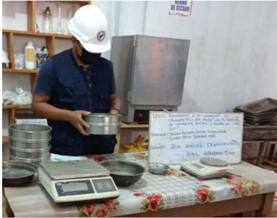
FOTOGRAFÍA 03: Muestra la ejecución del ensayo de análisis granulométrico del agregado fino, de la cantera Olano para el Proyecto tesis: "Resistencia A La Compresión Del Concreto f'c=175 \text{ Kg/Cm}^2 Con La Adición De Cascarilla Entera Y Molida De Café, 2021".
