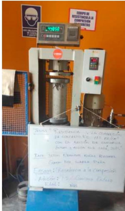
FOTOGRAFÍA 39: Ensayo a compresión de testigos de concreto bajo la norma ASTM C39 de la muestra de concreto con la adición de 1.5 % de cascarilla entera de café a los 7 días del Proyecto tesis: "Resistencia A La Compresión Del Concreto f_c=175 \text{ Kg/Cm}^2 Con La Adición De Cascarilla Entera Y Molida De Café, 2021".
