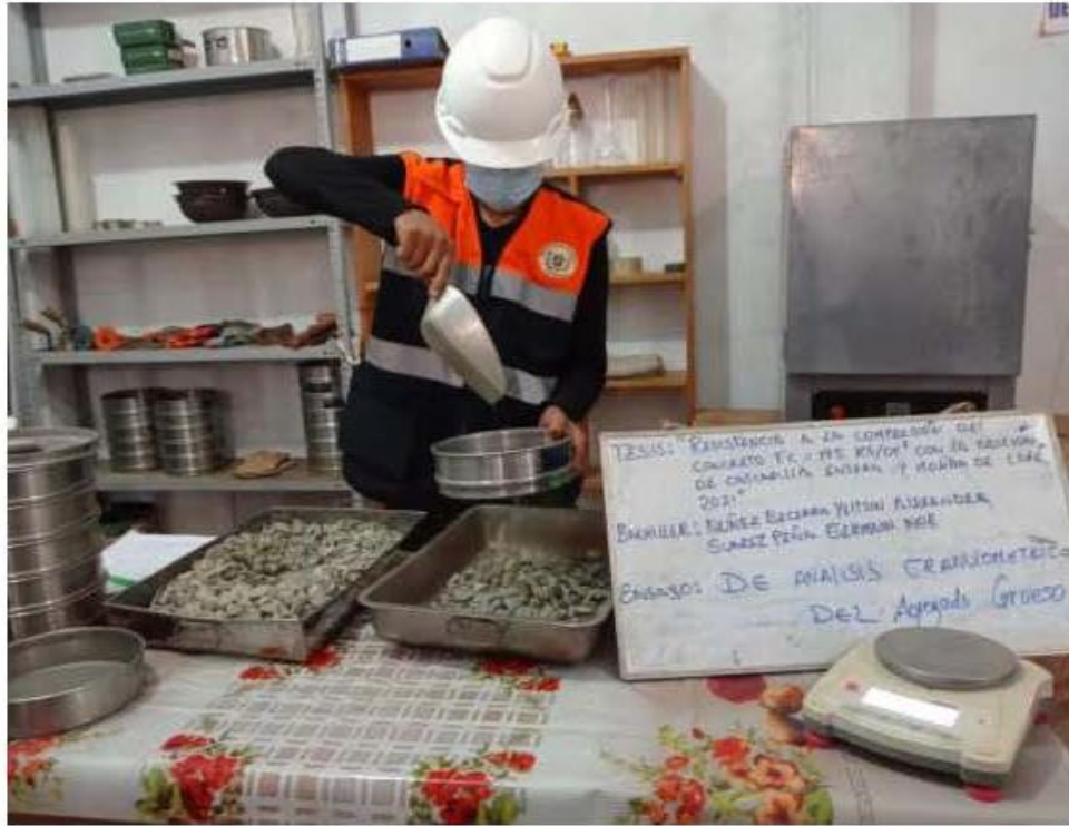
FOTOGRAFÍA 02: Muestra la ejecución del ensayo de análisis granulométrico del agregado grueso, de la cantera Olano para el Proyecto tesis "Resistencia A La Compresión Del Concreto f'c=175 \text{ Kg/Cm}^2 Con La Adición De Cascarilla Entera Y Molida De Café, 2021".
