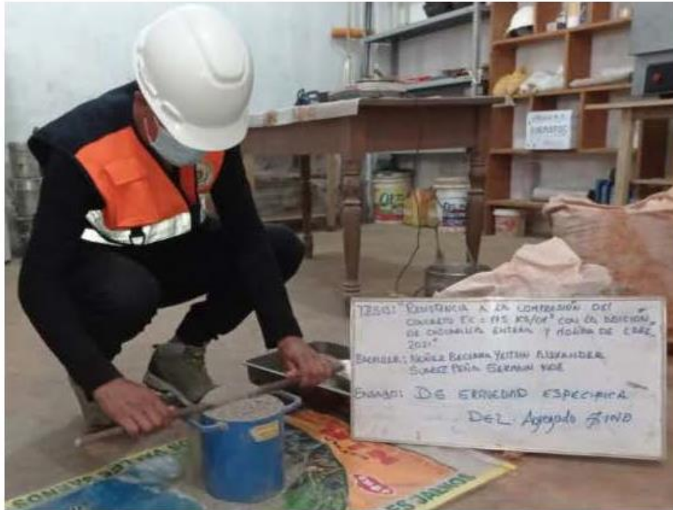
FOTOGRAFÍA 04: Muestra la ejecución del ensayo de pesos unitarios del agregado fino, de la cantera Olano para el Proyecto tesis: "Resistencia A La Compresión Del Concreto f'c=175 \text{ Kg/Cm}^2 Con La Adición De Cascarilla Entera Y Molida De Café, 2021".
