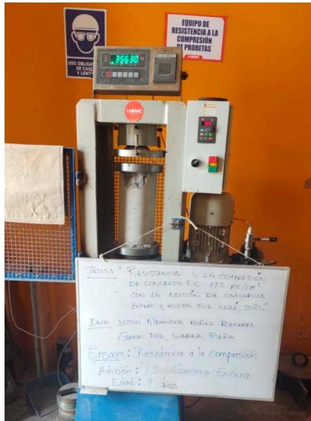
FOTOGRAFÍA 41: Ensayo a compresión de testigos de concreto bajo la norma ASTM C39 de la muestra de concreto con la adición de 1.5 % de cascarilla entera de café a los 7 días del Proyecto tesis: "Resistencia A La Compresión Del Concreto f_c=175 \text{ Kg/Cm}^2 Con La Adición De Cascarilla Entera Y Molida De Café, 2021".
