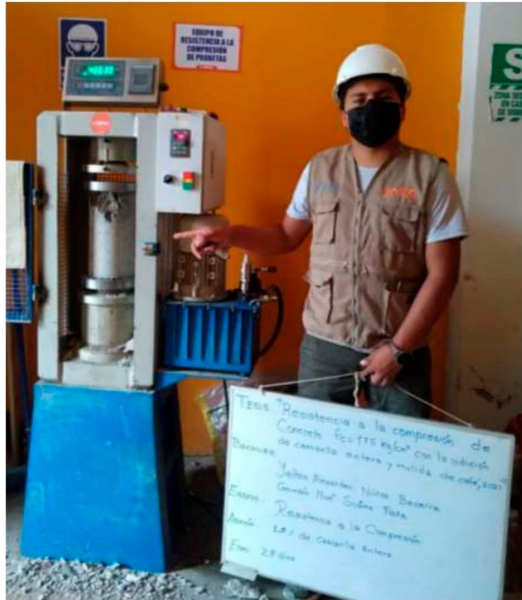
FOTOGRAFÍA 45: Ensayo a compresión de testigos de concreto bajo la norma ASTM C39 de la muestra de concreto con la adición de 1.5 % de cascarilla entera de café a los 28 días del Proyecto tesis: "Resistencia A La Compresión Del Concreto f_c=175 \text{ Kg/Cm}^2 Con La Adición De Cascarilla Entera Y Molida De Café, 2021".
