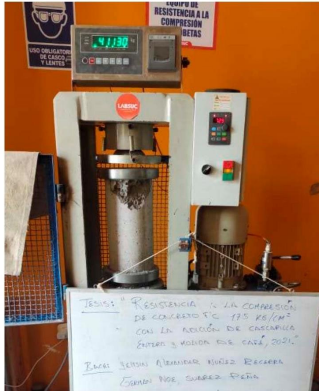
FOTOGRAFÍA 48: Ensayo a compresión de testigos de concreto bajo la norma ASTM C39 de la muestra de concreto con la adición de 2.5 % de cascarilla entera de café a los 7 días del Proyecto tesis: "Resistencia A La Compresión Del Concreto f'_c=175 \text{ Kg/Cm}^2 Con La Adición De Cascarilla Entera Y Molida De Café, 2021".
