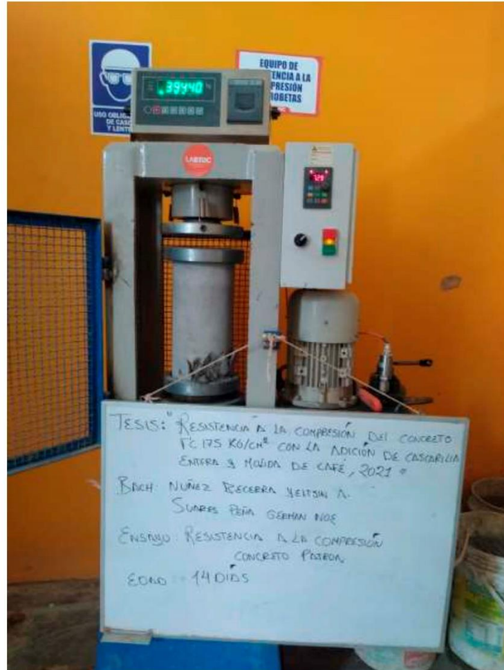
FOTOGRAFÍA 03: Ensayo a compresión de testigos de concreto bajo la norma ASTM C39 de la muestra de concreto patrón a los 14 días del Proyecto tesis: "Resistencia A La Compresión Del Concreto f_c=175 \text{ Kg/Cm}^2 Con La Adición De Cascarilla Entera Y Molida De Café, 2021".
