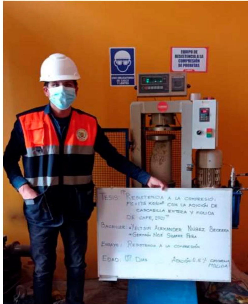
FOTOGRAFÍA 10: Ensayo a compresión de testigos de concreto bajo la norma ASTM C39 de la muestra de concreto con la adición de 0.5 % de cascarilla molida de café a los 7 días del Proyecto tesis: "Resistencia A La Compresión Del Concreto f_c=175 \text{ Kg/Cm}^2 Con La Adición De Cascarilla Entera Y Molida De Café, 2021".
