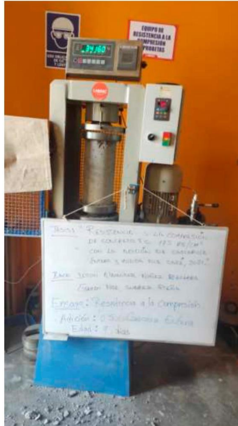
FOTOGRAFÍA 31: Ensayo a compresión de testigos de concreto bajo la norma ASTM C39 de la muestra de concreto con la adición de 0.5 % de cascarilla entera de café a los 7 días del Proyecto tesis: "Resistencia A La Compresión Del Concreto f_c=175 \text{ Kg/Cm}^2 Con La Adición De Cascarilla Entera Y Molida De Café, 2021".
