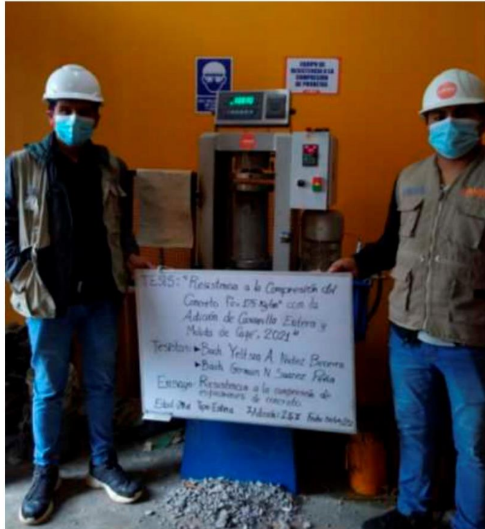
FOTOGRAFÍA 51: Ensayo a compresión de testigos de concreto bajo la norma ASTM C39 de la muestra de concreto con la adición de 2.5 % de cascarilla entera de café a los 28 días del Proyecto tesis: "Resistencia A La Compresión Del Concreto f_c=175 \text{ Kg/Cm}^2 Con La Adición De Cascarilla Entera Y Molida De Café, 2021".
