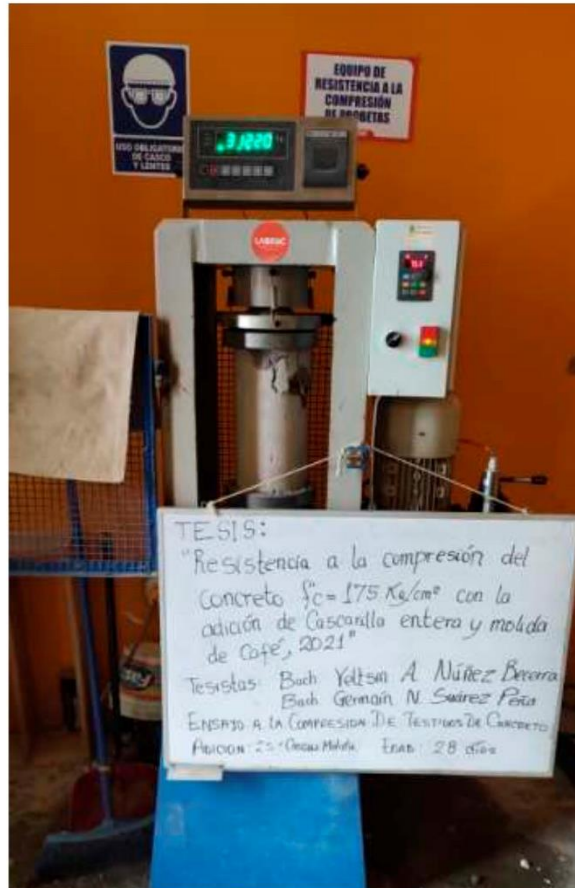
FOTOGRAFÍA 30: Ensayo a compresión de testigos de concreto bajo la norma ASTM C39 de la muestra de concreto con la adición de 2.5 % de cascarilla molida de café a los 28 días del Proyecto tesis: "Resistencia A La Compresión Del Concreto f_c=175 \text{ Kg/CM}^2 Con La Adición De Cascarilla Entera Y Molida De Café, 2021".
