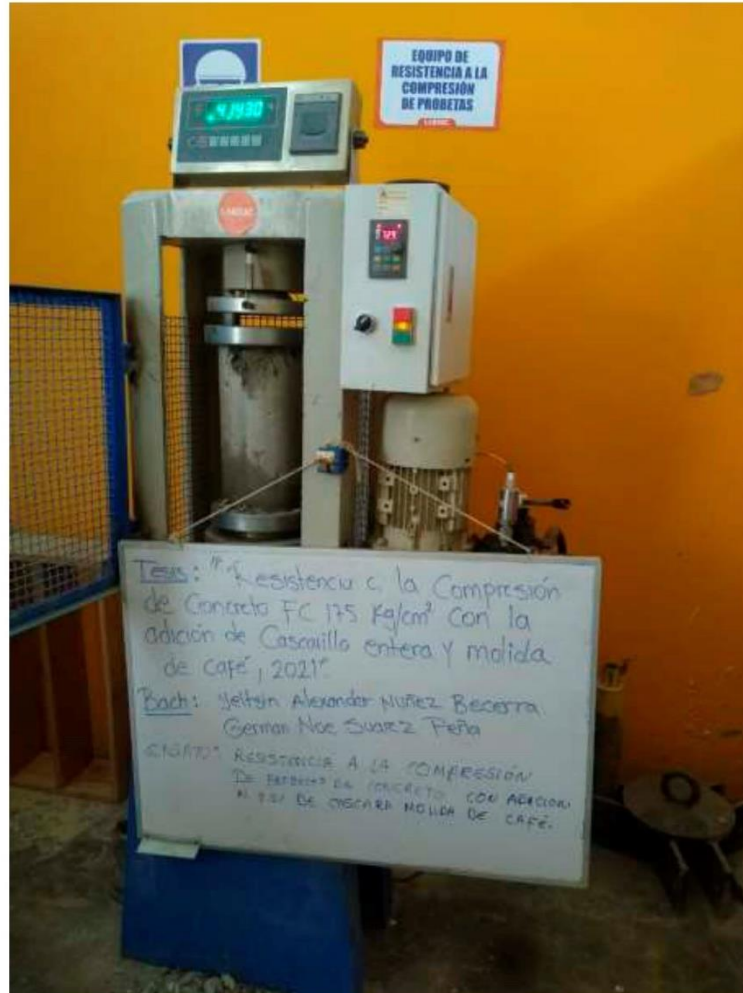
FOTOGRAFÍA 25: Ensayo a compresión de testigos de concreto bajo la norma ASTM C39 de la muestra de concreto con la adición de 2.5 % de cascarilla molida de café a los 14 días del Proyecto tesis: "Resistencia A La Compresión Del Concreto f_c=175 \text{ Kg/Cm}^2 Con La Adición De Cascarilla Entera Y Molida De Café, 2021".
