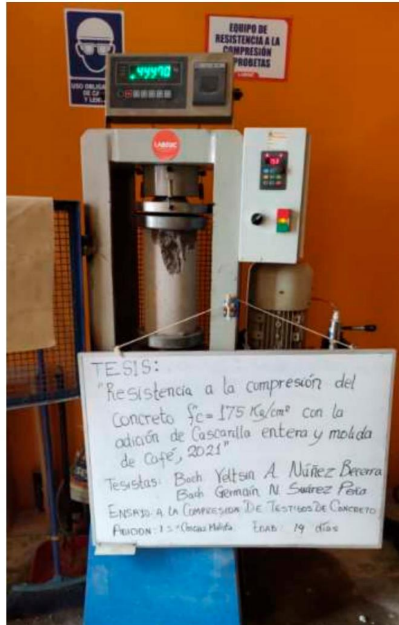
FOTOGRAFÍA 20: Ensayo a compresión de testigos de concreto bajo la norma ASTM C39 de la muestra de concreto con la adición de 1.5 % de cascarilla molida de café a los 14 días del Proyecto tesis: "Resistencia A La Compresión Del Concreto f_c=175 \text{ Kg/Cm}^2 Con La Adición De Cascarilla Entera Y Molida De Café, 2021".
