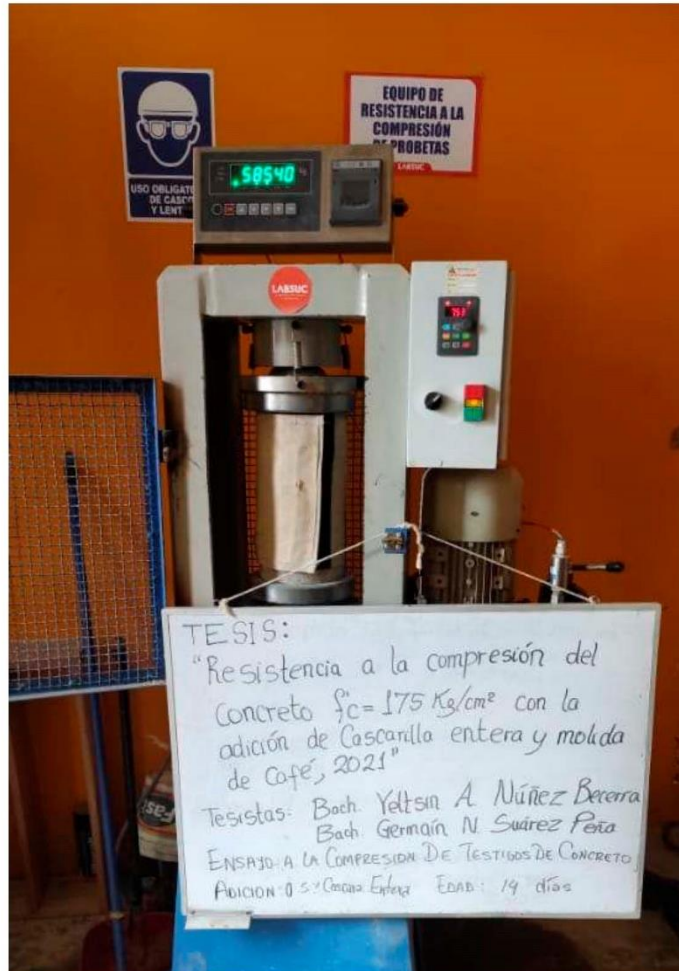
FOTOGRAFÍA 35: Ensayo a compresión de testigos de concreto bajo la norma ASTM C39 de la muestra de concreto con la adición de 0.5 % de cascarilla entera de café a los 14 días del Proyecto tesis: "Resistencia A La Compresión Del Concreto f'_c=175 \text{ Kg/Cm}^2 Con La Adición De Cascarilla Entera Y Molida De Café, 2021".
