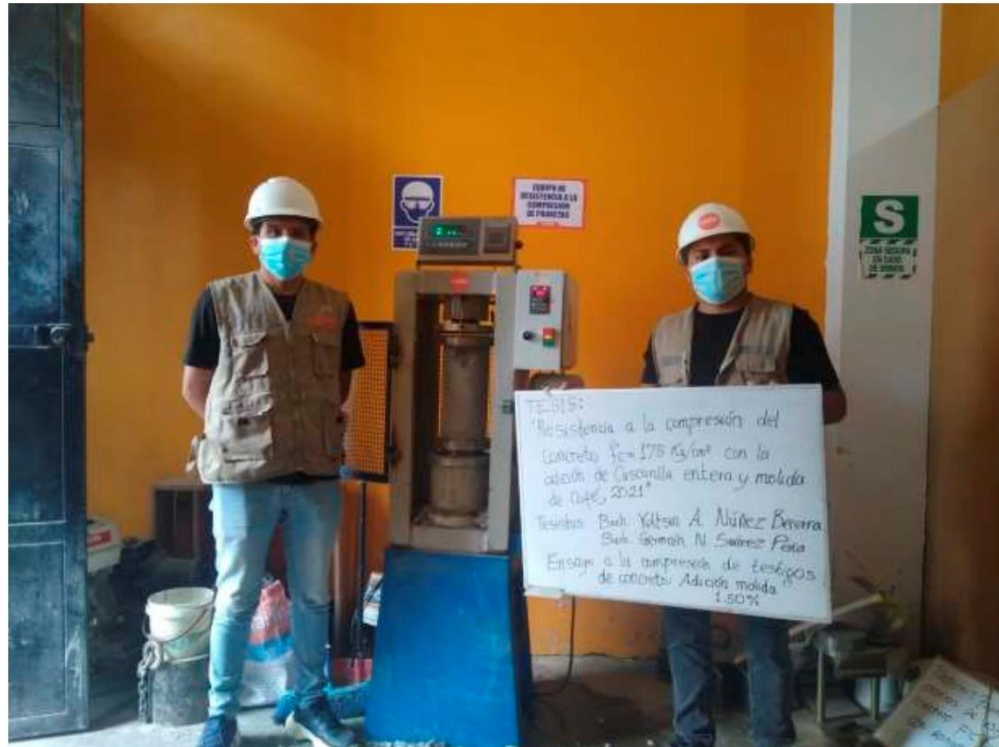
FOTOGRAFÍA 22: Ensayo a compresión de testigos de concreto bajo la norma ASTM C39 de la muestra de concreto con la adición de 1.5 % de cascarilla molida de café a los 28 días del Proyecto tesis: "Resistencia A La Compresión Del Concreto f'c=175 \text{ Kg/Cm}^2 Con La Adición De Cascarilla Entera Y Molida De Café, 2021".
