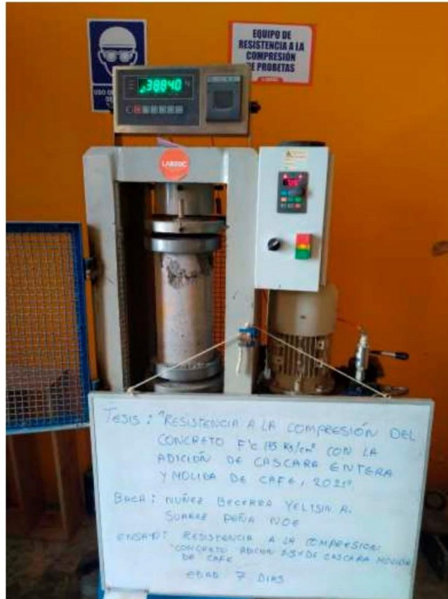
FOTOGRAFÍA 16: Ensayo a compresión de testigos de concreto bajo la norma ASTM C39 de la muestra de concreto con la adición de 1.5 % de cascarilla molida de café a los 7 días del Proyecto tesis: "Resistencia A La Compresión Del Concreto f_c=175 \text{ Kg/Cm}^2 Con La Adición De Cascarilla Entera Y Molida De Café, 2021".
