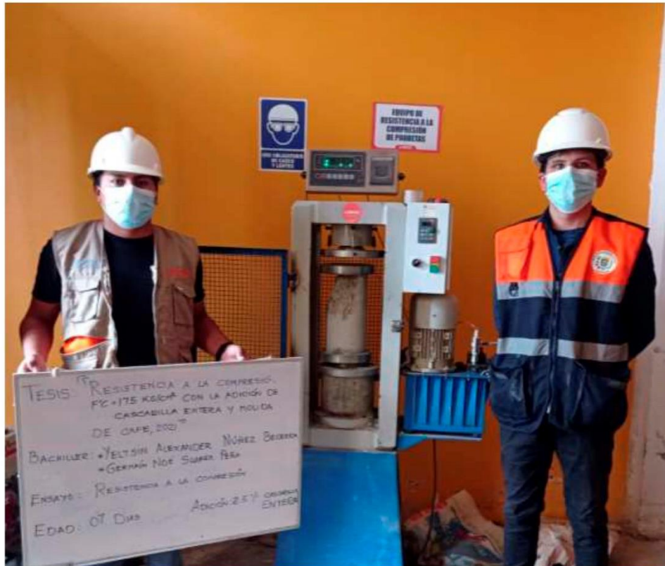
FOTOGRAFÍA 27: Ensayo a compresión de testigos de concreto bajo la norma ASTM C39 de la muestra de concreto con la adición de 2.5 % de cascarilla molida de café a los 14 días del Proyecto tesis: "Resistencia A La Compresión Del Concreto f_c=175 \text{ Kg/Cm}^2 Con La Adición De Cascarilla Entera Y Molida De Café, 2021".
