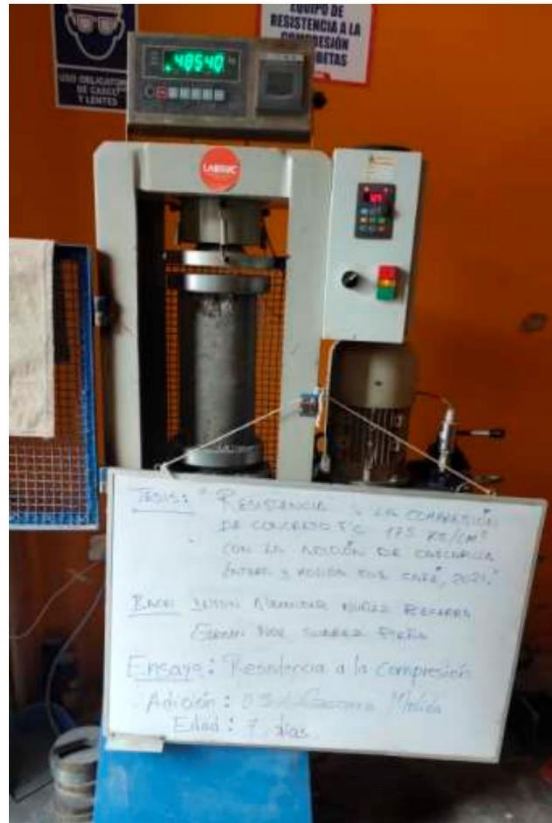
FOTOGRAFÍA 08: Ensayo a compresión de testigos de concreto bajo la norma ASTM C39 de la muestra de concreto con la adición de 0.5 % de cascarilla molida de café a los 7 días del Proyecto tesis: "Resistencia A La Compresión Del Concreto f_c=175 \text{ Kg/Cm}^2 Con La Adición De Cascarilla Entera Y Molida De Café, 2021".
