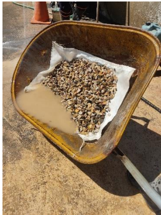
Fotografía N° 66: Lavado del agregado grueso para eliminar partículas
