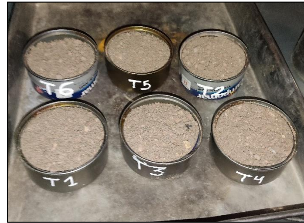
Fotografía N° 7: Muestra seca – después de 24 horas.
