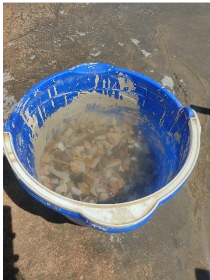
Fotografía N° 68: Agregado grueso seco, reposo en agua por 24 horas.
