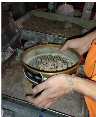
Fotografía N° 52: Material tamizado por la malla N°4
