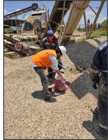
Fotografía N° 2: Obtención del agregado grueso
