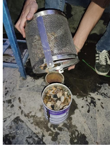
Fotografía N° 73: Retirar el material y secar por 24 horas
