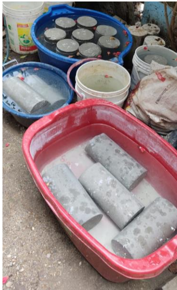
Fotografía N° 79: Curado de probetas
