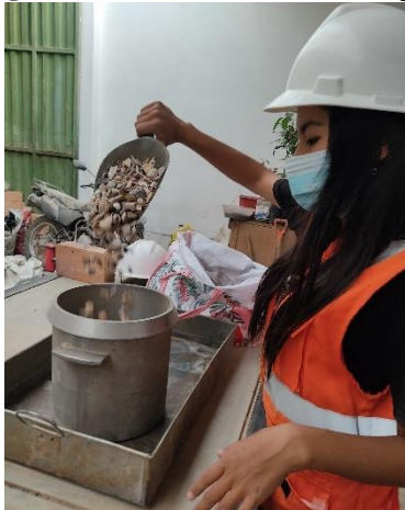
Fotografía N° 31: Añadiendo el agregado grueso al recipiente
