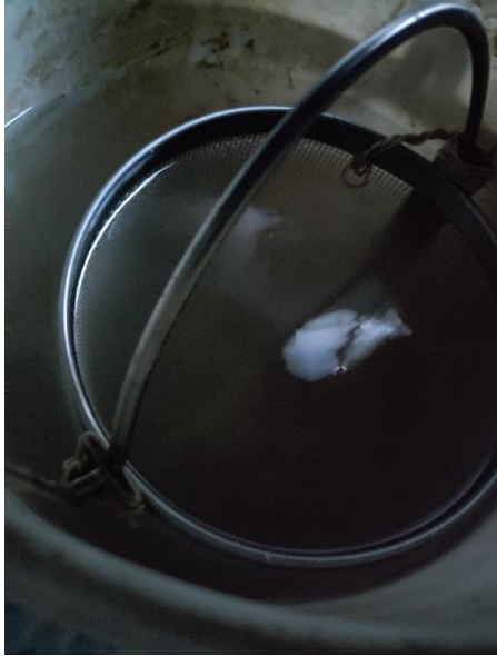
Fotografía N° 72: Canastilla con agregado en agua
