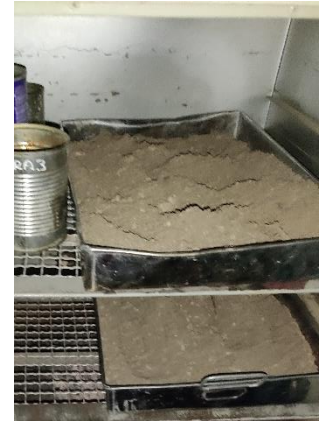
Fotografía N° 35: Agregado fino seco
