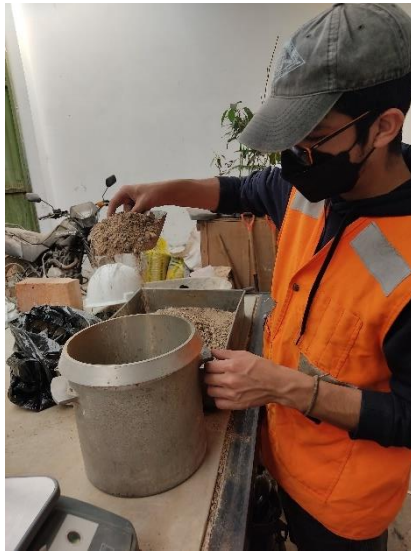
Fotografía N° 36: Agregado el material al recipiente
