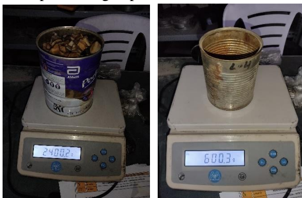
Fotografía N° 68: Agregado grueso seco, reposo en agua por 24 horas.
