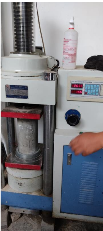
Fotografía N° 82: Probeta sometida a compresión
