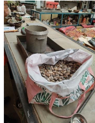
Fotografía N° 30: Agregado grueso seco para el ensayo
