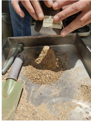
Fotografía N° 60: Material parcialmente saturado.
