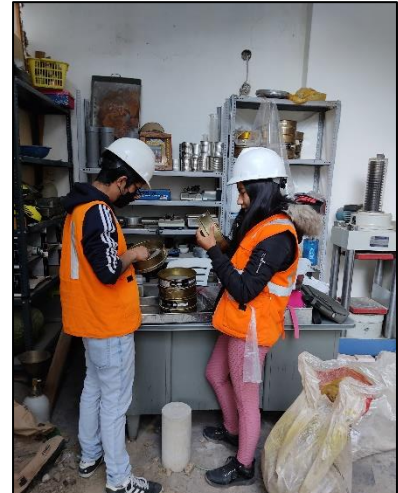
Fotografía N° 16: Limpieza de tamices
