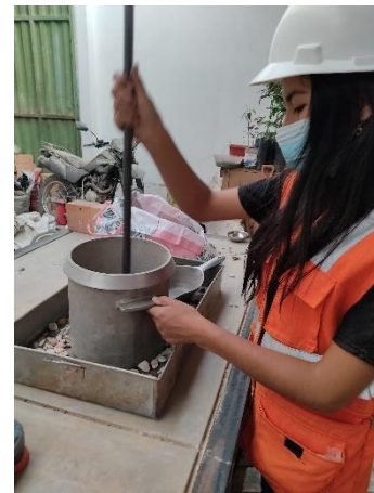
Fotografía N° 44: Agregado grueso seco para el ensayo.
