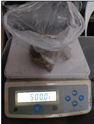
Fotografía N° 15: Peso de agregado fino a ensayar-
