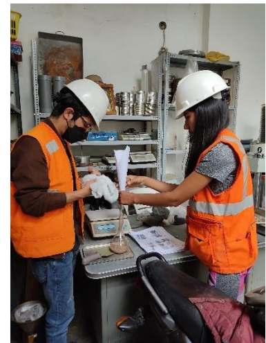
Fotografía N° 63: Adición de material a la fiola con agua
