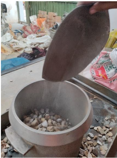
Fotografía N° 45: Agregado seco al recipiente
