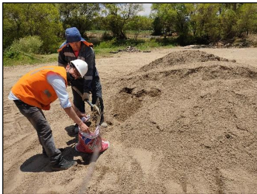
Fotografía N° 3: Obtención del agregado fino.
