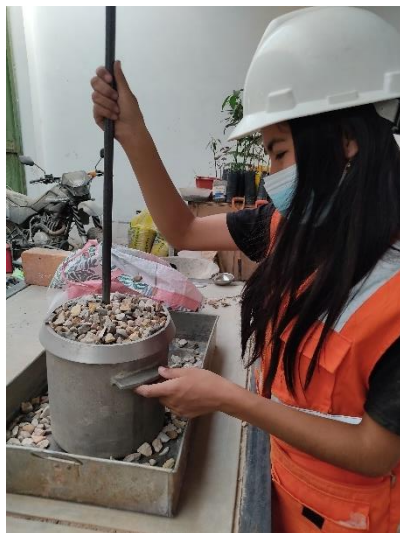
Fotografía N° 47: Compactando última capa
