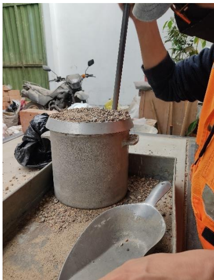
Fotografía N° 38: Compactando con 25 golpes, la tercera capa
