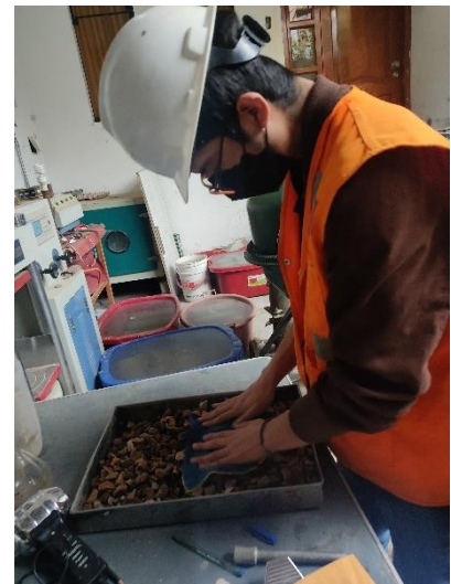
Fotografía N° 69: Secado superficial del material con un paño
