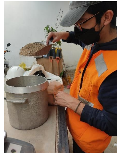
Fotografía N° 22: Añadiendo el agregado fino seco.
