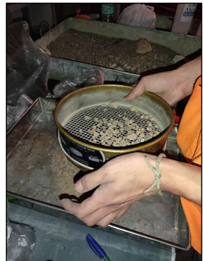
Fotografía N° 18: Tamizando cada malla
