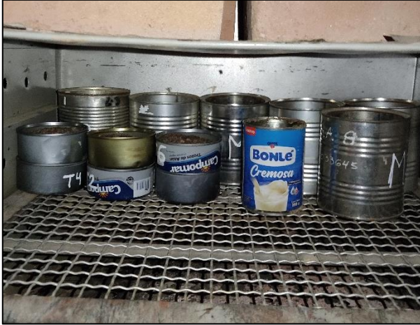
Fotografía N° 10: Taras en el horno por 24 horas
