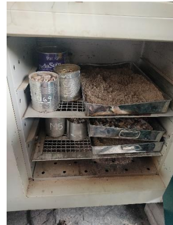
Fotografía N° 67: Secado por 24 horas en el horno a una temperatura de 100°
