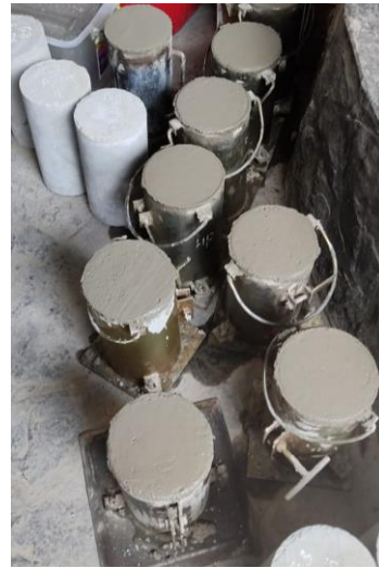
Fotografía N° 78: Probetas en estado fresco
