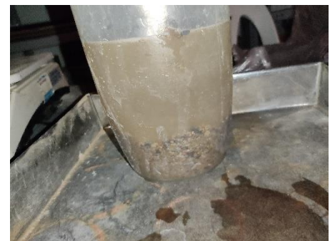
Fotografía N° 53: Reposo de 24 horas en agua
