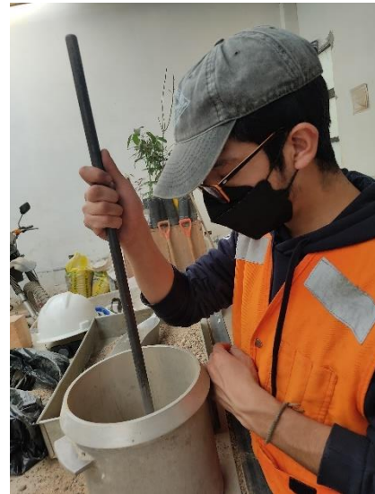
Fotografía N° 37: Compactando con 25 golpes en cada capa.
