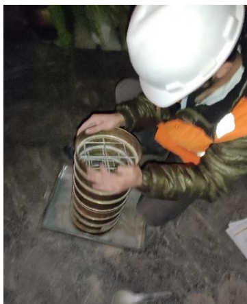
Fotografía N° 13: Tamizando el agregado grueso
