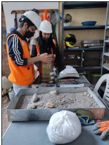
Fotografía N° 17: Tamizando el agregado fino
