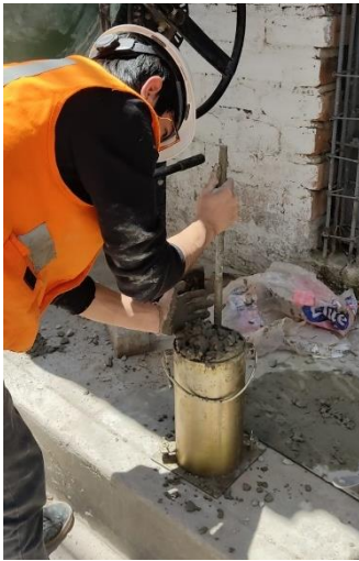
Fotografía N° 77: Llenado y apisonado
