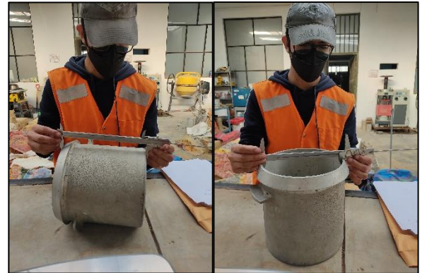
Fotografía N° 20: Toma de medidas, diámetro y altura del recipiente.
