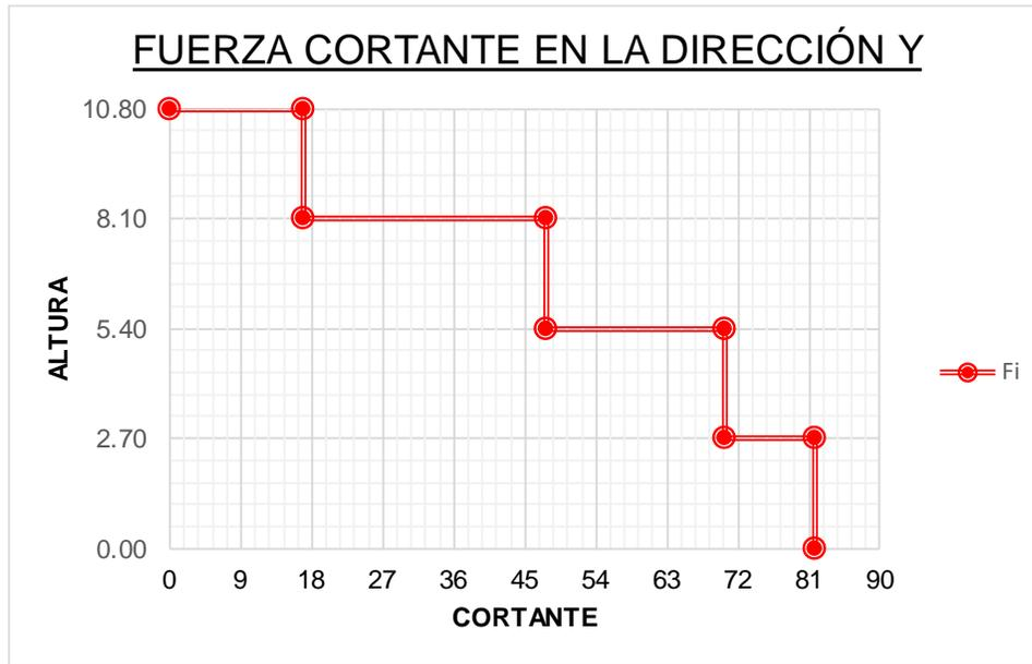
En la Tabla 53 y Figura 27, nos presenta los resultados de la distribución en altura de la cortante basal por el Sismo en Y, esto para determinar la fuerza por piso.
