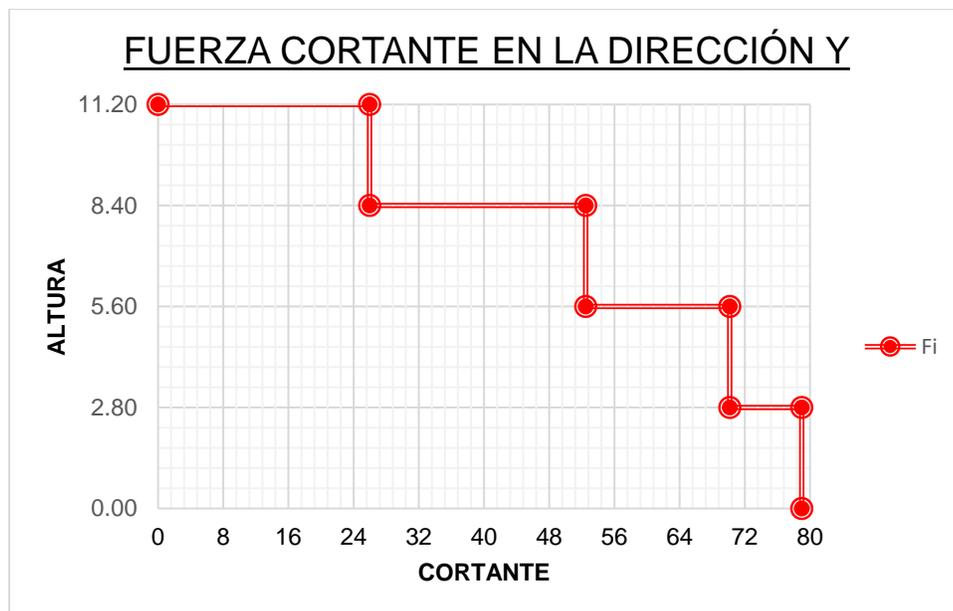
En la Tabla 5 y Figura 17, nos presenta los resultados de la distribución en altura de la cortante basal por el Sismo en Y. Esto para determinar la fuerza por piso.
