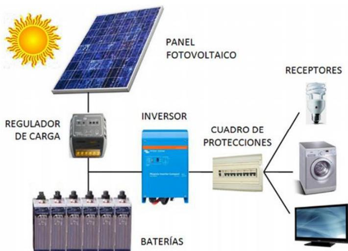
Figura 14. Componentes de un sistema fotovoltaico.
