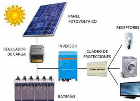
Figura 14. Componentes de un sistema fotovoltaico.
