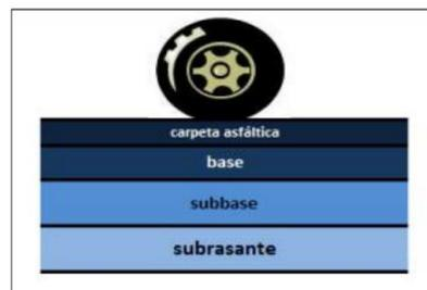
*Figura 2:* Sección típica transversal pavimento flexible
