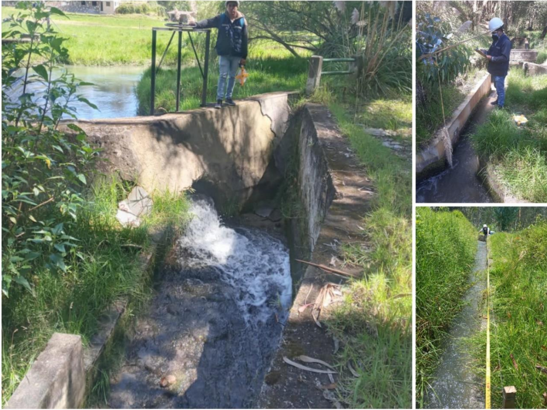
Toma de datos en campo por el método flotador. (KM-00+000)
