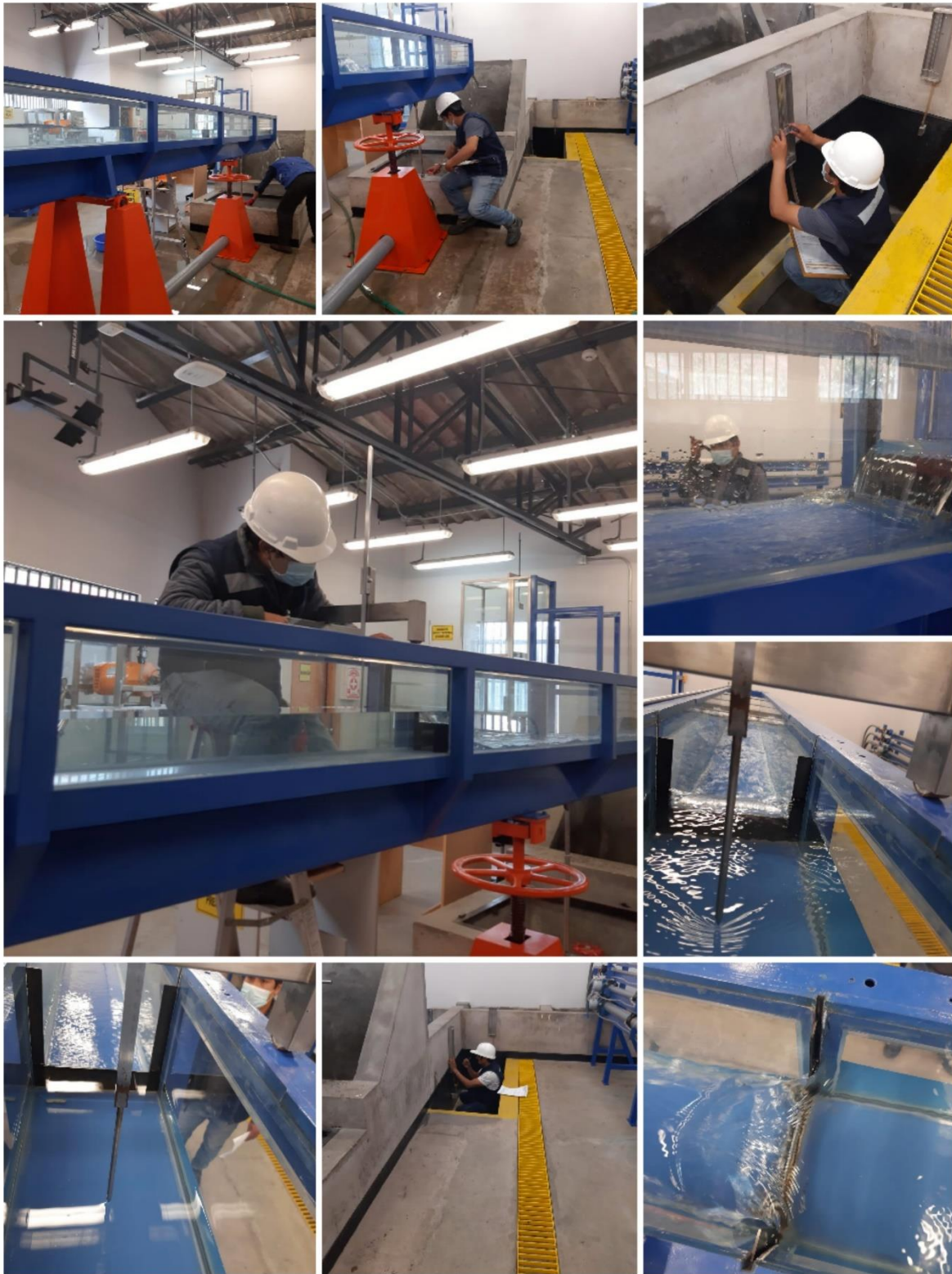
Ensayos para la Calibración de vertedero de pared delgada de sección rectangular. (Laboratorio de hidráulica de Universidad privada del norte)
