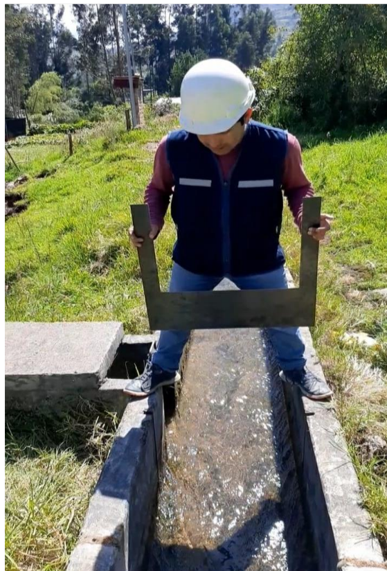
Ilustración 5: Ubicación exacta de la pestaña para incrustar el vertedero.
