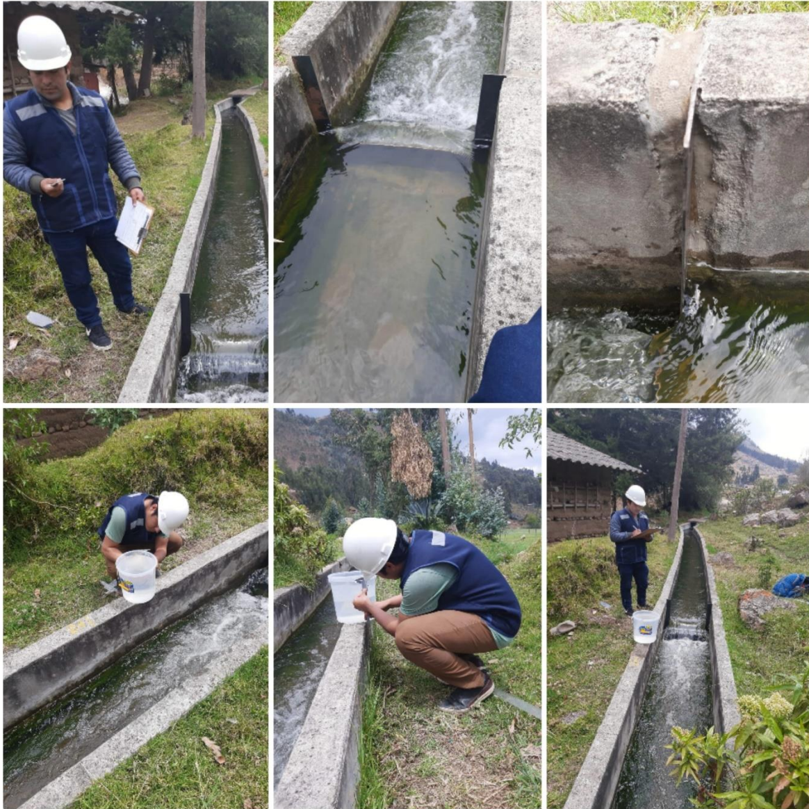
Toma de datos mediante vertedero de sección rectangular (carga hidráulica) KM-02+000 .
