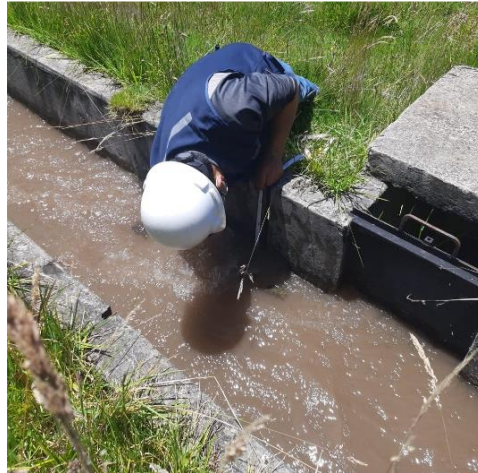
Ilustración 1: Medición de la sección transversal en estudio.
