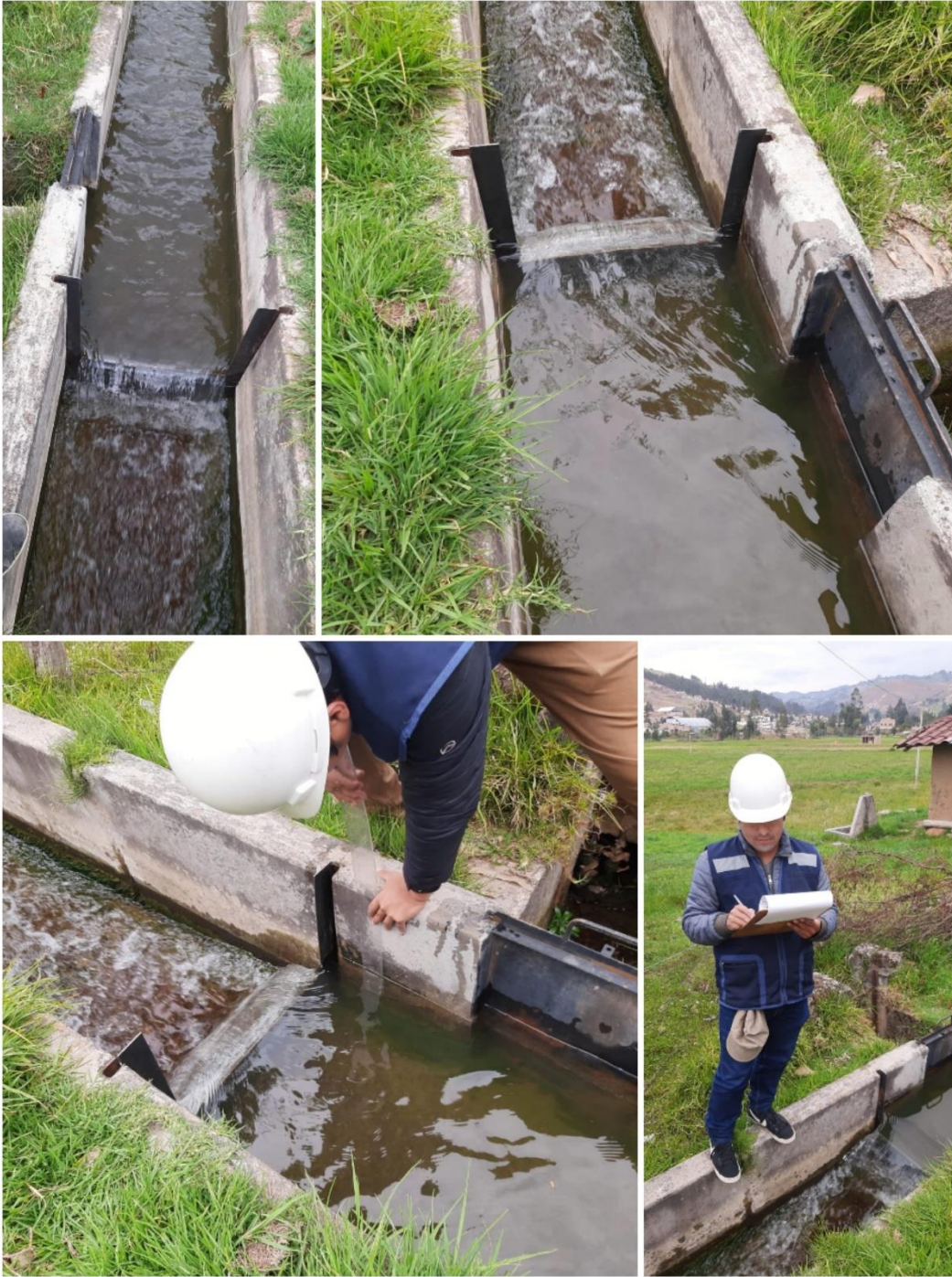
Toma de datos mediante vertedero de sección rectangular (carga hidráulica) KM-05+000 .
