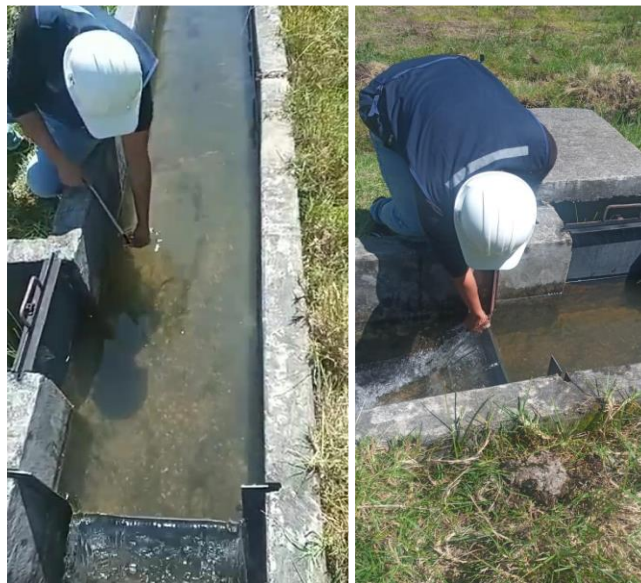
Ilustración 10, 11: Medida desde la base del canal hasta la superficie del flujo.
