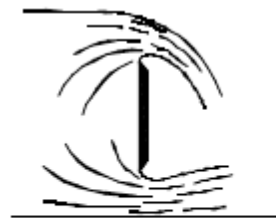
Combinación de orificio y vertedero
