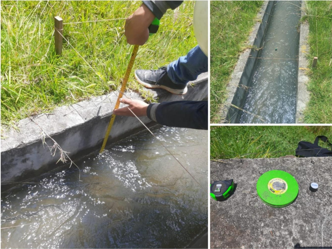
Toma de datos en campo por el método flotador. (KM-03+000)
