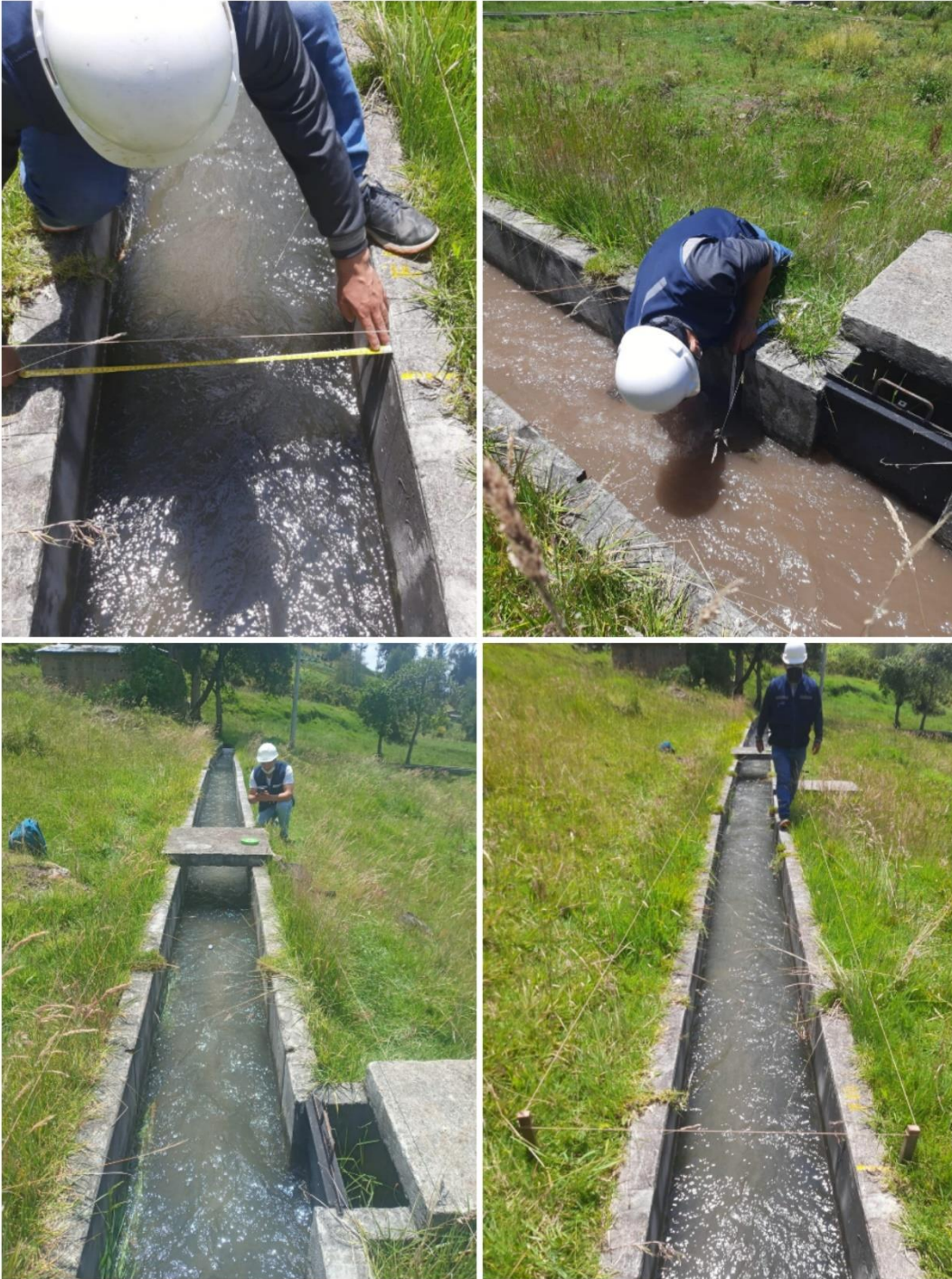
Toma de datos en campo por el método flotador. (KM-01+000)
