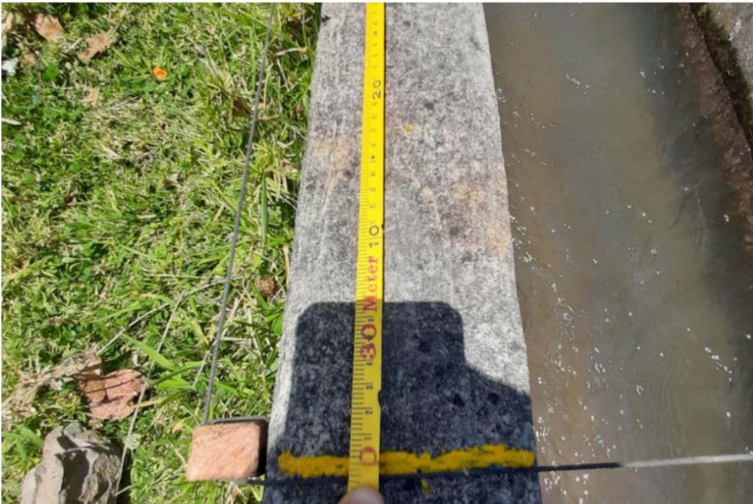
Toma de datos en campo por el método flotador. (KM-04+000)
