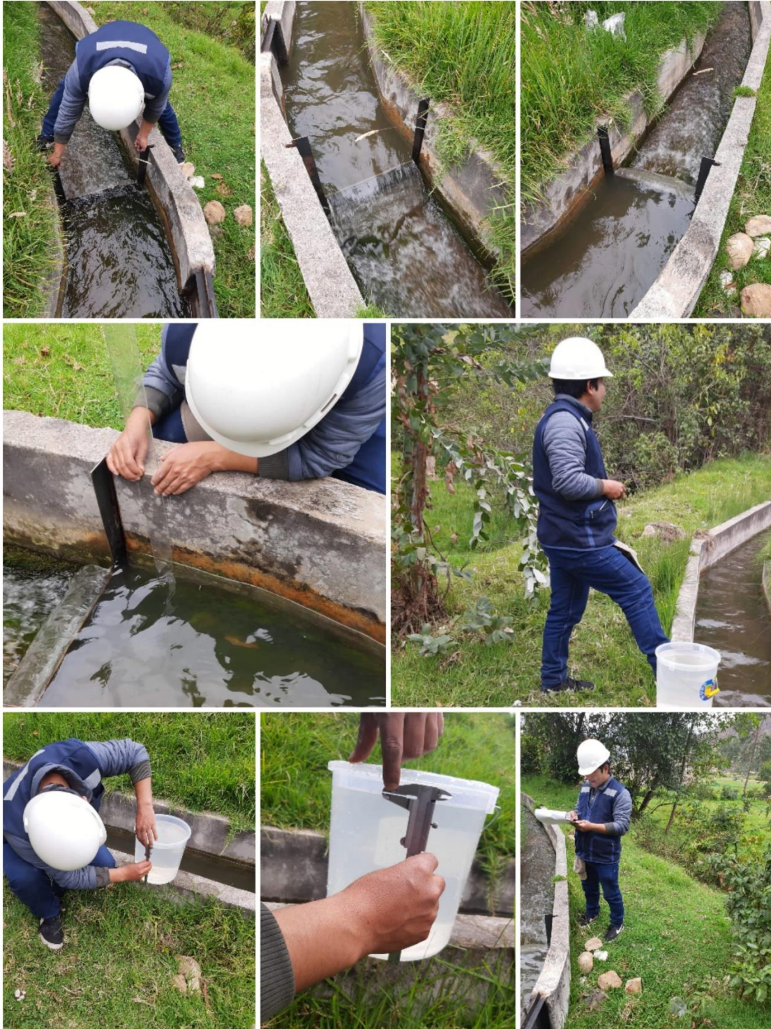
Toma de datos mediante vertedero de sección rectangular (carga hidráulica) KM-00+000.
