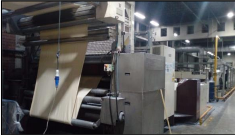
Figura 18. Máquina Rama proceso Termo fijado. Tomado de la empresa textil.
