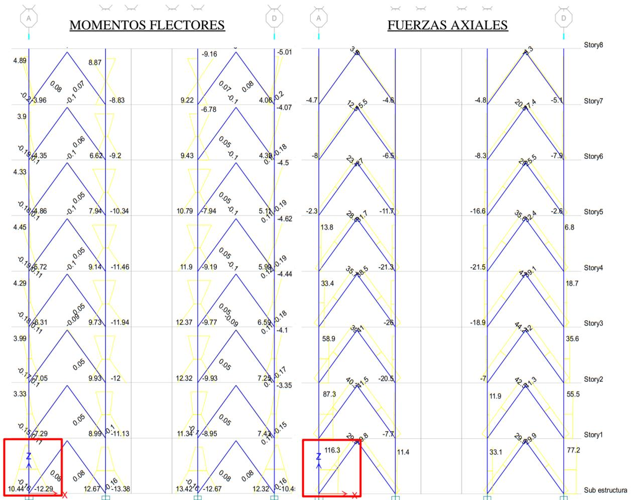
Figura 125: Momentos y axiales de columna más esforzada en estructura de 8 pisos con disipadores
