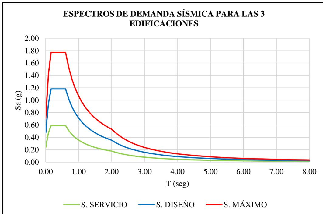
Figura 172: Espectros de demanda sísmica para estructuras de 4, 8 y 16 pisos con aisladores y disipadores
