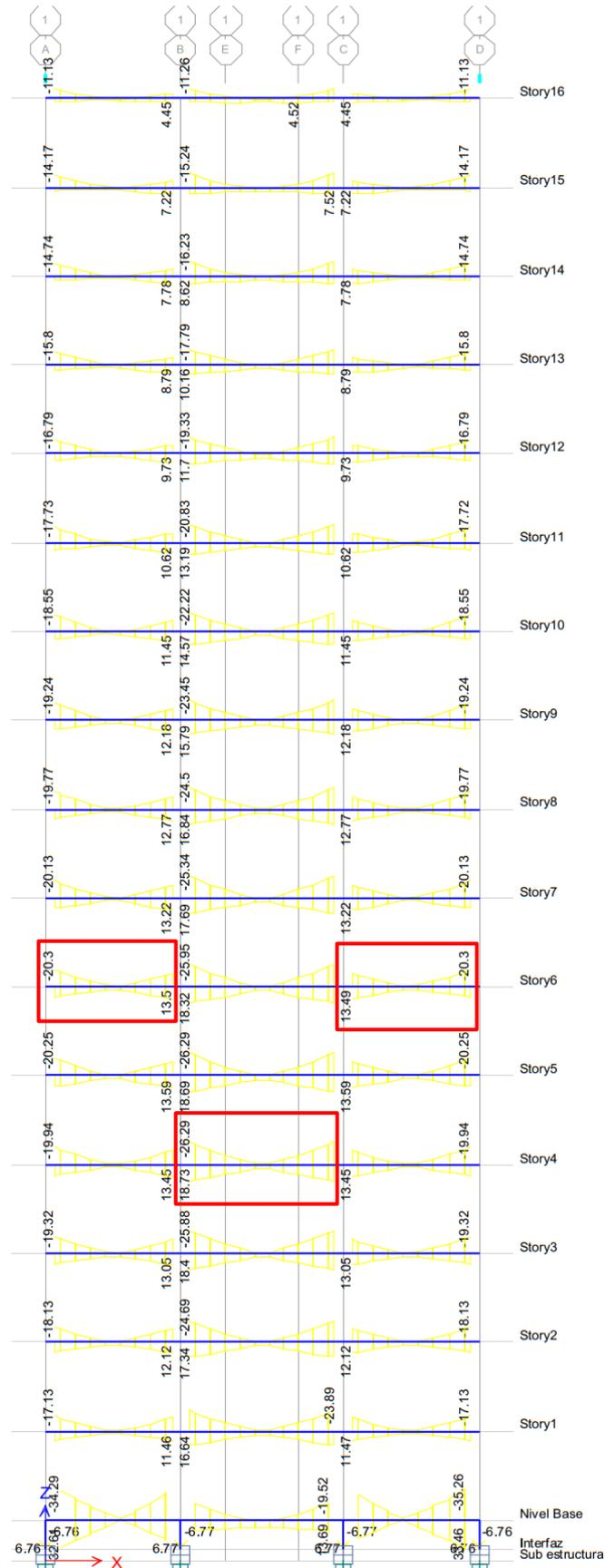
Figura 116: Envoltura de momentos de vigas más solicitadas en la dirección X-X, en estructura de 16 pisos con aisladores.
