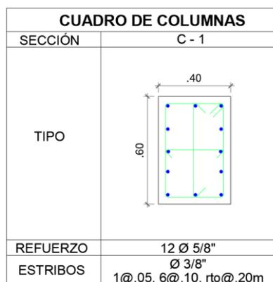
Figura 124: Detalle de acero de refuerzo en columnas de estructura de 4 pisos con disipadores.
