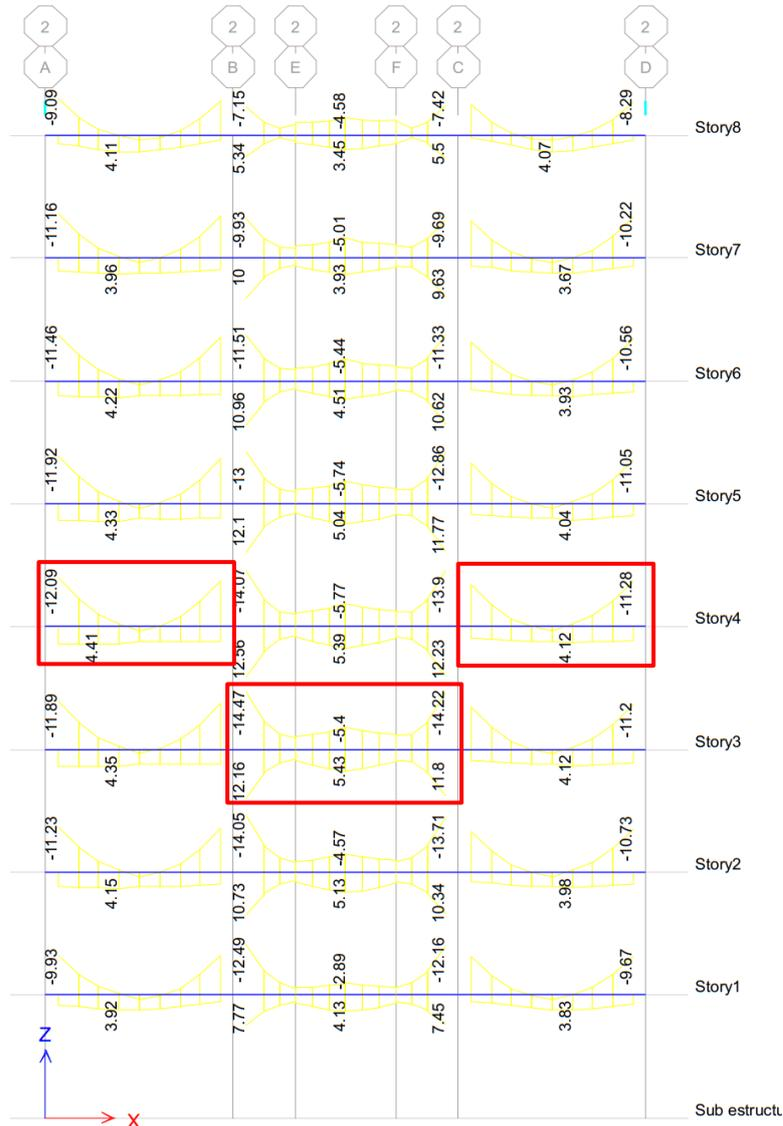
Figura 139: Envolvente de momentos de vigas más solicitadas en la dirección X-X, en estructura de 8 pisos con disipadores.
