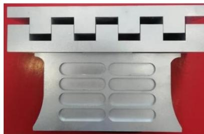
Figura 2: Disipador hysterético tipo SLB. (L. Bozzo, 2019)
