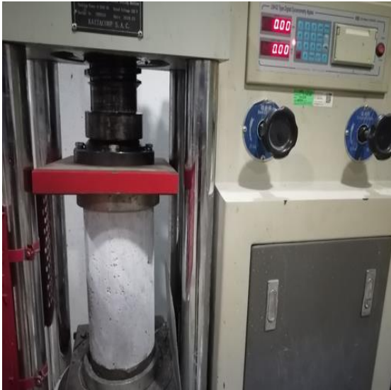
Colocación de probeta para ensayo de Resistencia a la compresión
