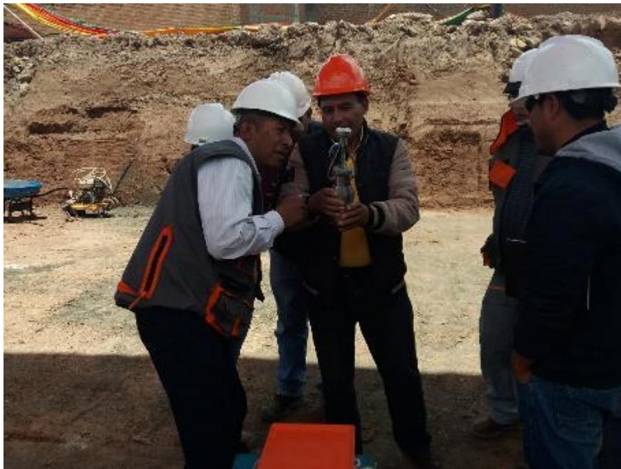
Foto 06: Medidor de humedad con Speedy verificado en campo con Supervisión
