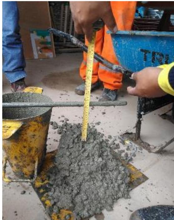
Foto 09: Prueba de Slump a 6" del Concreto Placa del Cerco Perimétrico tramo III (colindante vecino)
