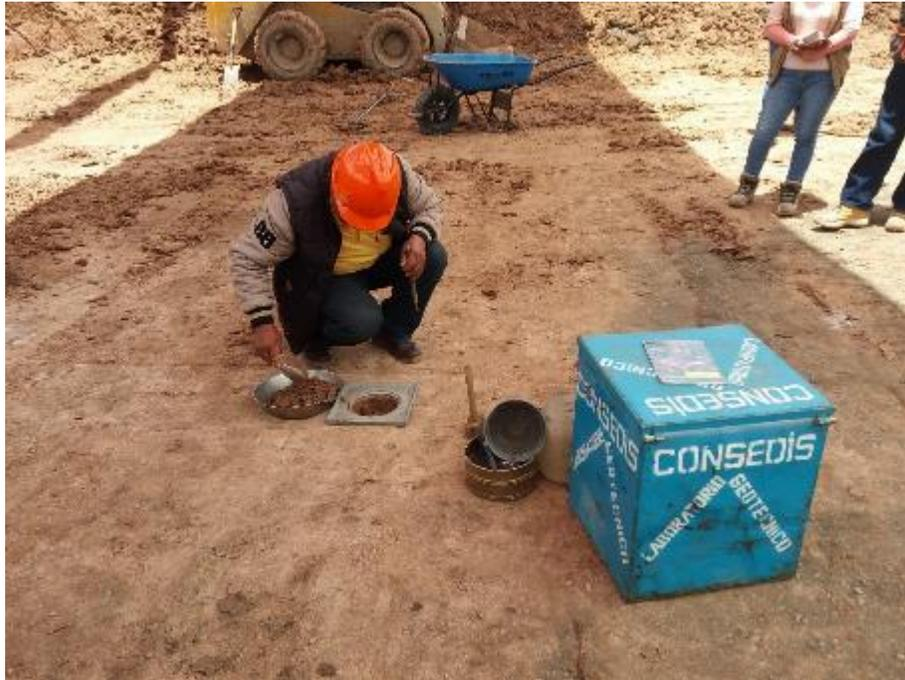
Foto 05: Prueba de densidad de Campo terreno fundación (Pabellón)
