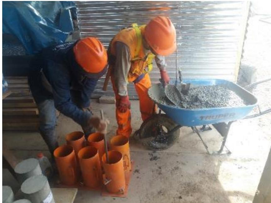
Foto 16: Elaboración de probetas cilíndricas para ensayo de resistencia a compresión en laboratorio
