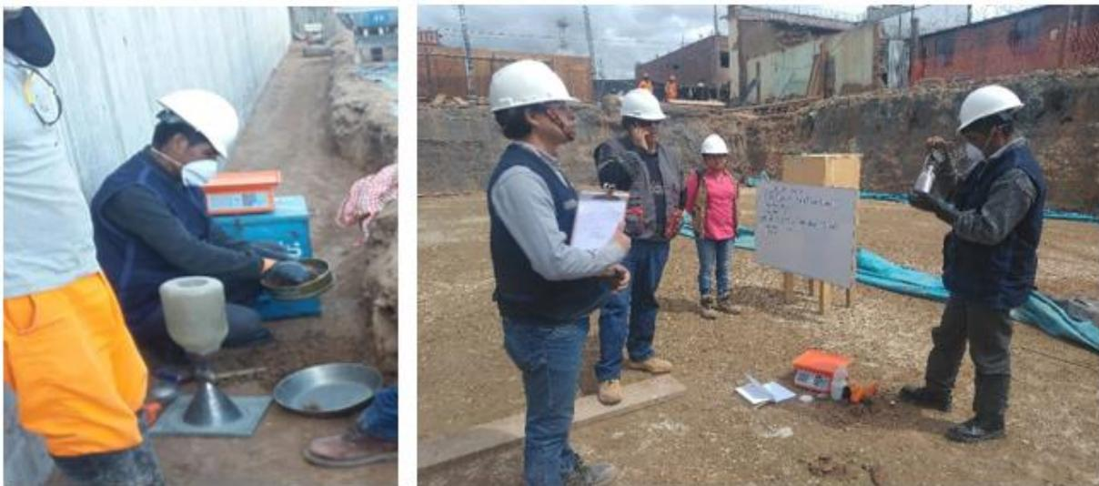
Figura N° 3-5: Determinación del óptimo contenido de humedad por el método de Speedy (ASTM D 4944-98)
