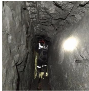
Cajas sin sobre rotura
