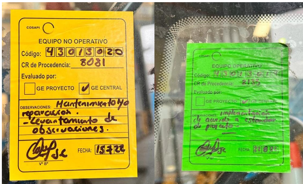
Figura 50 Tarjetas de control aplicadas en equipos del almacén central
