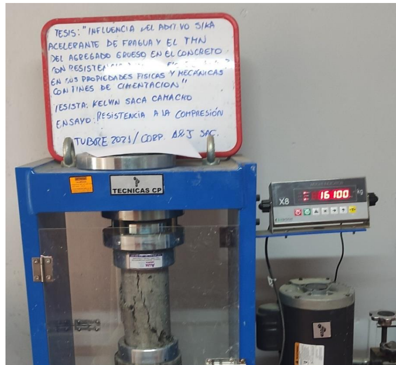
Figura 17. Resistencia a Compresión de Probeta cilíndrica a edad de 7 días para mezcla de piedra de 3/4" sin aditivo con f'c prom= 207.63 kg/cm 2
