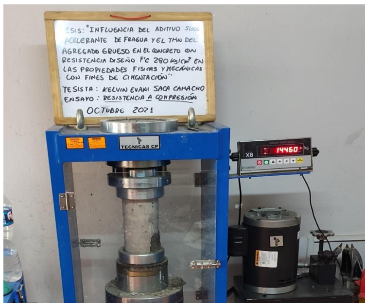
Figura 15. Resistencia a Compresión de Probeta cilíndrica a edad de 3 días para mezcla de piedra de 3/4" sin aditivo, con f_c prom= 182.26kg/cm 2
