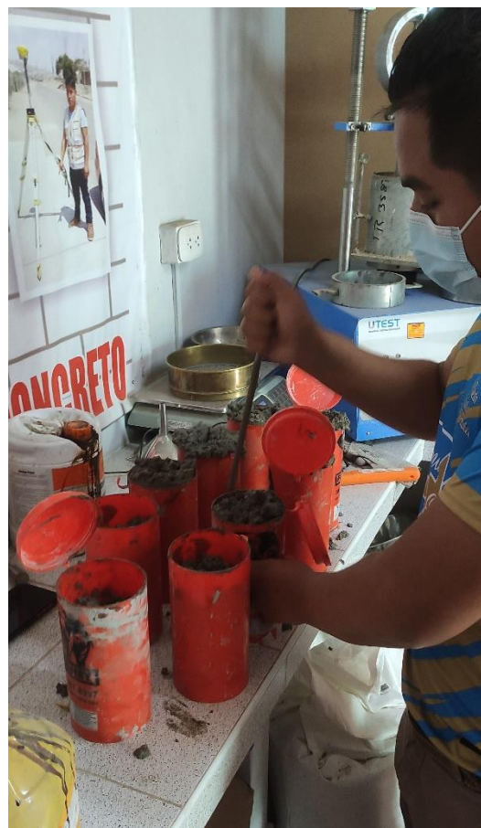
Figura 14. Elaboración de Probetas Cilíndricas de Concreto
