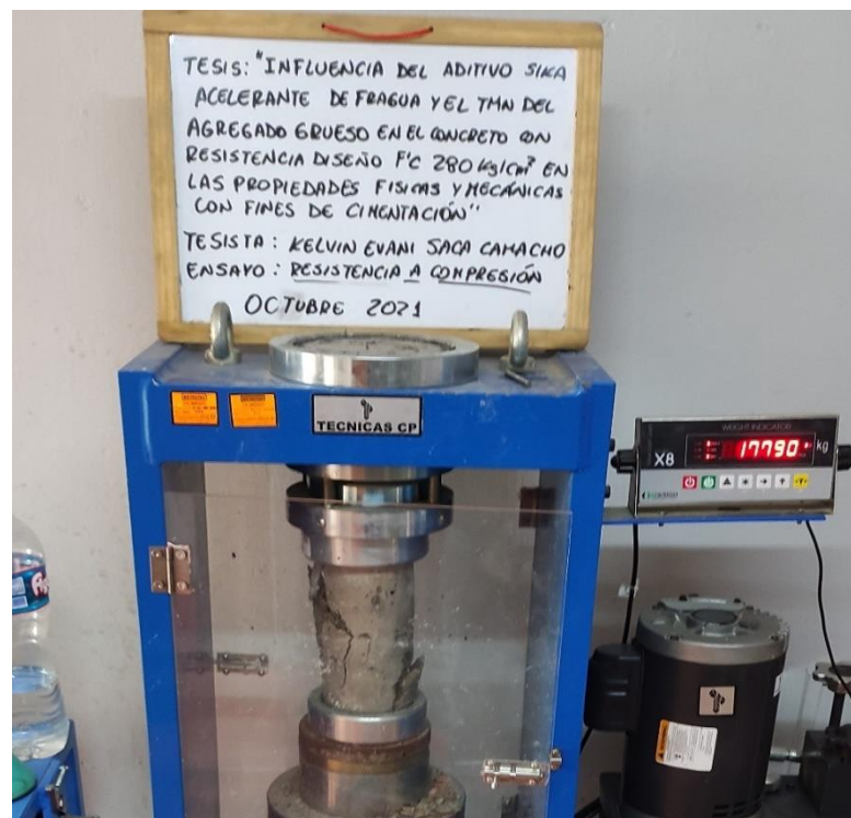
Figura 20. Resistencia a Compresión de Probeta cilíndrica a edad de 7 días para mezcla de piedra de 1/2'' sin aditivo con f'c prom= 222.86 kg/cm^2
