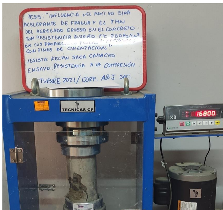
Figura 16. Resistencia a Compresión de Probeta cilíndrica a edad de 3 días para mezcla de piedra de 3/4" con aditivo al 1%, con f_c prom= 212.13kg/cm 2
