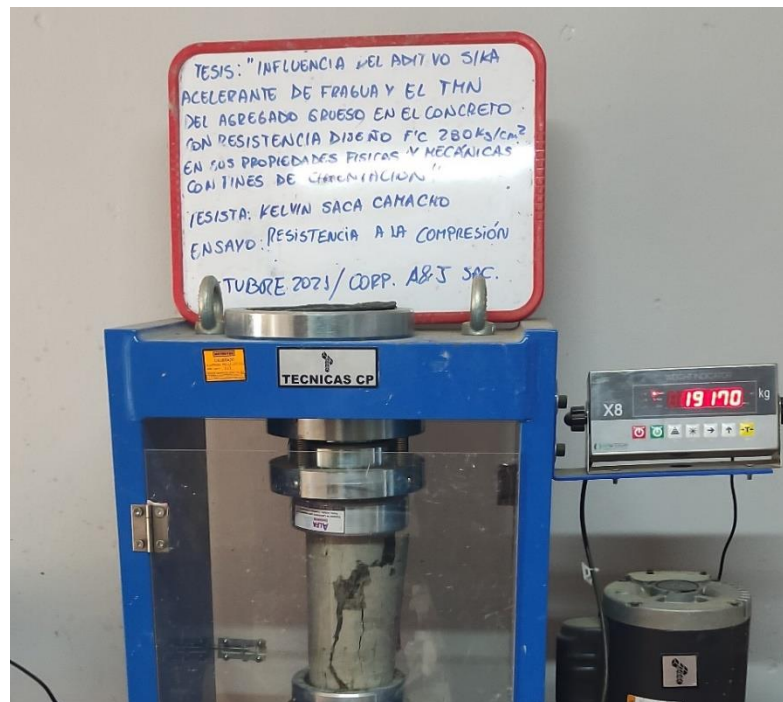
Figura 18. Resistencia a Compresión de Probeta cilíndrica a edad de 7 días para mezcla de piedra de 3/4" con aditivo al 1.0% con f'c prom= 241.81 kg/cm 2
