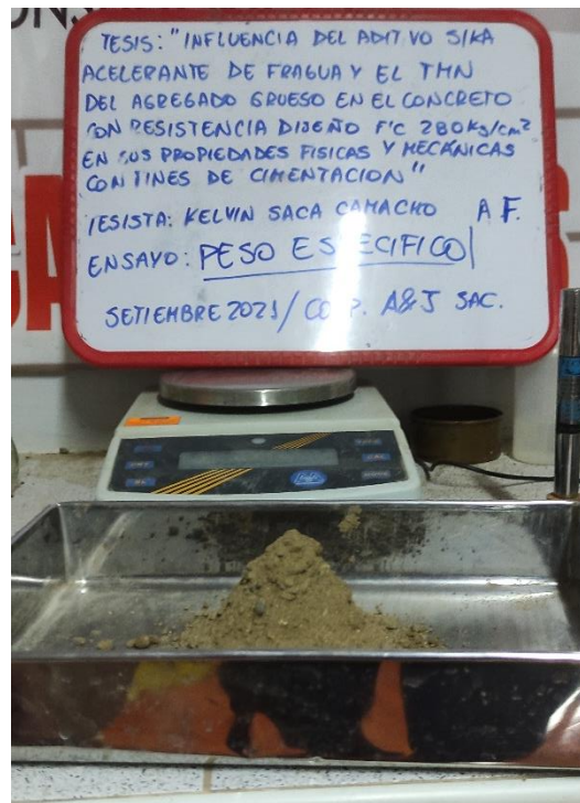
Figura 9. Corroboración de condición SSS de agregado fino para ensayo de Peso Específico.
