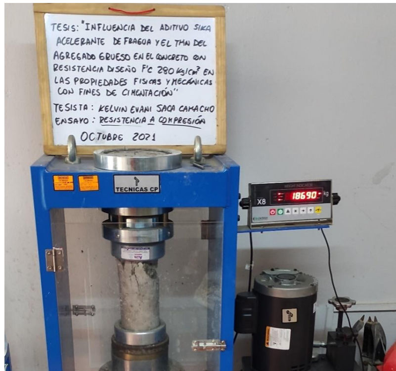
Figura 19. Resistencia a Compresión de Probeta cilíndrica a edad de 7 días para mezcla de piedra de 3/4'' con aditivo al 2.5% con f'c prom= 229.75 kg/cm^2
