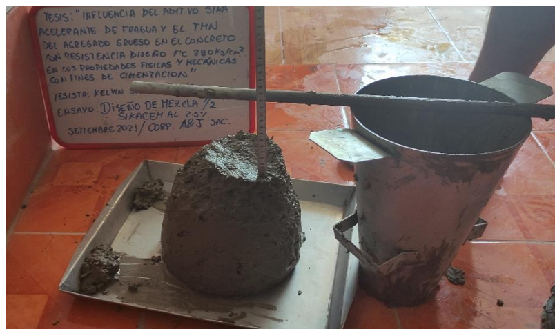
Figura 12. Ensayo de Asentamiento para Concreto para Sikacem 2.5%
