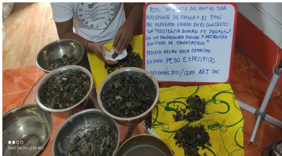
Figura 8. Muestra de agregado grueso para ensayo de Peso Específico.
