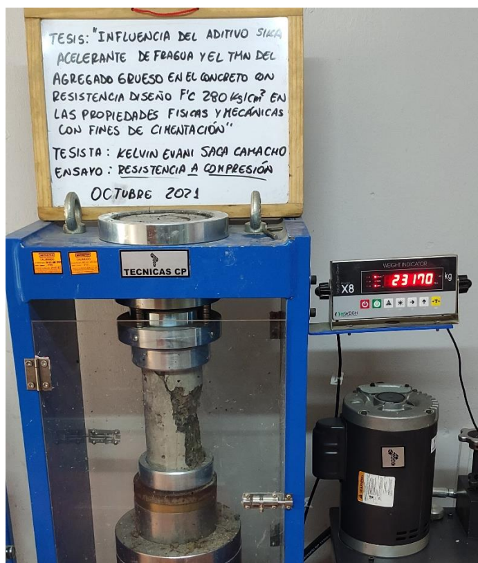
Figura 22. Resistencia a Compresión de Probeta cilíndrica a edad de 28 días para mezcla de piedra de \frac{3}{4} " con aditivo al 1% con f'c prom= 293.65 kg/cm^2
