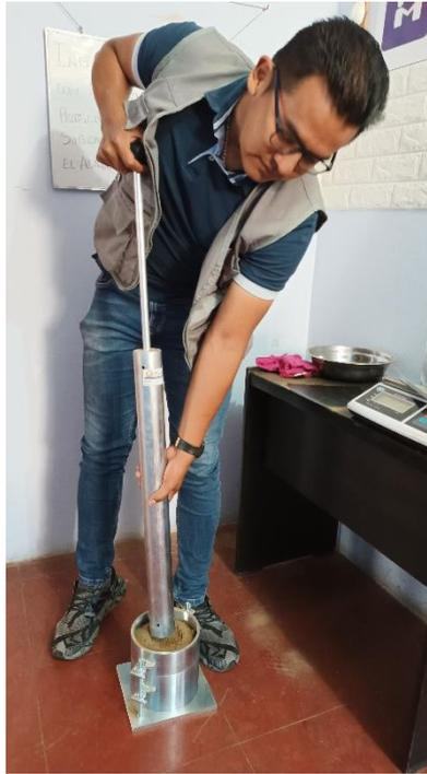
Fotografía 11. Ensayo de proctor
