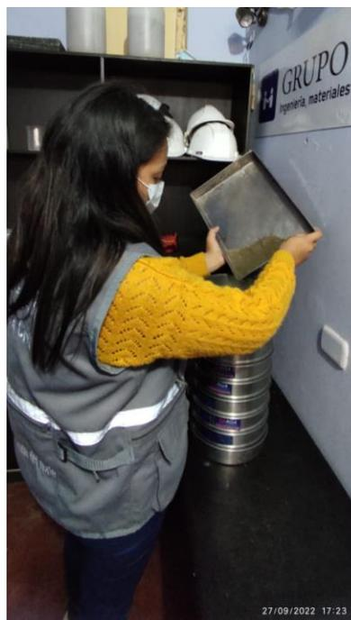
Fotografía 2. Agregando la muestra – ensayo de granulometría
