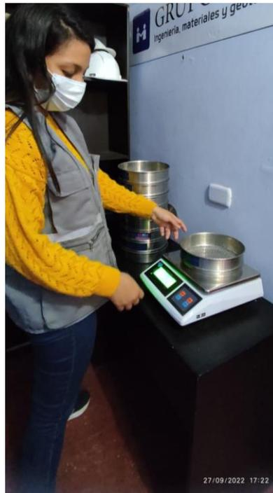
Fotografía 1. Pesado de malla – ensayo de granulometría
