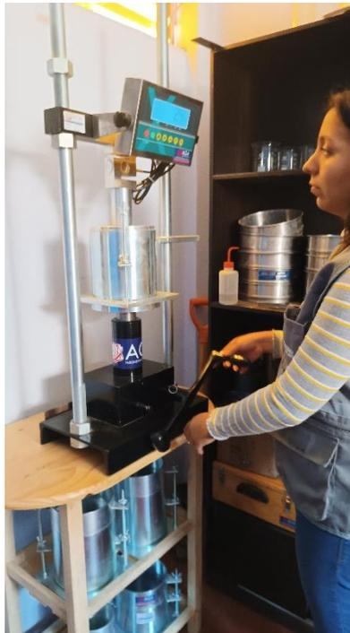
Fotografía 12. Ensayo de CBR
