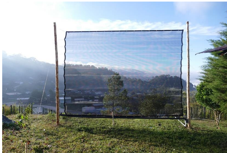
Captador de malla raschel con estructura de madera
