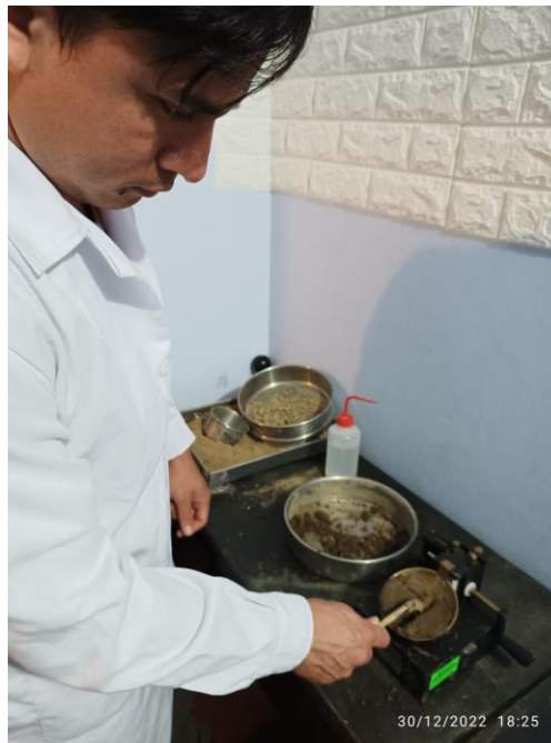
FOTOGRAFÍA 8: Ensayo de límites de consistencia – ensayo de límite líquido en cuchara de casagrande
