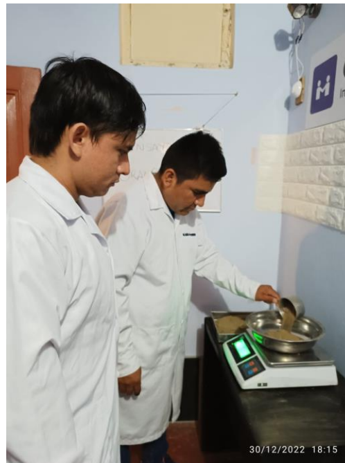
FOTOGRAFÍA 2: Ensayo de granulometría – pesado de muestra
