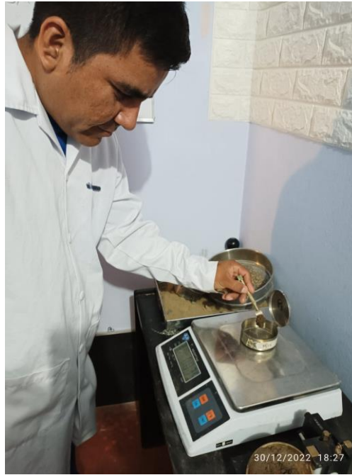
FOTOGRAFÍA 9: Ensayo de límites de consistencia – pesado de muestra con recipiente del límite líquido
