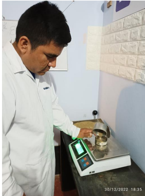
FOTOGRAFÍA 13: Ensayo de contenido de humedad
