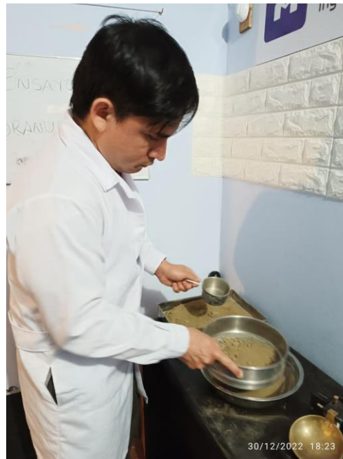
FOTOGRAFÍA 6: Ensayo de límites de consistencia - tamizado de material por la malla 10
