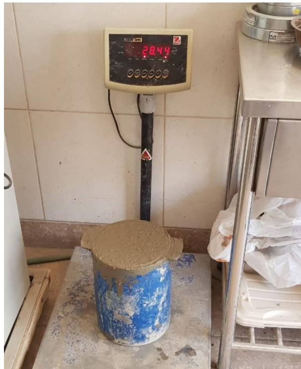
Figura 76: Se pesa el recipiente con el concreto compactado.
