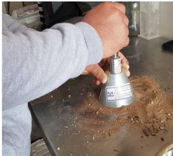
Figura 49: Haciendo la última capa del apisonado del agregado fino.
