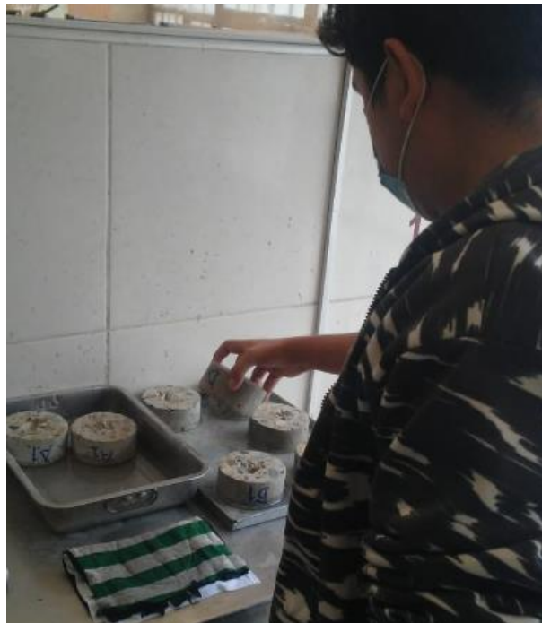
Figura 113: Se realiza su respectivo ensayo de succión capilar.
