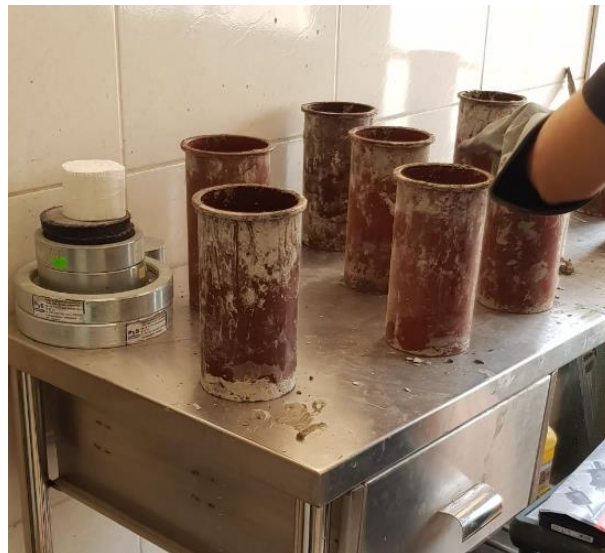
Figura 85: Se realiza el llenado de concreto a las probetas cilíndricas.
