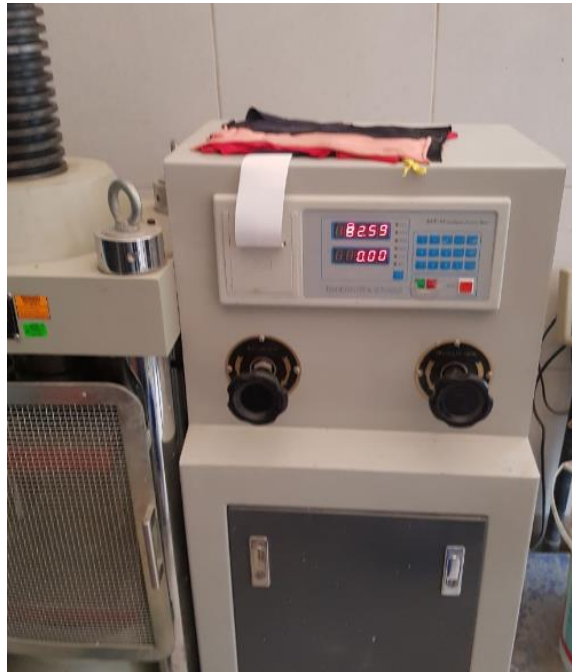
Figura 104: Se realiza la toma de datos del ensayo de resistencia a la compresión.
