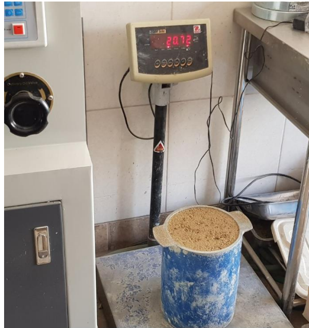
Figura 28: Determinando el peso suelto del agregado fino.
