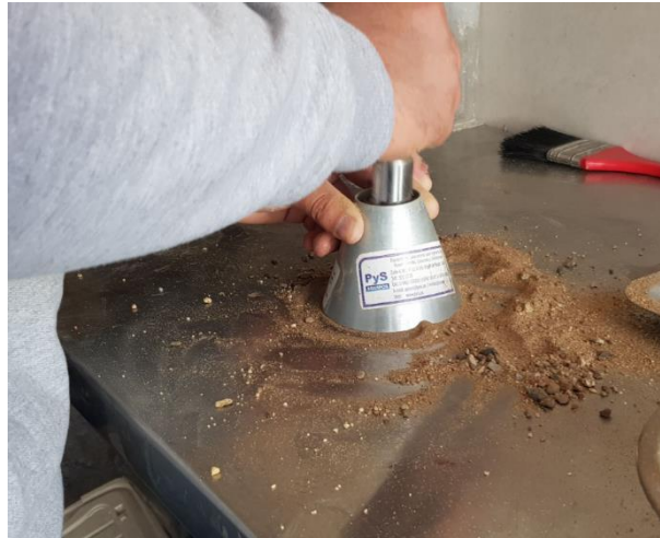
Figura 48: Haciendo la primera capa del apisonado del agregado fino.
