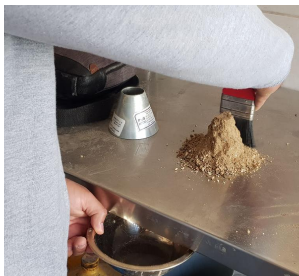
Figura 53: Recogiendo la muestra en el recipiente y realizar su pesado respectivo.
