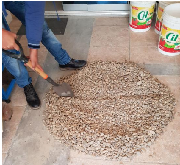
Figura 14: El cuarteo correspondiente de los agregados.
