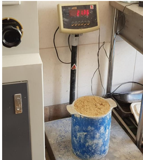
Figura 29: Determinando el peso compactado del agregado fino.
