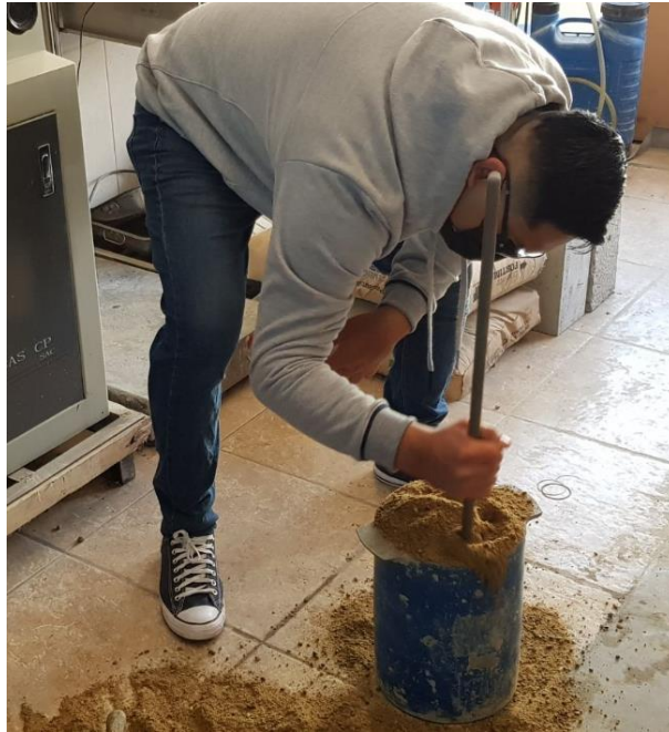
Figura 26: El último chuceado del agregado fino.
