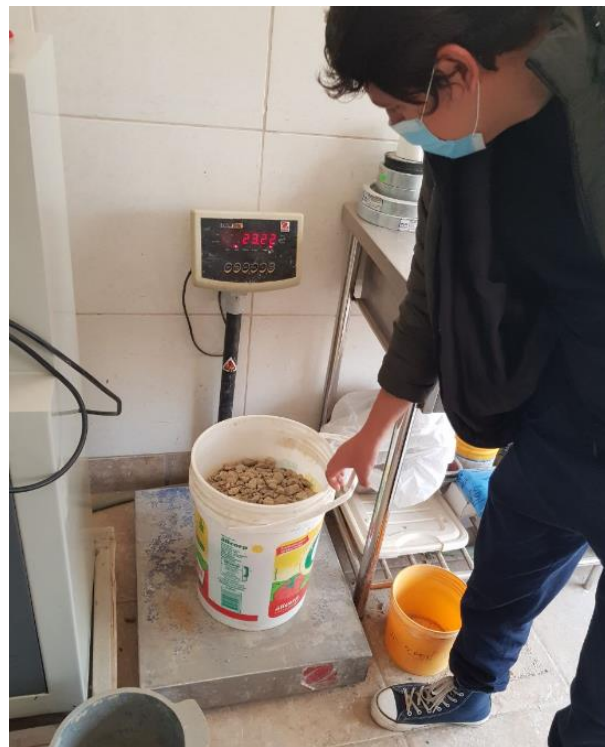
Figura 67: Obteniendo la cantidad agregado grueso requerida para el diseño de mezcla.
