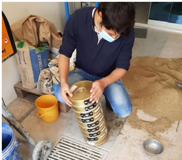
Figura 39: Realizando los movimientos para el análisis granulométrico del agregado fino.
