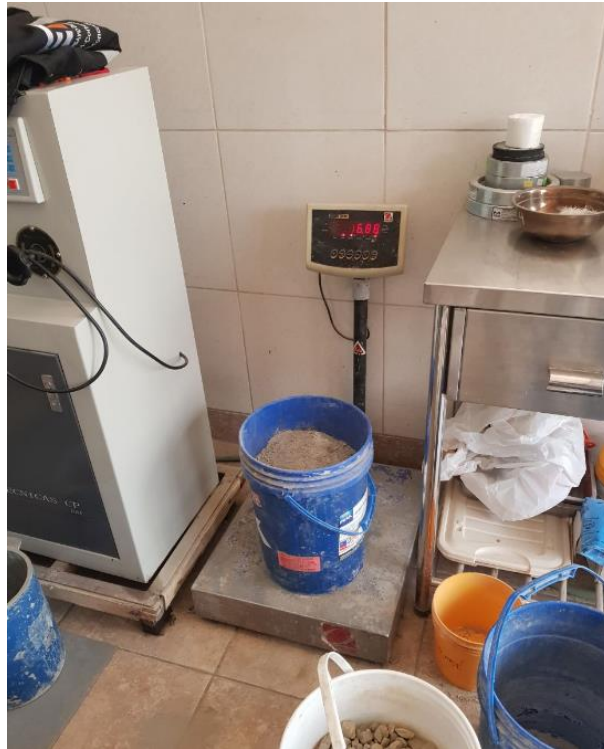
Figura 66: Obteniendo la cantidad cemento requerida para el diseño de mezcla.
