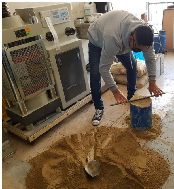
Figura 27: El enrasado del agregado fino.
