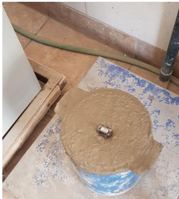
Figura 77: Se obtiene la temperatura del concreto para cada diseño de mezcla.
