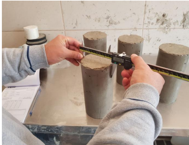
Figura 100: Se realiza toma de datos, las medidas del diámetro.
