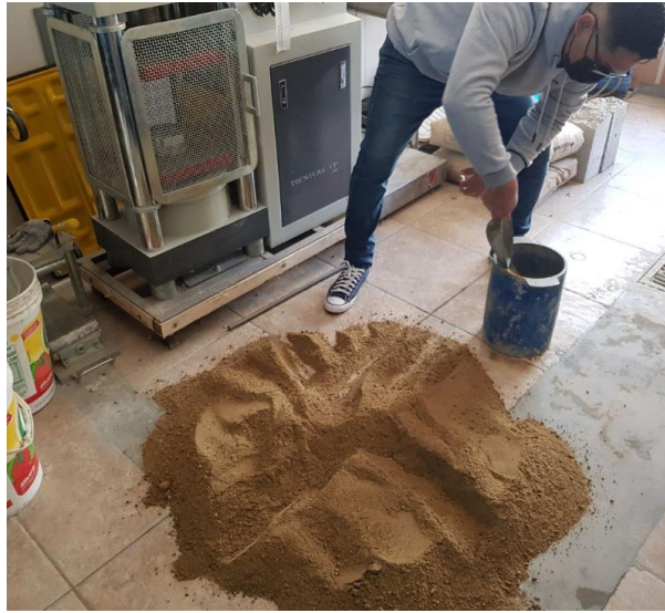
Figura 24: Llenando el recipiente para hacer el chuceado del agregado fino.
