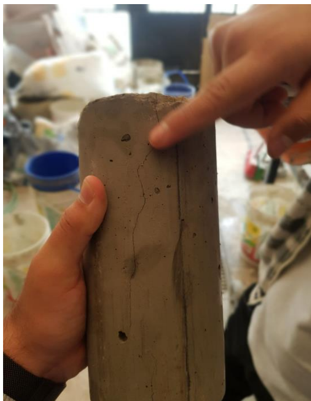
Figura 109: Se observa la rotura de la probeta, ensayo de la resistencia a la tracción.
