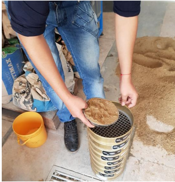
Figura 38: Preparando para realizar los movimientos para el análisis granulométrico del agregado fino.
