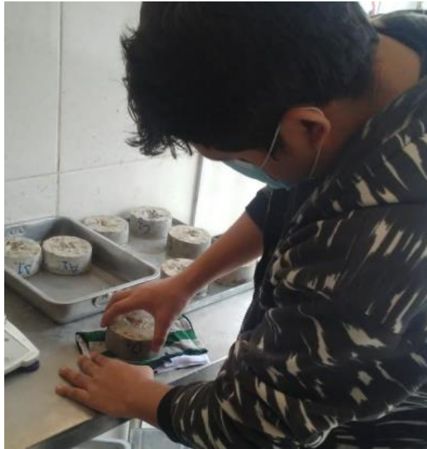
Figura 114: Se realiza su respectivo secado superficial en la base de la muestra.
