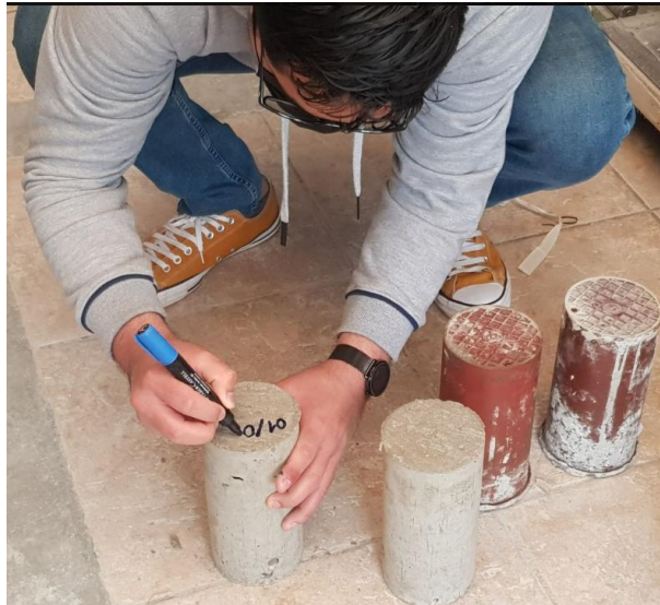
Figura 96: Se va identificando a la cada probeta con su respectivo nombre.
