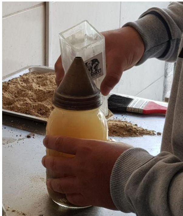
Figura 58: Una vez colocado la tapa, acabar de llenar el resto del recipiente hasta la parte superior de la tapa.
