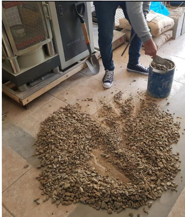
Figura 20: Llenando el recipiente para el último chuceado del agregado grueso.
