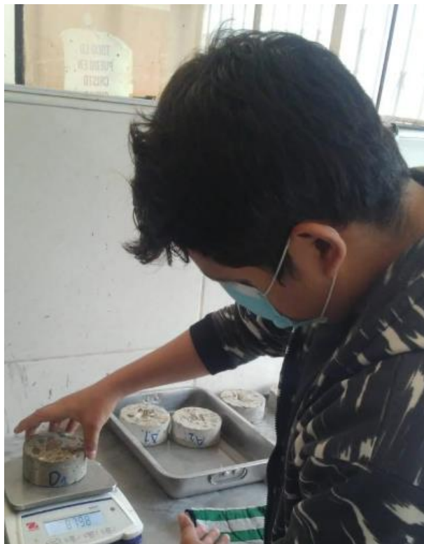
Figura 115: Se realiza su respectivo pesado de las muestras, se hace cada cierto periodo de tiempo.
