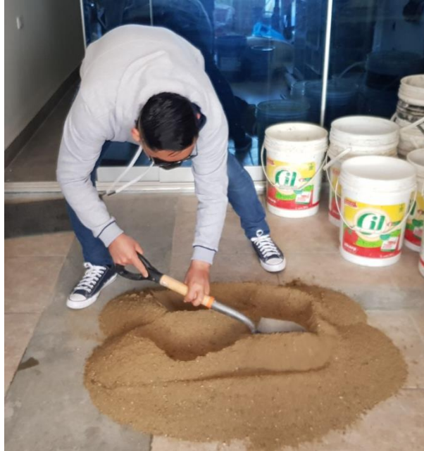
Figura 16: El cuarteo del agregado fino.
