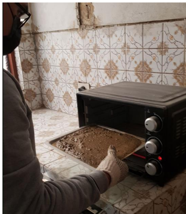
Figura 41: La muestra del agregado fino en el horno durante las 24 horas.
