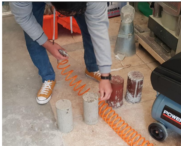
Figura 94: Se realiza el desencofrado de las probetas de succión capilar.
