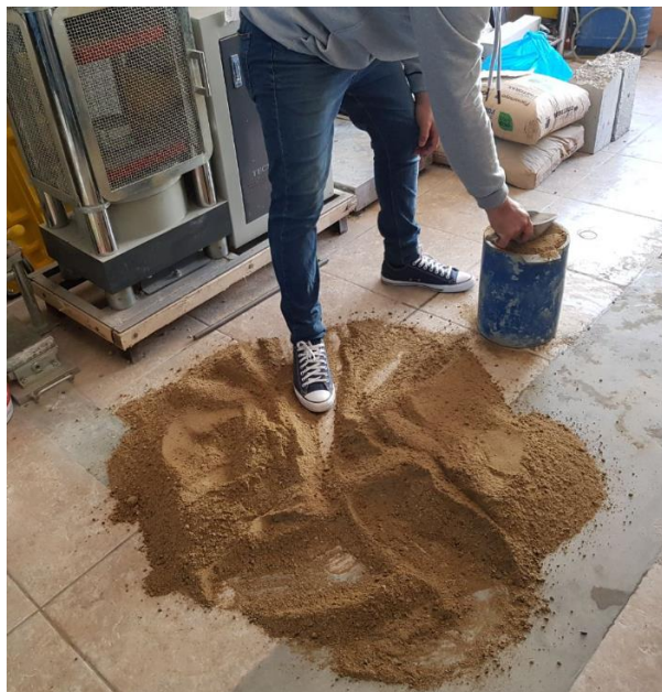
Figura 25: Llenando el recipiente para hacer el último chuceado del agregado fino.
