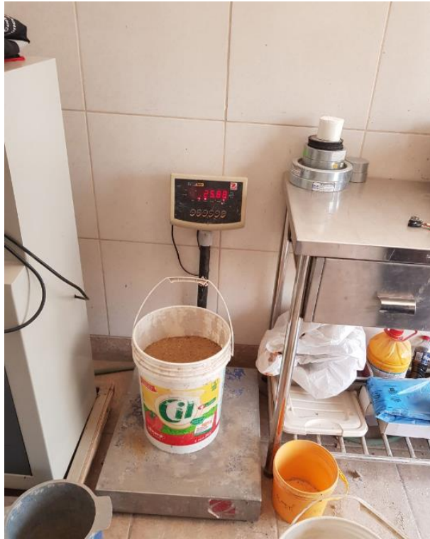
Figura 68: Obteniendo la cantidad agregado fino requerida para el diseño de mezcla.
