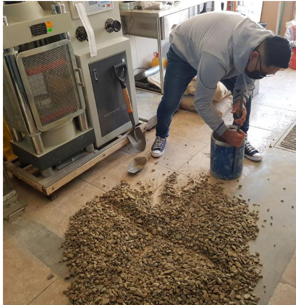
Figura 18: Preparando la medida para el primer chuceado del agregado grueso.
