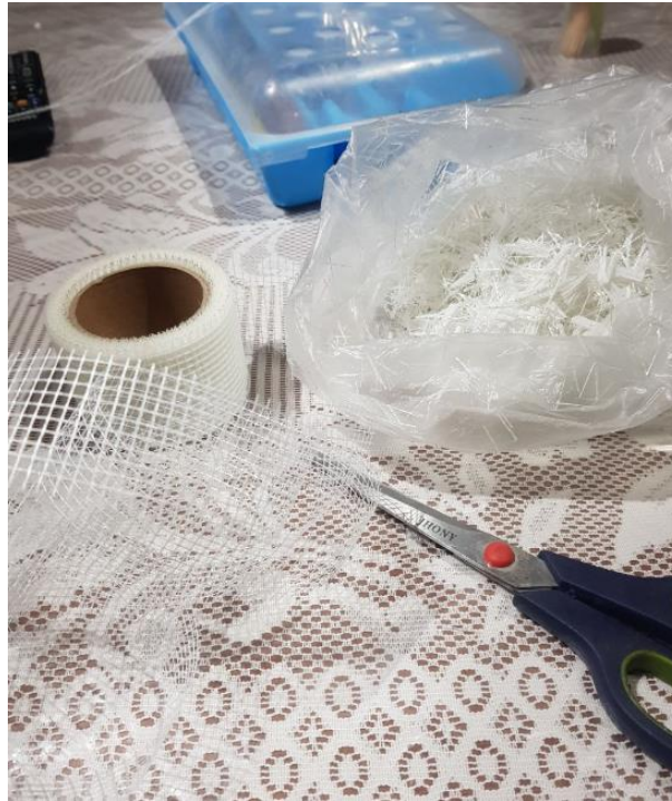
Figura 60: Como la fibra de vidrio viene en forma de cinta, se tuvo que recortar por tiras de 12 mm.
