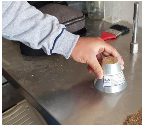
Figura 51: Haciendo la limpieza de la zona para observar el resultado del apisonado.
