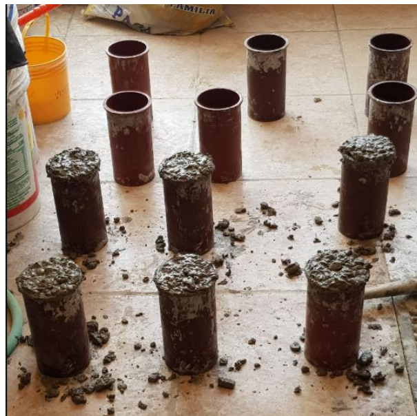
Figura 87: Se realiza la última capa de llenado de concreto para las probetas cilíndricas.
