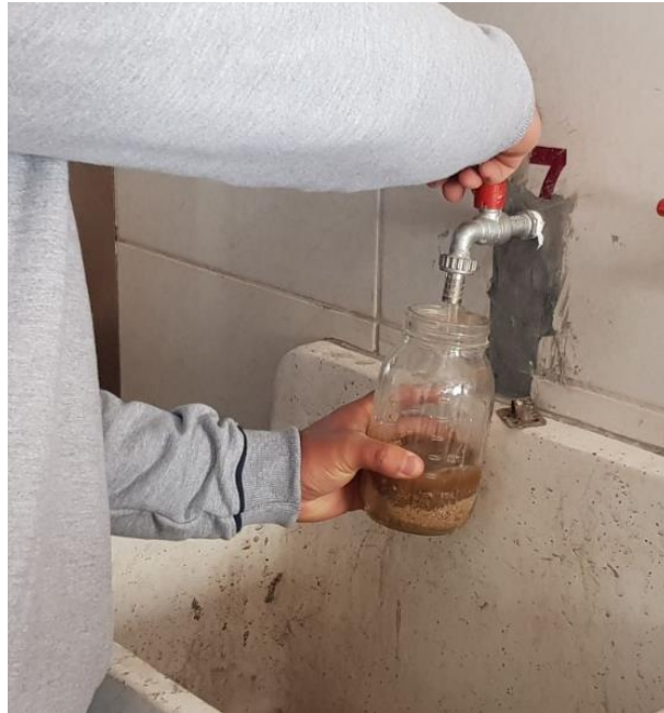
Figura 56: Llenar el pignómetro con la muestra del agregado fino más el agua.
