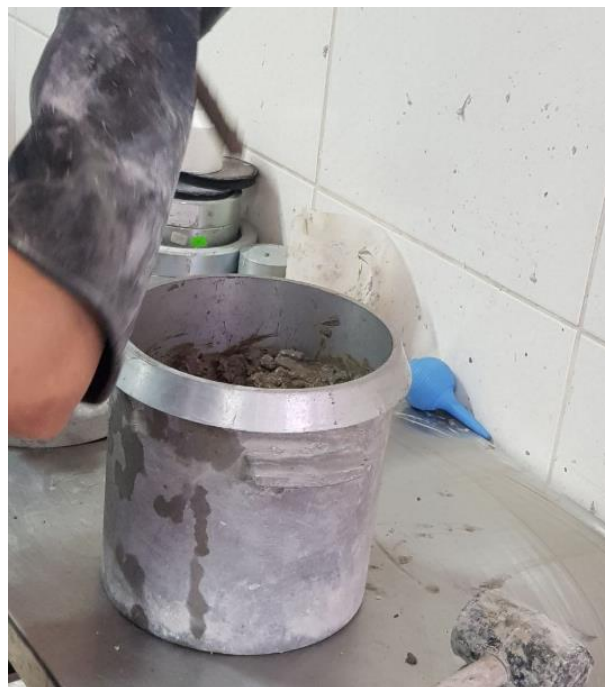
Figura 79: Se realiza el chuceado del concreto en estado fresco.
