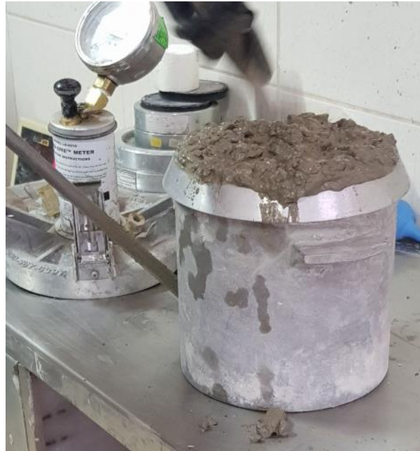
Figura 80: Se realiza la última capa del chuceado del concreto en estado fresco.
