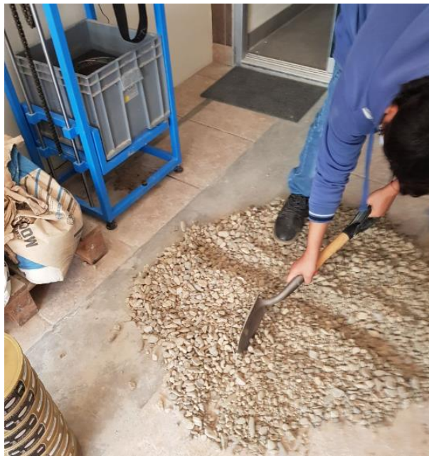
Figura 34: Nuevamente hacer el cuarteo para el análisis granulométrico del agregado grueso.
