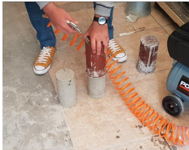
Figura 93: Se realiza el desencofrado de las probetas de tracción.
