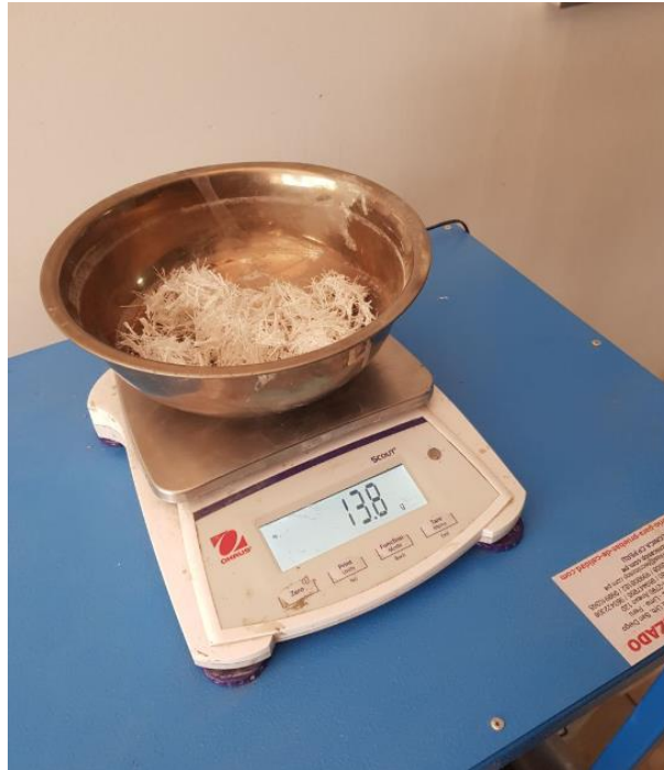
Figura 64: Obteniendo el peso de la fibra de vidrio requerido para el diseño de mezcla.
