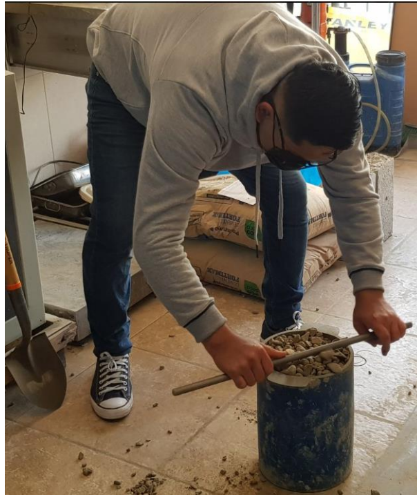
Figura 22: El enrasado del agregado grueso.
