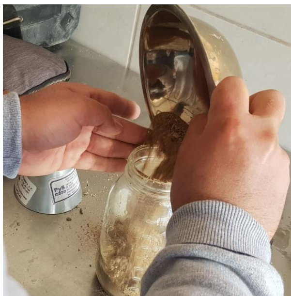
Figura 55: Llenar el pignómetro con la muestra del agregado fino.
