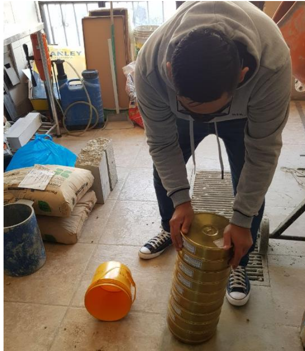
Figura 36: Realizando los movimientos para el análisis granulométrico del agregado grueso.
