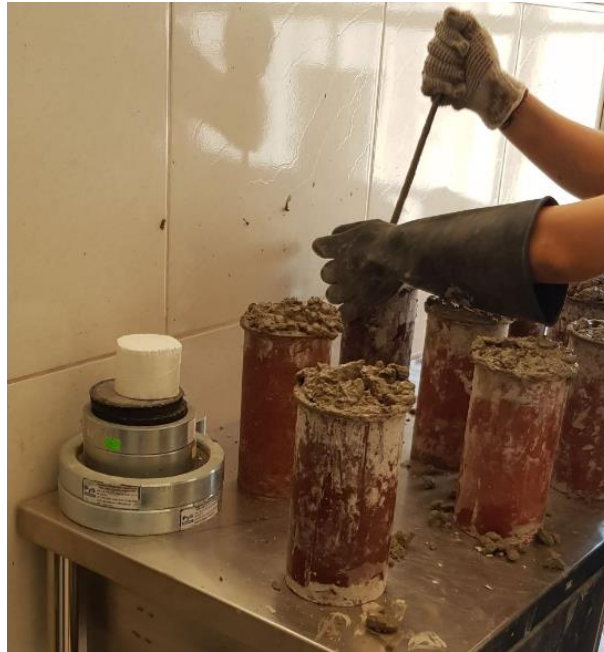
Figura 88: Se realiza la última capa del chuceado para las probetas de concreto cilíndricas.
