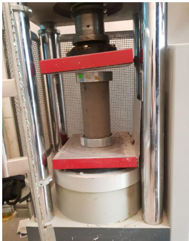
Figura 103: Se realiza el ensayo de resistencia a la compresión.
