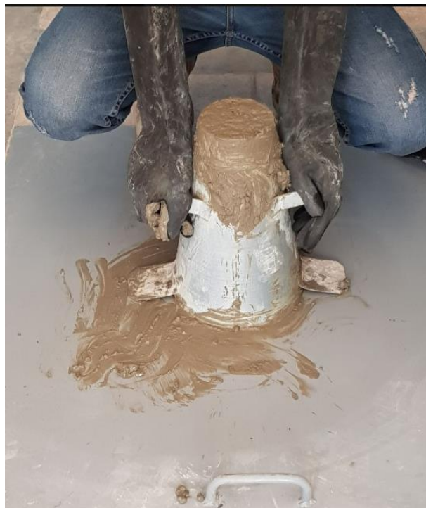
Figura 73: Una vez realizado el respectivo chuceado, se hace presión hacia abajo y luego se retira el cono.
