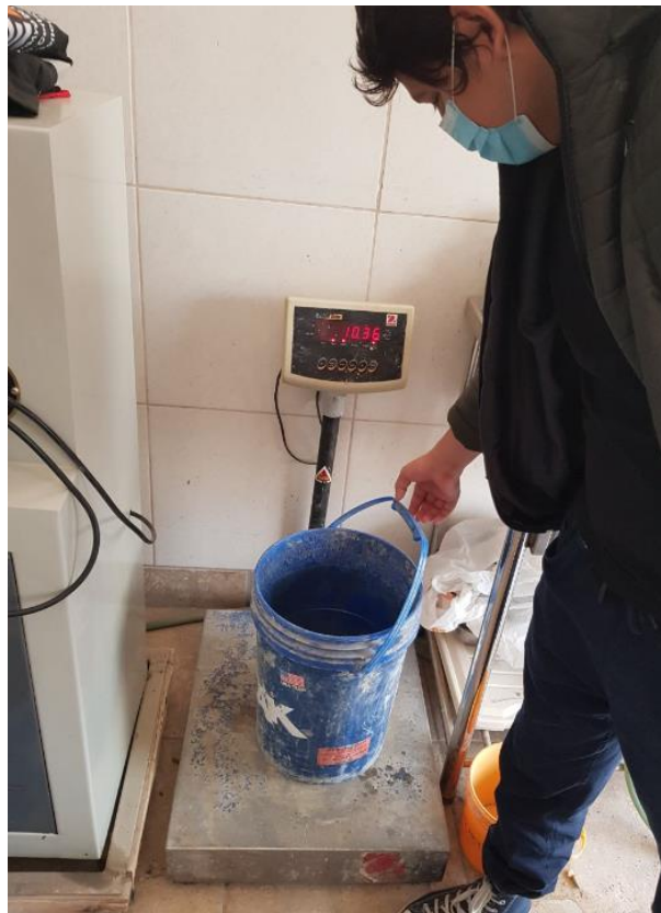
Figura 65: Obteniendo la cantidad agua requerida para el diseño de mezcla.
