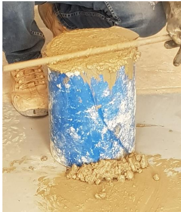
Figura 75: Una vez terminado el chuceado del concreto, se lleva acabo el enresado.
