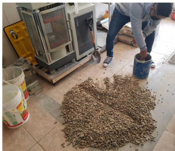
Figura 17: Colocación del agregado grueso al recipiente para el siguiente ensayo.
