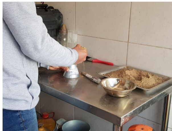
Figura 47: Colocando la muestra del agregado fino al cono para elaborar el ensayo.
