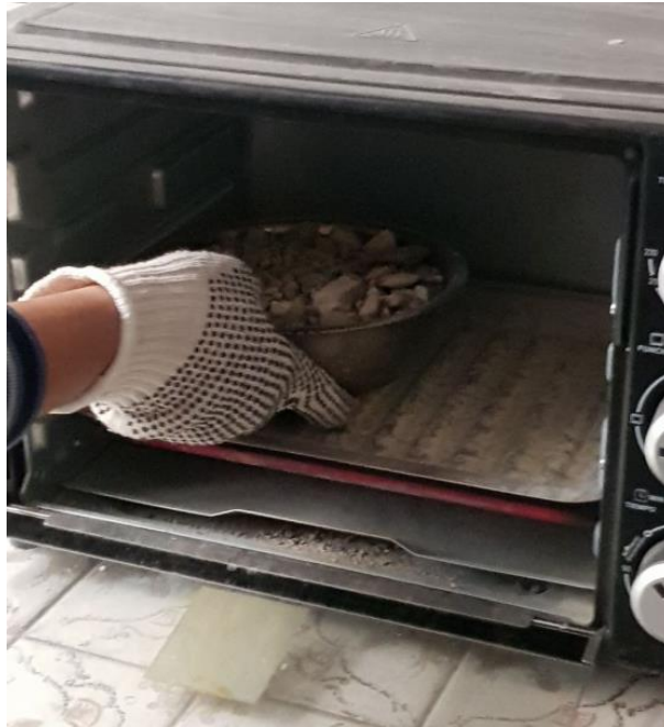
Figura 30: Colocando la muestra del agregado grueso al horno.
