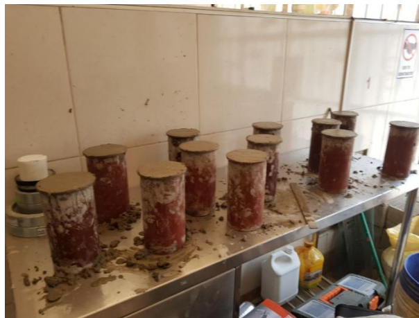
Figura 89: Se realiza el enrasado para las probetas de concreto cilíndricas.
