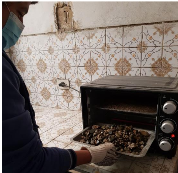
Figura 46: La muestra del agregado grueso en el horno durante las 24 horas.
