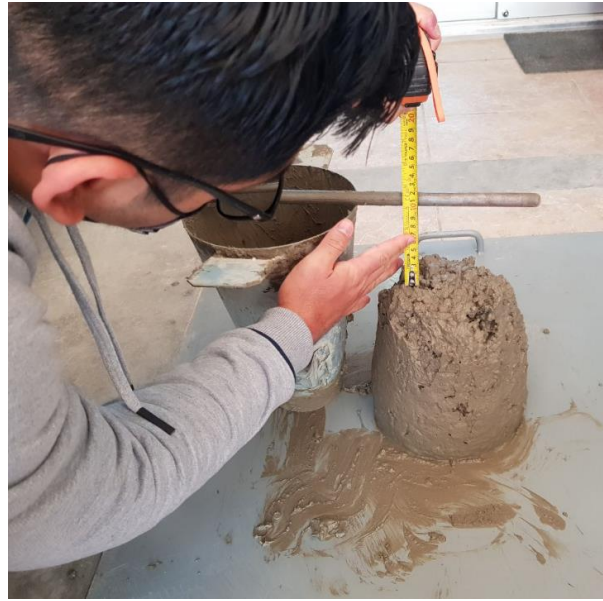
Figura 74: Se determina el asentamiento del concreto (Slump).
