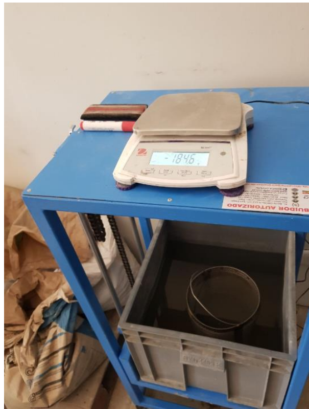
Figura 40: Determinando el peso sumergido del agregado fino.
