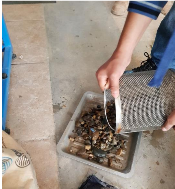
Figura 44: Preparando la muestra para determinar el peso del agregado grueso superficialmente seco.
