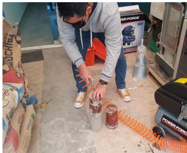
Figura 91: Se realiza el desencofrado de las probetas a presión de aire.
