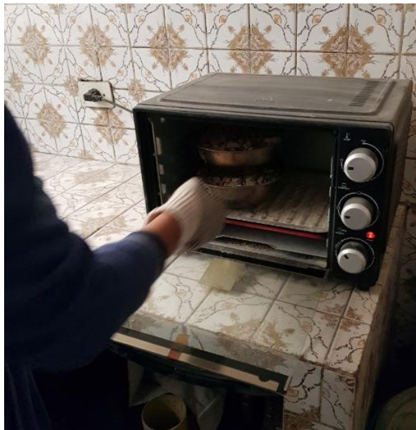
Figura 31: La muestra del agregado grueso al horno durante 24 horas.
