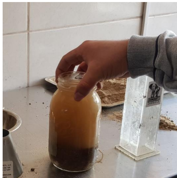
Figura 57: Llenar el pignómetro con la muestra del agregado fino más el agua, hasta la superficie superior.
