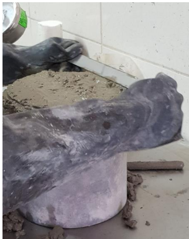
Figura 81: Se realiza enrasado del concreto en estado fresco.
