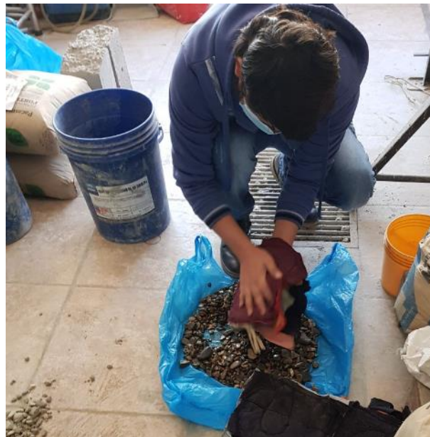
Figura 45: Secando superficialmente seco la muestra para determinar el peso del agregado grueso superficialmente seco.
