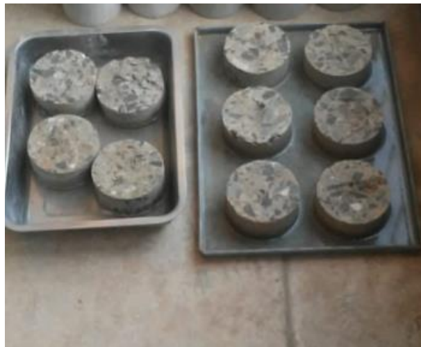
Figura 111: Se realiza el ensayo de succión capilar.
