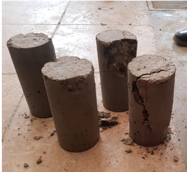
Figura 106: Se observa la rotura de la probeta, ensayo de la resistencia a la compresión.
