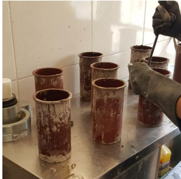
Figura 86: Se realiza la primera capa del chuceado para las probetas de concreto cilíndricas.
