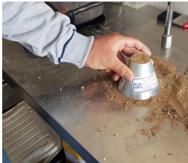
Figura 50: Haciendo el enrasado del apisonado del agregado fino.
