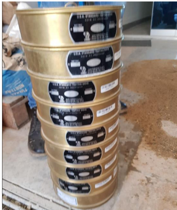
Figura 37: Seleccionando los tamices estándares para hacer el análisis granulométrico del agregado fino.
