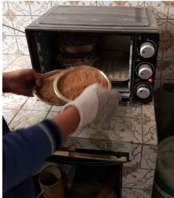
Figura 32: La muestra del agregado fino al horno durante 24 horas.
