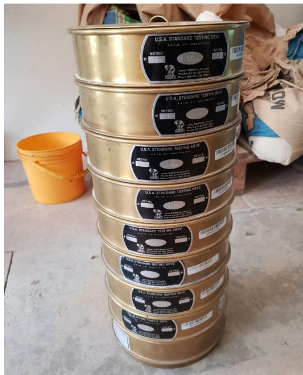
Figura 33: Seleccionando los tamices estándares para hacer el análisis granulométrico del agregado grueso.
