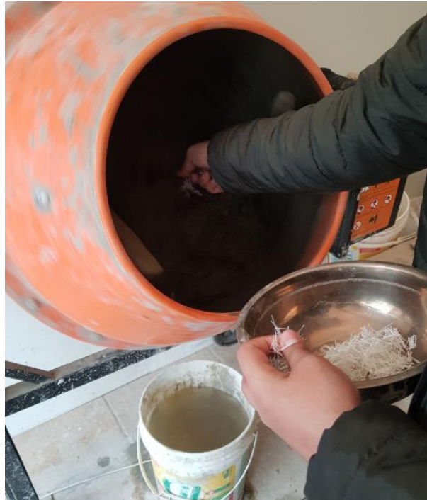
Figura 70: Se coloca la fibra de vidrio al trompo para el respectivo ensayo del mezclado.
