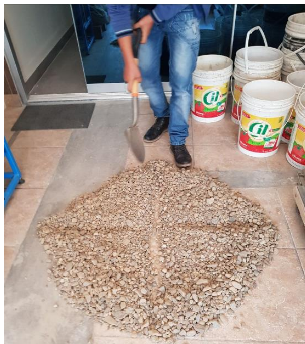
Figura 15: El cuarteo del agregado grueso.
