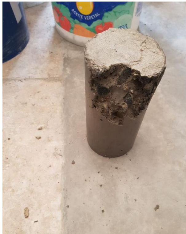
Figura 105: Se observa la rotura de la probeta, ensayo de la resistencia a la compresión.
