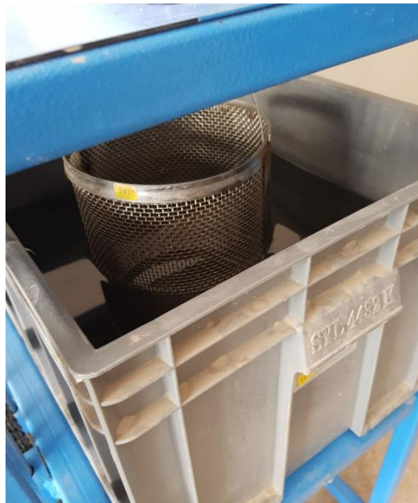
Figura 42: Sumergiendo la muestra del agregado grueso.
