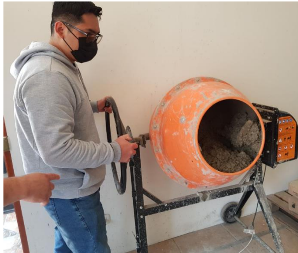
Figura 72: Se prepara para el vaciado del concreto a la plancha, con la finalidad de realizar el ensayo del asentamiento del concreto.
