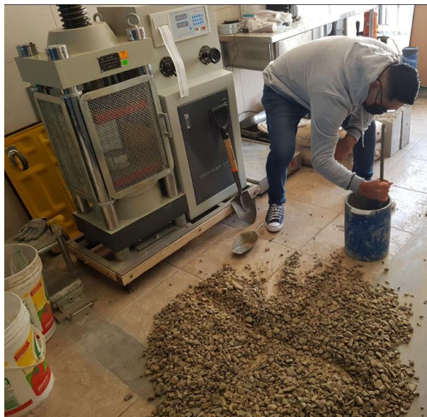
Figura 19: El primer chuceado del agregado grueso.
