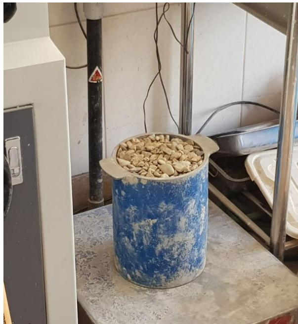
Figura 23: Determinando el peso compactado del agregado grueso.
