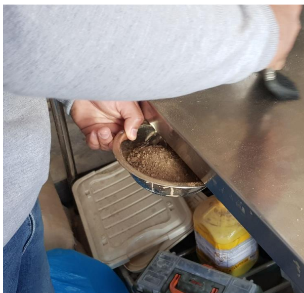
Figura 54: Tomada la muestra, se realiza el siguiente ensayo para determinar la absorción del agregado fino.
