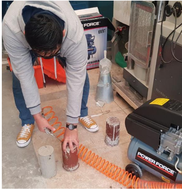
Figura 92: Se realiza el desencofrado de las probetas de compresión.
