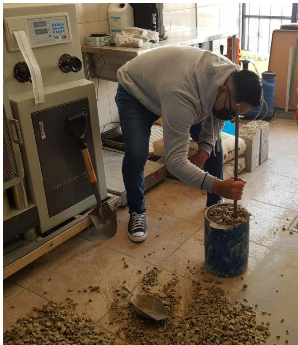
Figura 21: El último chuceado del agregado grueso.
