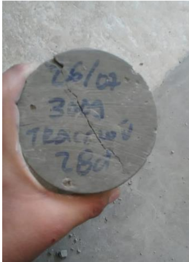
Figura 110: Se observa la rotura de la probeta, ensayo de la resistencia a la tracción.
