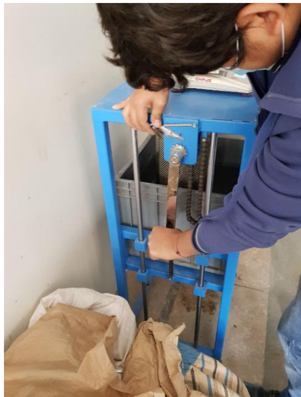
Figura 43: Sacando del agua la muestra del agregado grueso.
