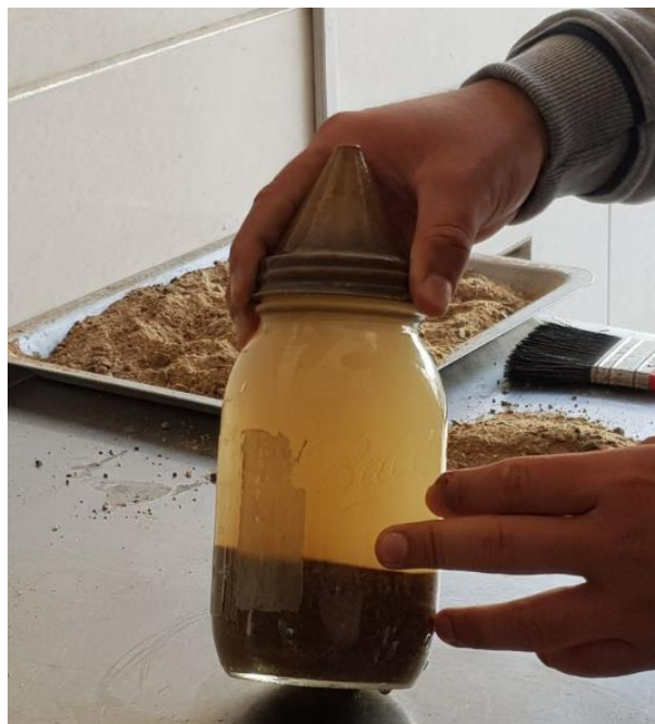
Figura 59: Luego, dejar reposar por 24 horas para culminar el ensayo y recolectar los datos.
