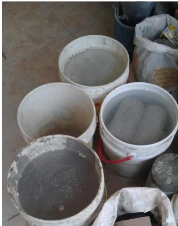
Figura 98: Se realiza el respectivo curado para las probetas de concreto cilíndricas.
