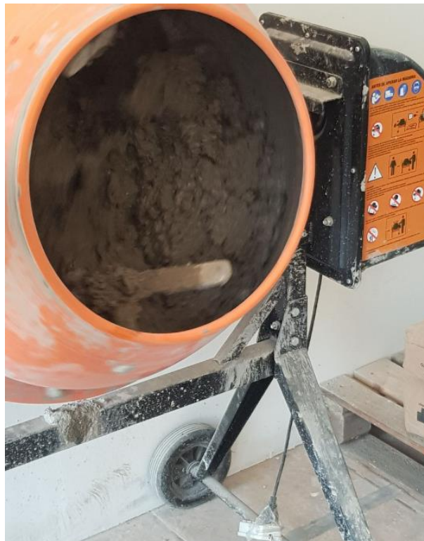
Figura 71: Se observa el mezclado de los materiales, incluido con la fibra de vidrio.
