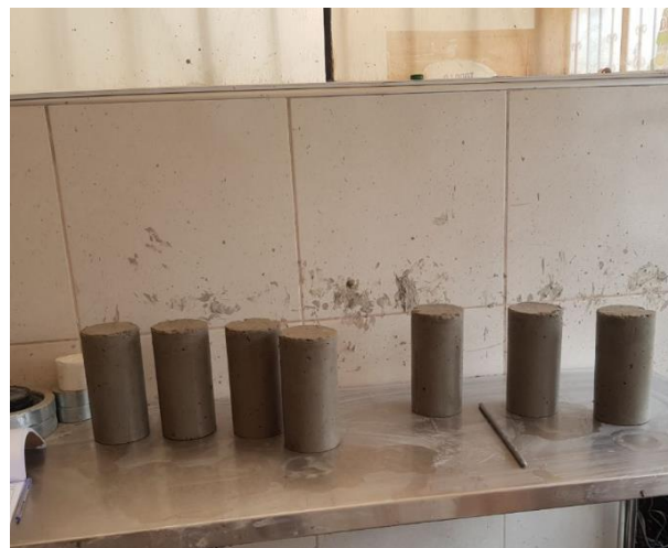
Figura 99: Se realiza el retirado de las probetas de los baldes para realizar el siguiente ensayo.
