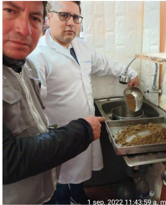
Foto 1. Agregando la muestra para lavado. Ensayo de granulometría
