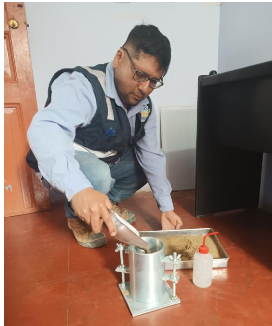
Foto 10. Ensayo de Proctor
