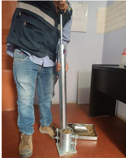
Foto 11. Ensayo de Proctor. Compactación de muestra
