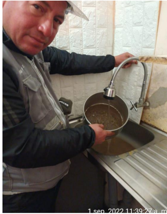
Foto 3. Ensayo de lavado de la muestra
