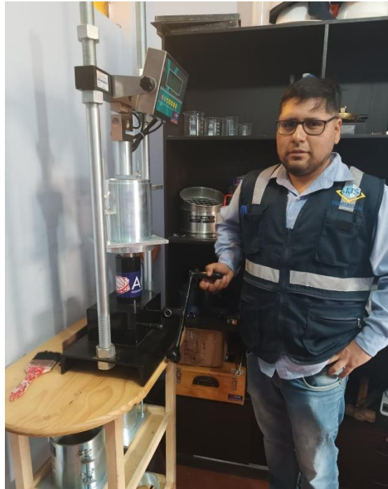
Foto 15. Ensayo de CBR. Ensayo de penetración
