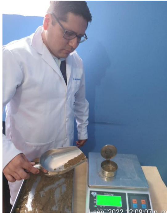
Foto 7. Ensayo de contenido de humedad de la muestra
