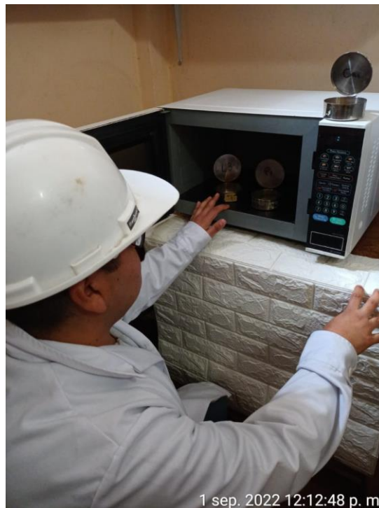
Foto 8. Secado de las muestras del contenido de humedad
