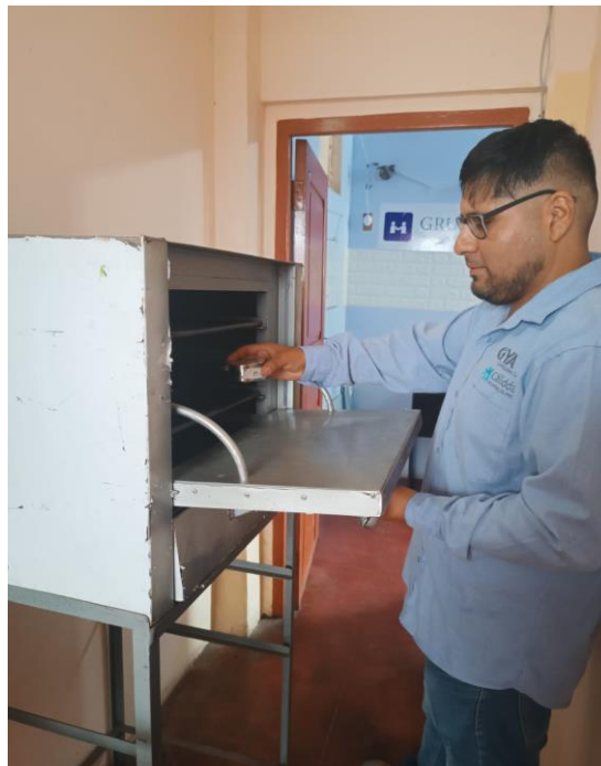
Foto 12. Ensayo de Proctor. Determinación de Humedad
