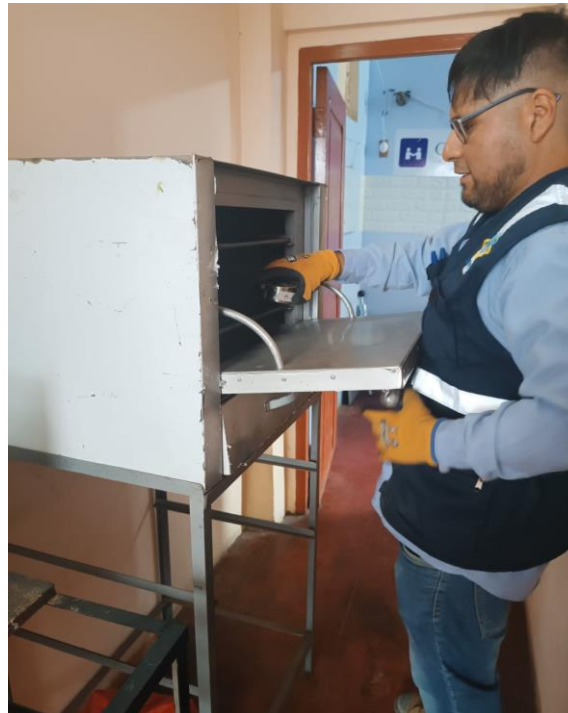
Foto 14. Ensayo de CBR. Determinación de humedad
