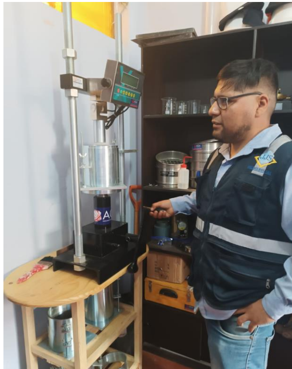
Foto 16. Ensayo de CBR. Ensayo de penetración
