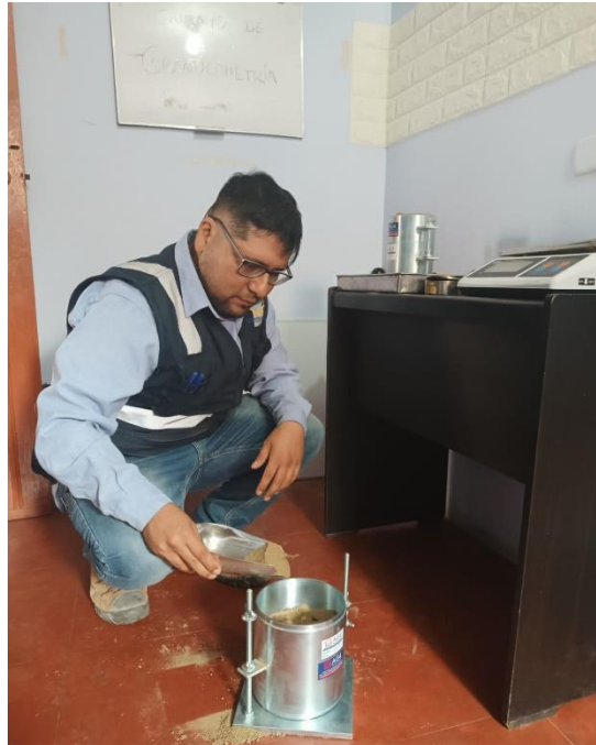
Foto 13. Ensayo de CBR. Compactación de muestra
