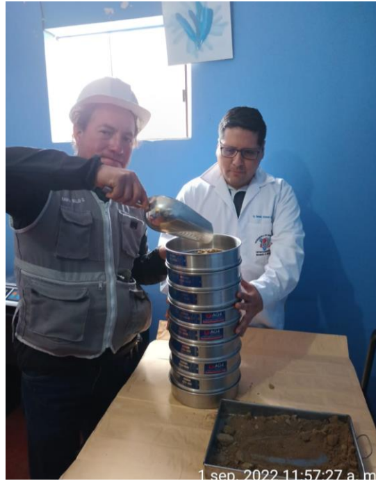
Foto 5. Ensayo granulometría de la muestra
