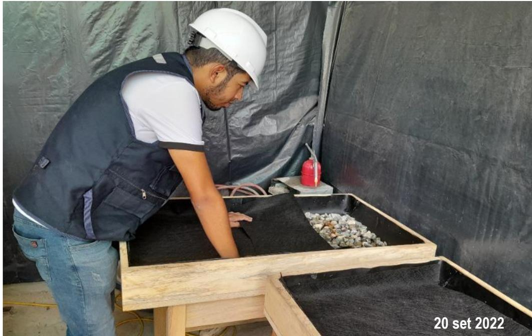
Figura 6. Se muestra la colocación de geotextil no tejido de 200gr para protección de la capa de drenaje para los prototipos V01 y V02.
