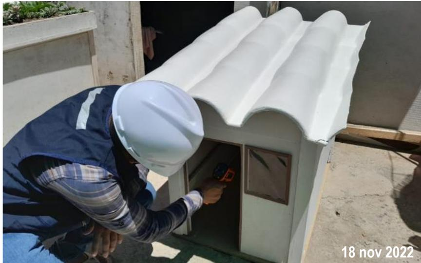
Toma de temperatura interior del prototipo techo frío F02 (Teja andina) con el instrumento de medición (pirómetro).
