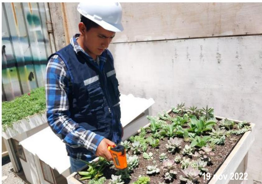
Toma de temperatura superficial del prototipo techo verde V01 (plantas suculentas) con el instrumento de medición (pirómetro).
