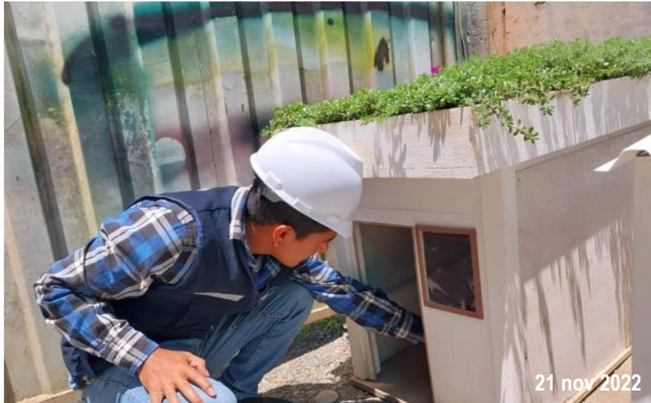
Toma de temperatura ambiente interior del prototipo techo verde V02 (plantas rastreras- cuna de niño) con el instrumento de medición (pirómetro).
