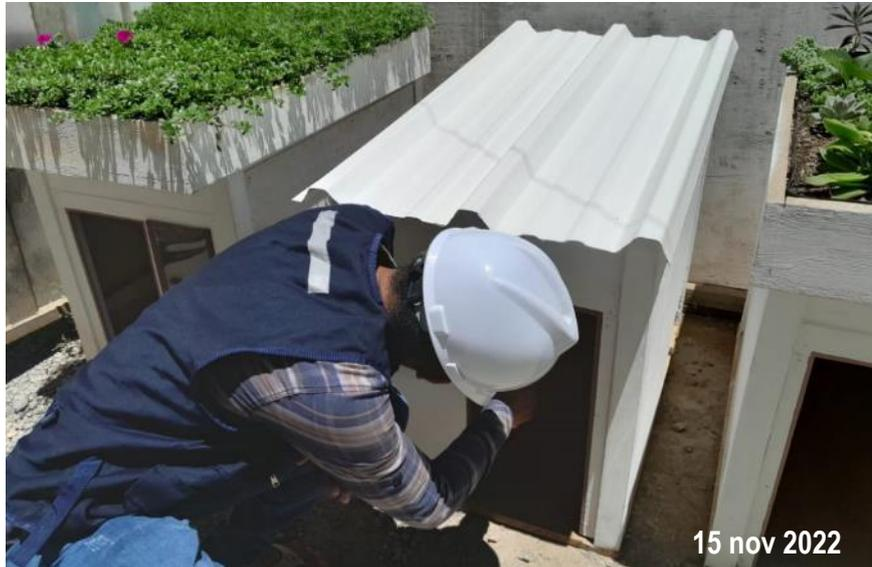
Toma de temperatura interior del prototipo techo frío F01 (panel termoacústico TK5) con el instrumento de medición (pirómetro).
