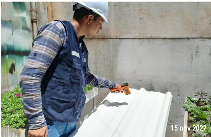
Toma de temperatura superficial del prototipo techo frío F01 (panel termoacústico) con el instrumento de medición (pirómetro).
