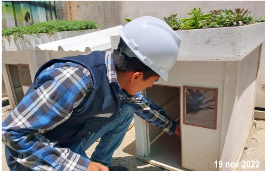
Toma de temperatura interior del prototipo techo verde V01 (plantas suculentas) con el instrumento de medición (pirómetro)
