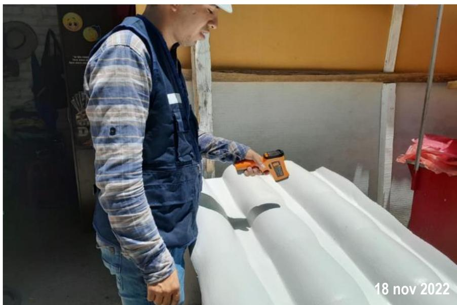
Toma de temperatura superficial del prototipo techo frío F02 (Teja andina) con el instrumento de medición (pirómetro).
