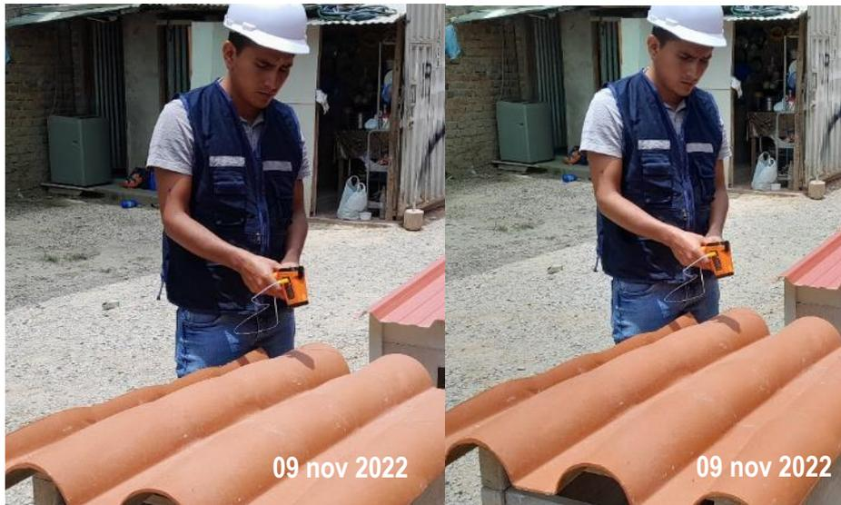
Registro de temperatura superficial del prototipo patrón Teja andina con el instrumento de medición temperaturas (pirómetro).
