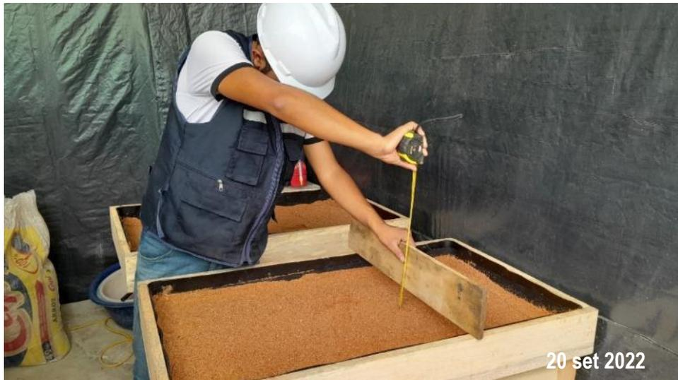
*Figura 7.* Colocación de aserrín sobre la capa de geotextil con espesor de 1.00 cm, que forma parte de la capa del sustrato para los prototipos V01 y V02.
