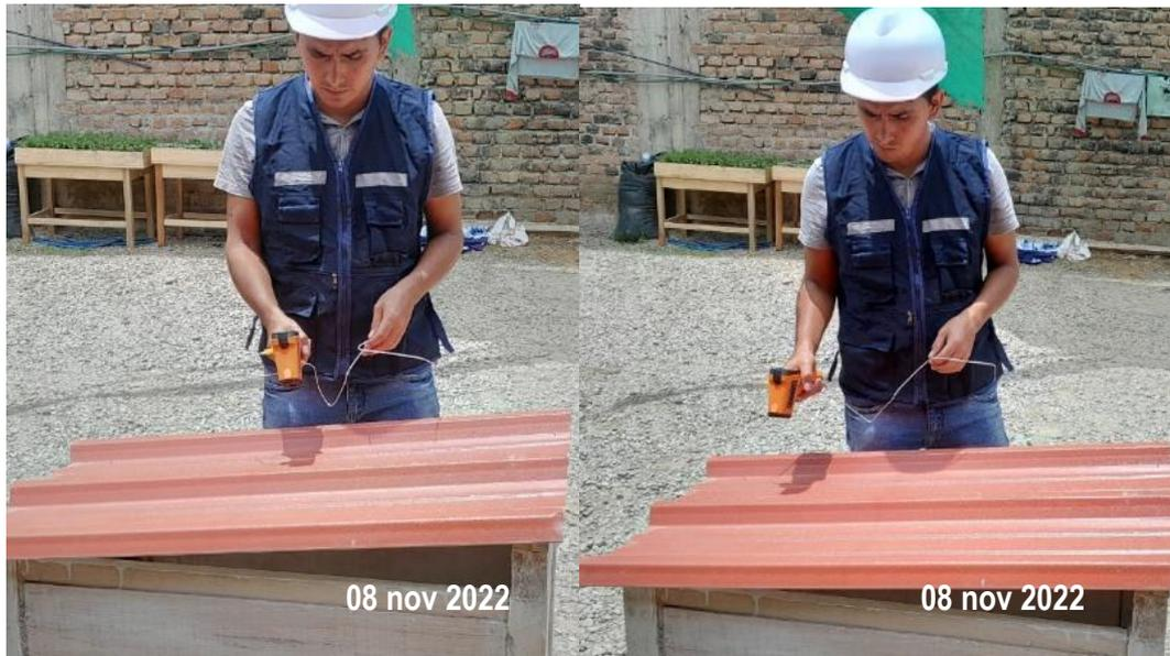
Registro de temperatura superficial del prototipo patrón panel termoacústico TK5 con el instrumento de medición temperaturas (pirómetro).
