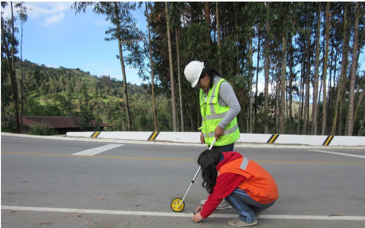
Figura 24 Ubicación de la progresiva con odómetro para medir el bombeo con eclímetro.
