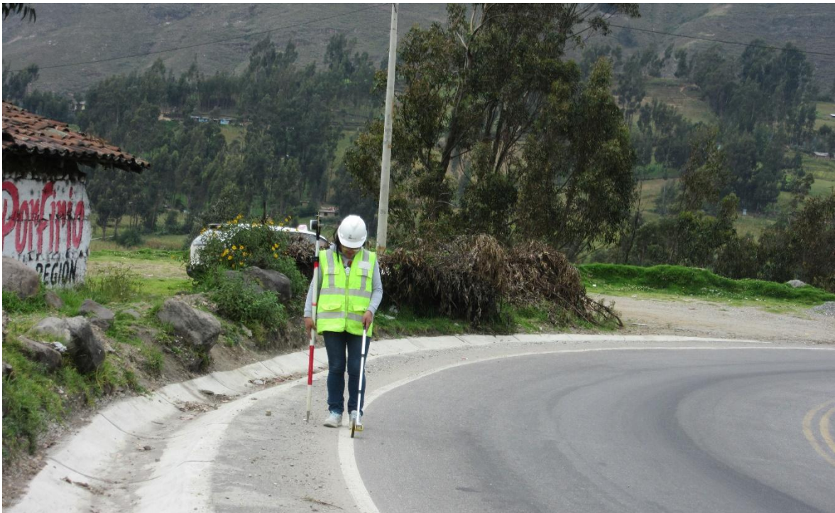
Figura 24 Ubicación de la progresiva con odómetro para medir el bombeo con eclímetro.
