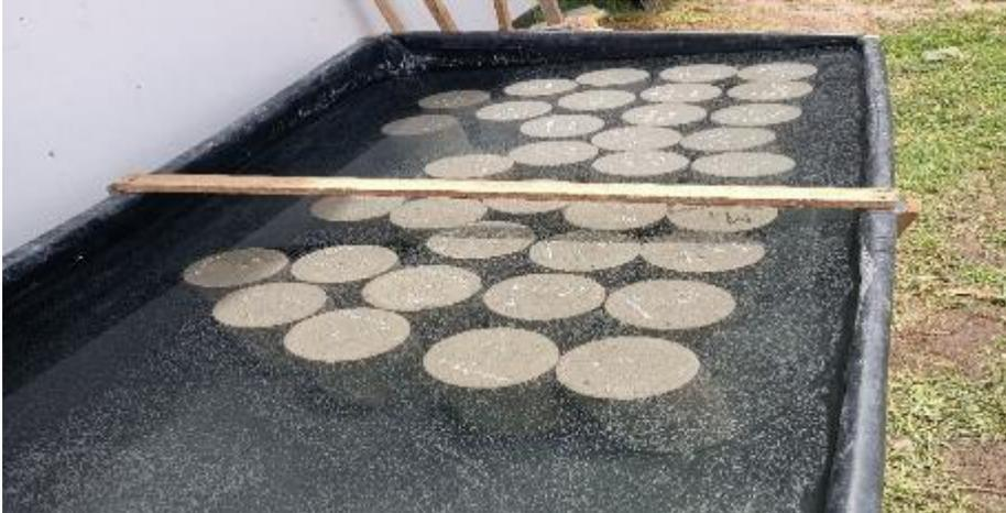
En la figura 13 se evidencia las probetas cilíndricas en estado de curación después de haber sido desencofrado.
