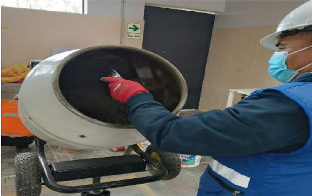
Fotografía N° 4: Mezcla lista para encofrar probetas cilíndricas.
