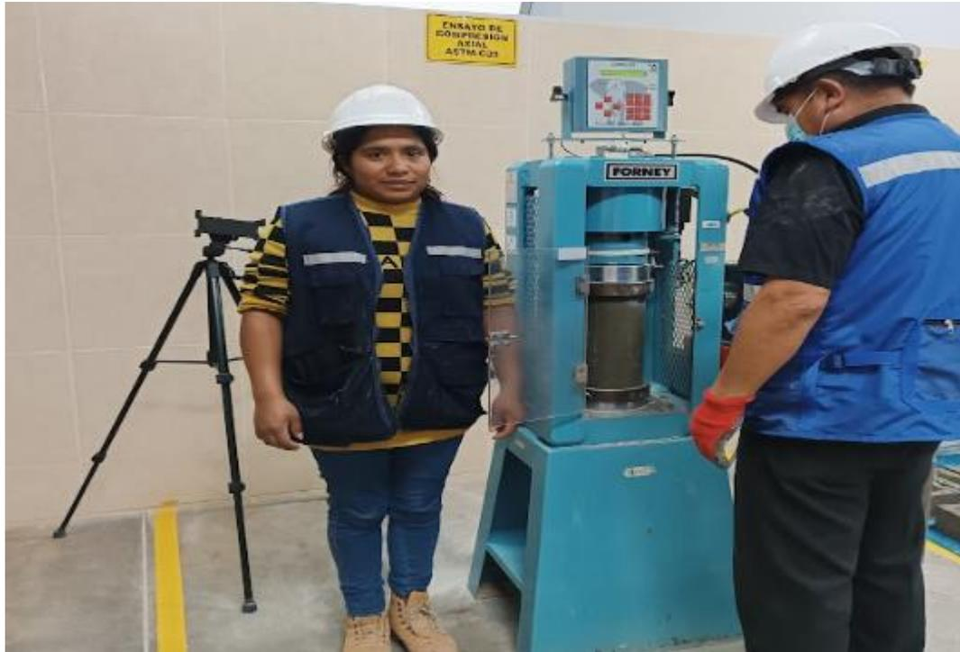
Fotografía N° 8: Ensayo a compresión axial a los 28 días.
