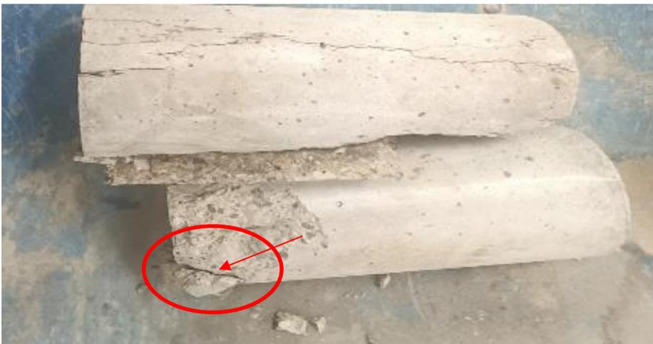
En la figura 16 se muestra una probeta donde se puede identificar que la fibra de yute no está tensada.
