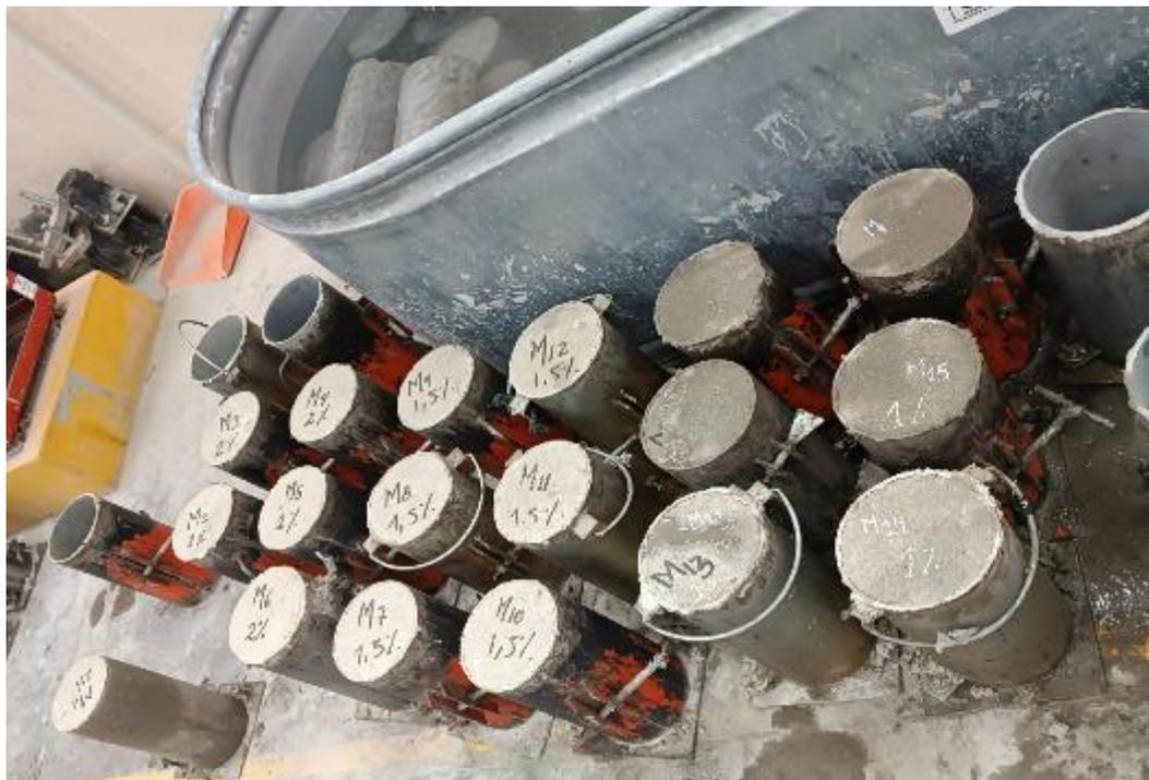
Fotografía N° 7: Ensayo a compresión axial a los 7 días.
