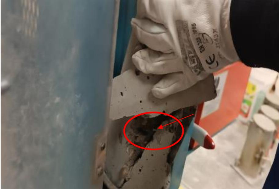
En la figura 15 se muestra la ruptura de una probeta donde se puede identificar que la fibra de yute no está tensada.
